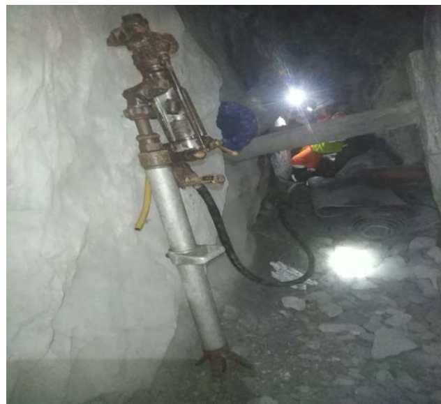
Figura 17: Máquina perforadora Jack Leg YT - 29A
