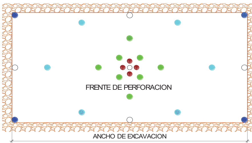
Fuente: López Jimeno (2003), Manual de perforación y voladura de rocas. Figura N° 11. Método de construcción en sección completa de un pique.
