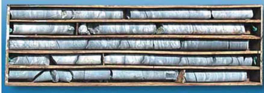
Fuente: Manual de Geomecánica, conociendo a la roca. Figura N° 01. Testigos de perforación diamantina.
