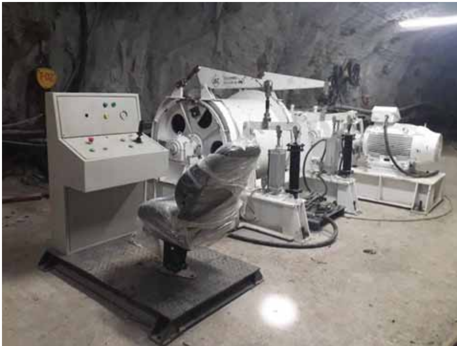
Fuente: JSC equipos mineros. Figura N° 15. Winche de izaje con una sola tambora.
