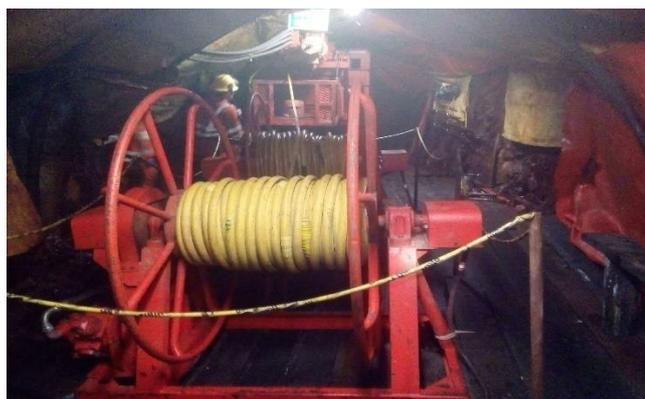
Figura 10: equipo alimak con bobina enrollado del cable alimentador
