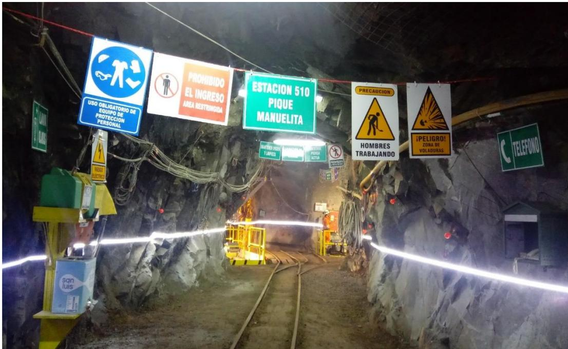
Figura 59: estandarización con señales de seguridad y luces led en labor de ingreso al pique nivel 510
