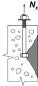
Fig. 3. 10: Desprendimiento lateral del concreto
