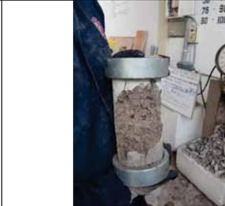
Probeta de concreto con 20% VM luego del ensayo
