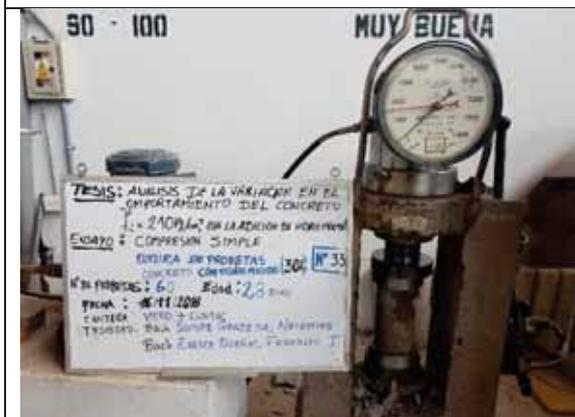
Probeta N° 33. Concreto con 30% de VM a los 28 días
