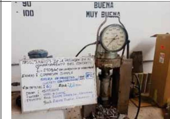
Probeta N° 02. Concreto con 20% de VM a los 28 días
