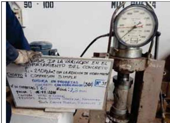
Probeta N° 31. Concreto con 30% de VM a los 28 días
