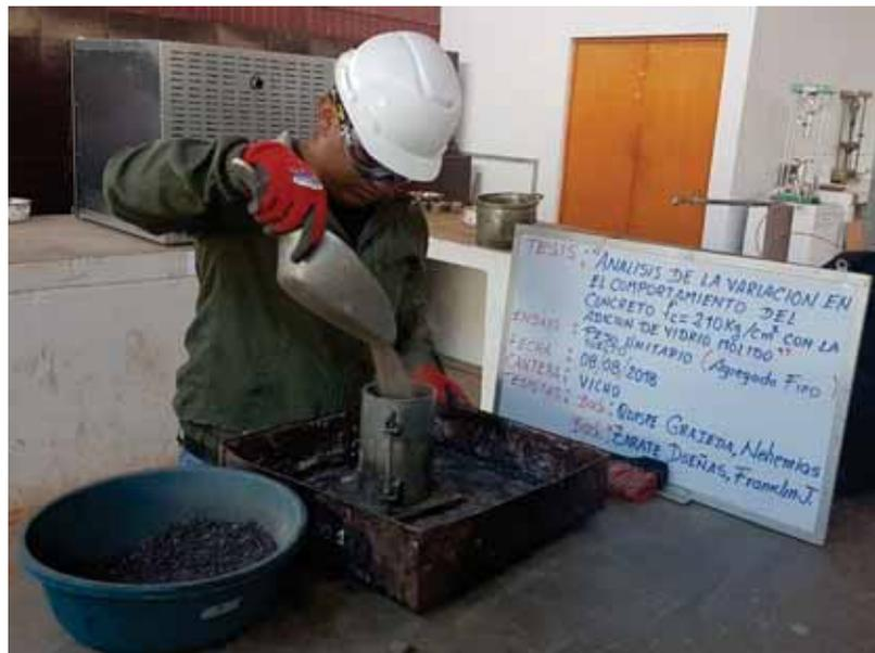
*Figura 26.* Llenado del Próctor modificado con agregado fino
