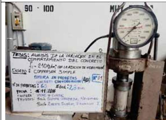
Probeta N° 01. Concreto con 40% de VM a los 28 días
