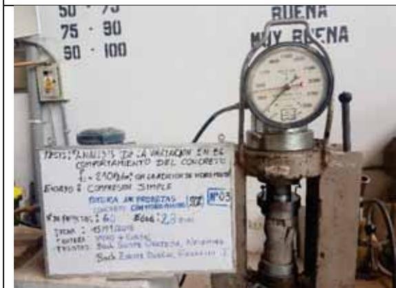
Probeta N° 03. Concreto con 20% de VM a los 28 días
