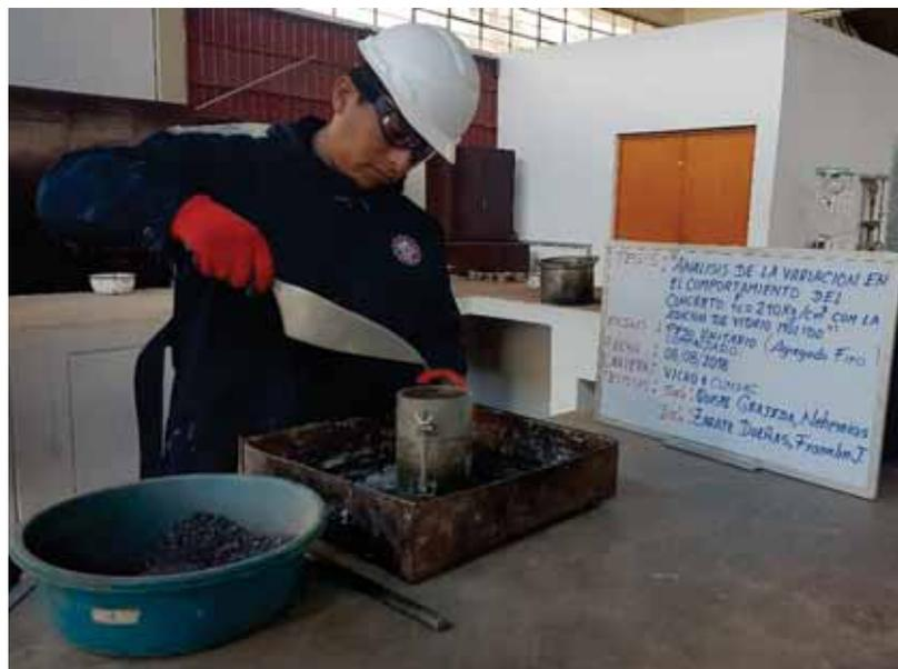
**Figura 30.** Llenado y apisonado del agregado fino en el próctor modificado
