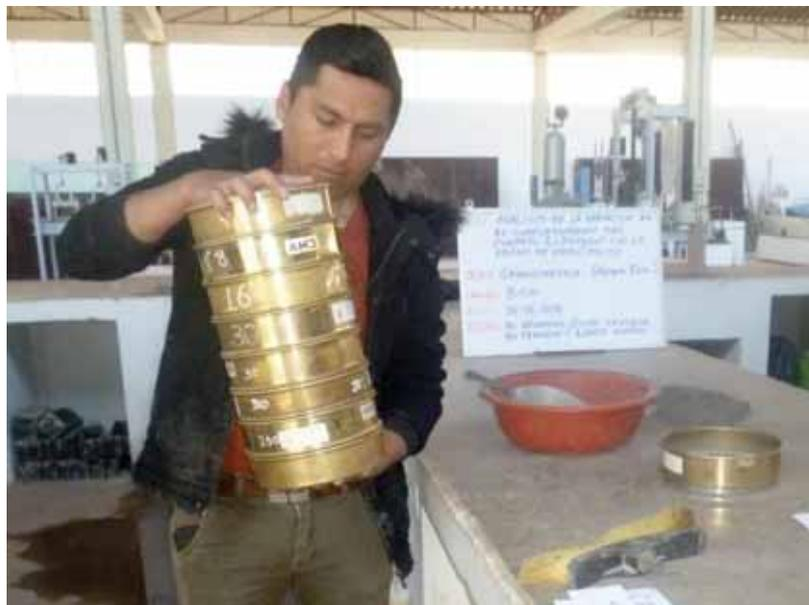
**Figura 18.** Tamizado manual del agregado fino
