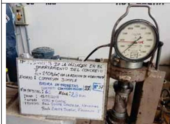
Probeta N° 37. Concreto con 20% de VM a los 28 días
