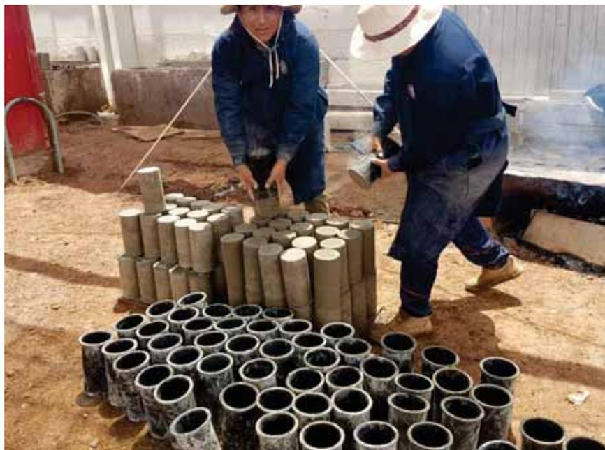
*Figura 41.* Desmolde de las briquetas del concreto
