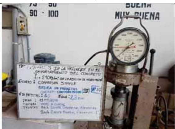
Probeta N° 30. Concreto con 20% de VM a los 28 días
