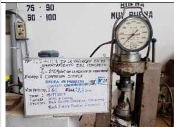
Probeta N° 21. Concreto con 20% de VM a los 28 días
