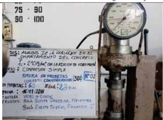
Probeta N° 02. Concreto con 30% de VM a los 28 días
