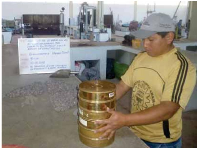
**Figura 15.** Tamizado manual del agregado grueso
