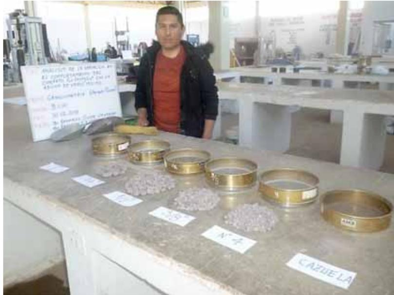
*Figura 16.* Granulometría del agregado grueso de Vicho.
