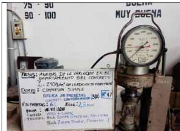
Probeta N° 47. Concreto con 30% de VM a los 28 días
