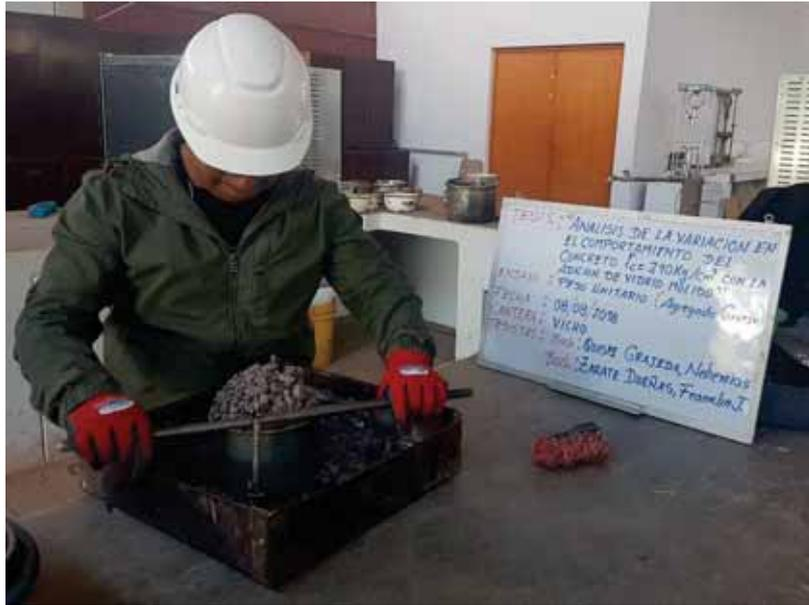
*Figura 27.* Enrasado del agregado grueso
