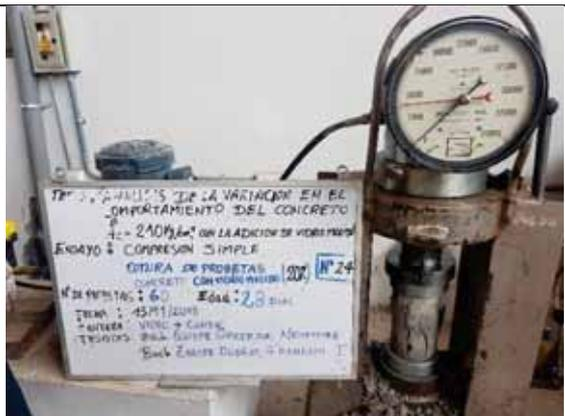
Probeta N° 24. Concreto con 20% de VM a los 28 días
