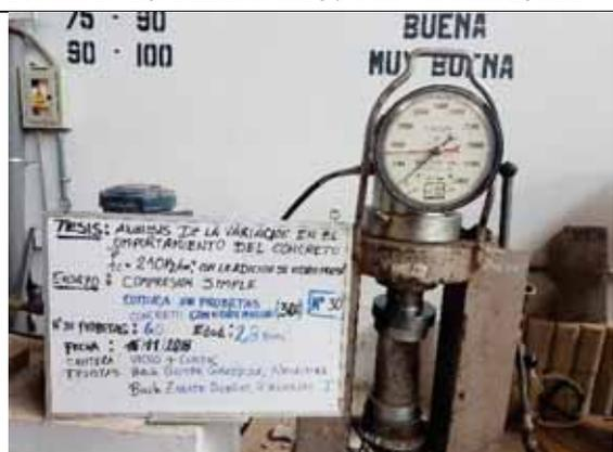
Probeta N° 30. Concreto con 30% de VM a los 28 días
