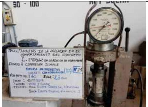
Probeta N° 24. Concreto con 0% de VM a los 28 días
