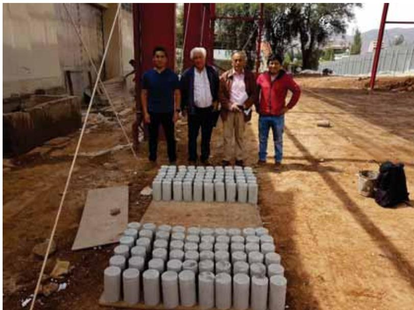
**Figura 44,** Probetas de concreto con 30% de VM y a la edad de 21 días, listas para ser llevadas al laboratorio para someterlos a compresión
