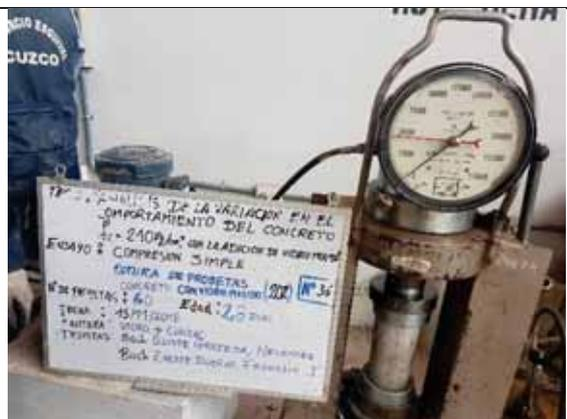
Probeta N° 36. Concreto con 20% de VM a los 28 días
