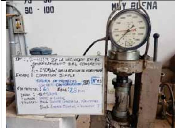
Probeta N° 15. Concreto con 20% de VM a los 28 días
