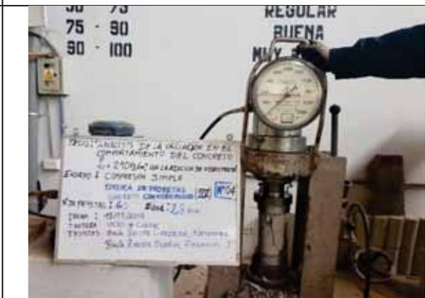
Probeta N° 04. Concreto con 20% de VM a los 28 días
