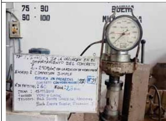
Probeta N° 59. Concreto con 20% de VM a los 28 días
