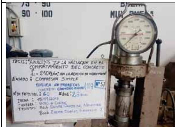
Probeta N° 57. Concreto con 0% de VM a los 28 días
