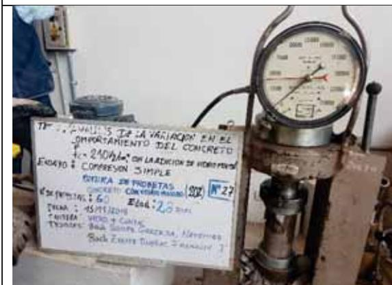
Probeta N° 27. Concreto con 20% de VM a los 28 días
