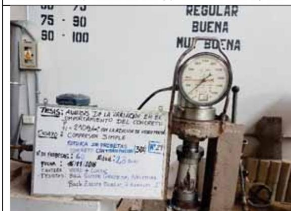
Probeta N° 29. Concreto con 30% de VM a los 28 días
