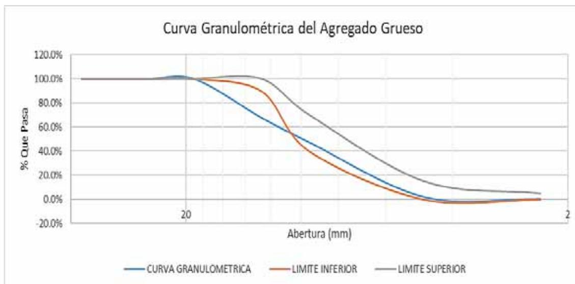
Figura 47. Curva Granulométrica del agregado grueso de Vicho
