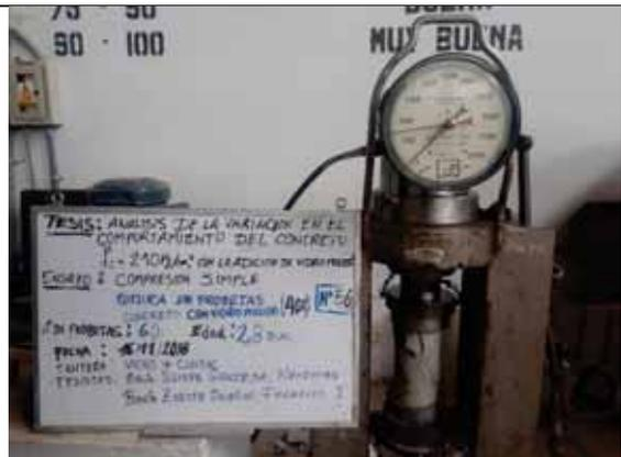
Probeta N° 56. Concreto con 40% de VM a los 28 días
