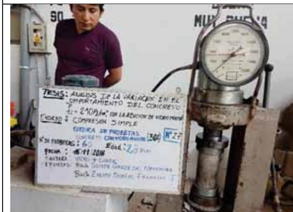
Probeta N° 27. Concreto con 30% de VM a los 28 días
