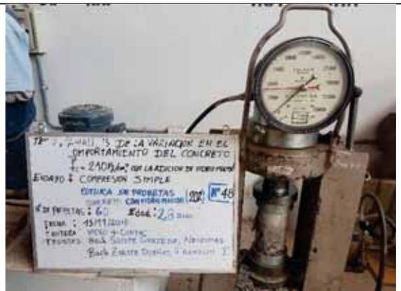
Probeta N° 48. Concreto con 20% de VM a los 28 días
