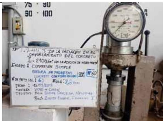
Probeta N° 60. Concreto con 20% de VM a los 28 días
