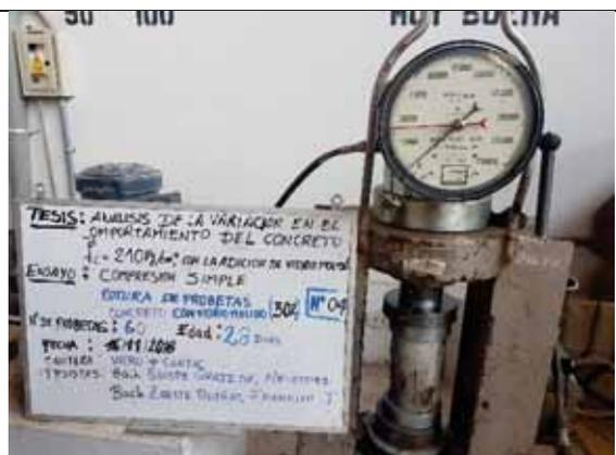
Probeta N° 04. Concreto con 30% de VM a los 28 días
