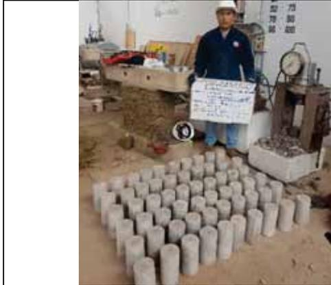
60 Probetas de concreto con 20% de VM a los 28 días
