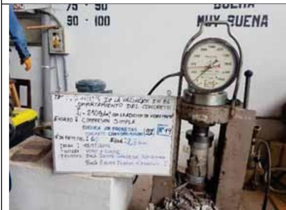
Probeta N° 19. Concreto con 20% de VM a los 28 días
