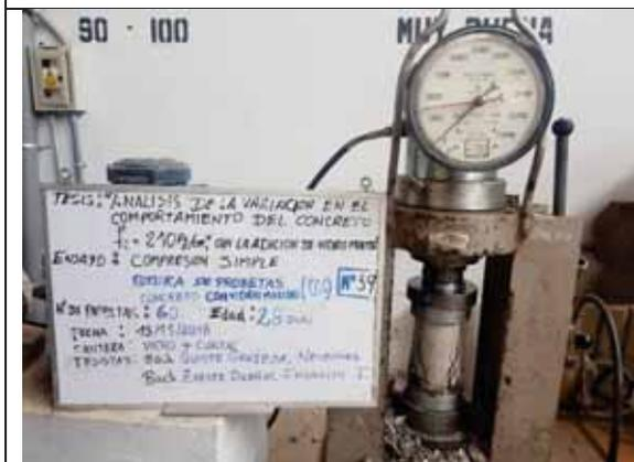
Probeta N° 59. Concreto con 0% de VM a los 28 días
