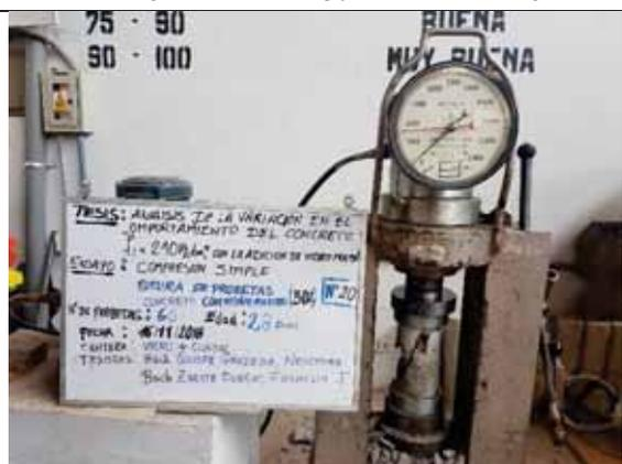
Probeta N° 20. Concreto con 30% de VM a los 28 días
