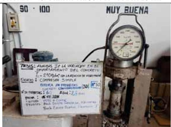
Probeta N° 50. Concreto con 30% de VM a los 28 días
