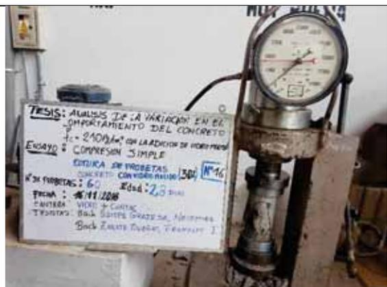
Probeta N° 16. Concreto con 30% de VM a los 28 días
