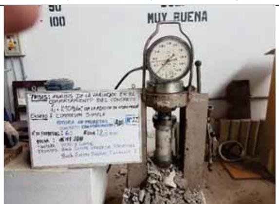
Probeta N° 22. Concreto con 40% de VM a los 28 días
