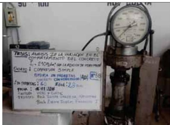
Probeta N° 58. Concreto con 40% de VM a los 28 días
