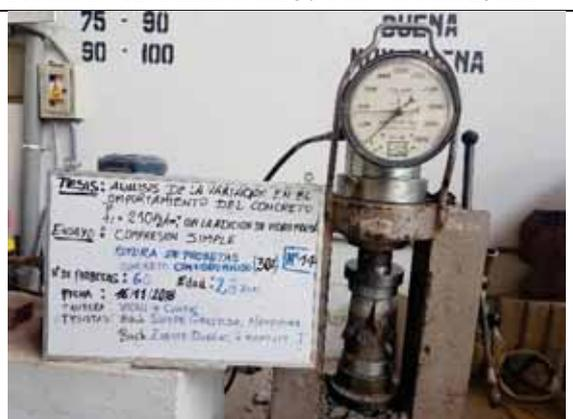
Probeta N° 14. Concreto con 30% de VM a los 28 días
