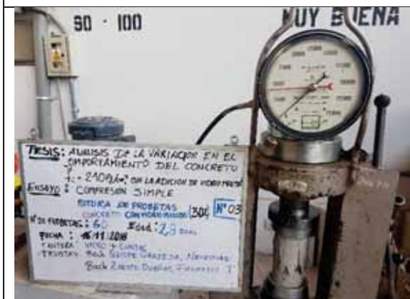
Probeta N° 03. Concreto con 30% de VM a los 28 días
