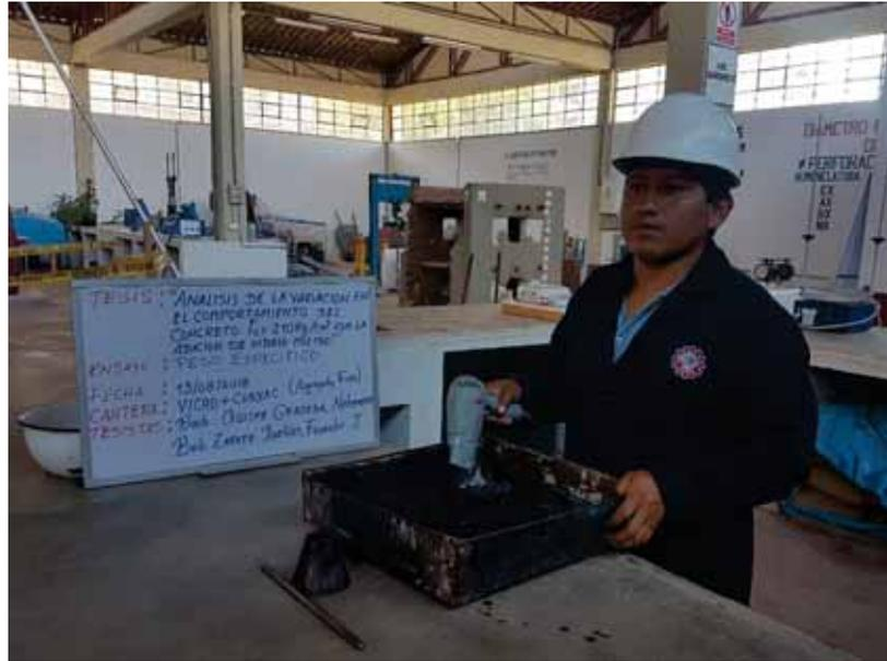
**Figura 24.** Secado de las partículas del agregado fino, con una corriente de aire tibio
