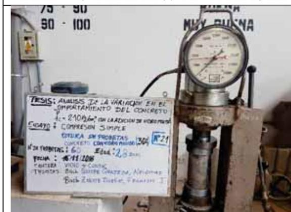
Probeta N° 21. Concreto con 30% de VM a los 28 días
