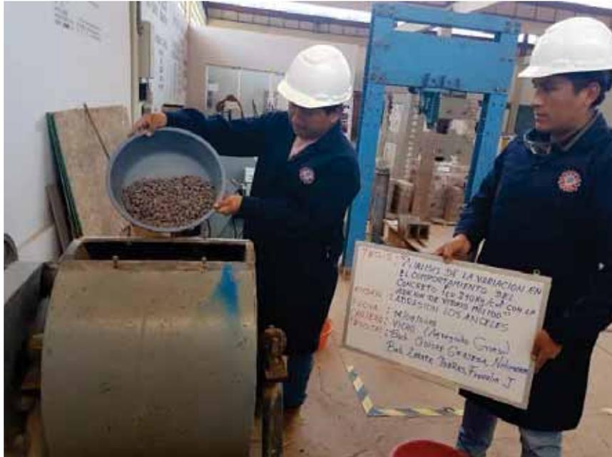
**Figura 34.** Colocado de la muestra y la carga en la máquina de Los Ángeles
