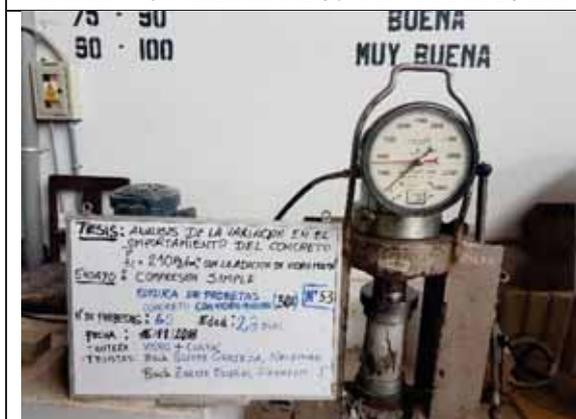
Probeta N° 53. Concreto con 30% de VM a los 28 días
