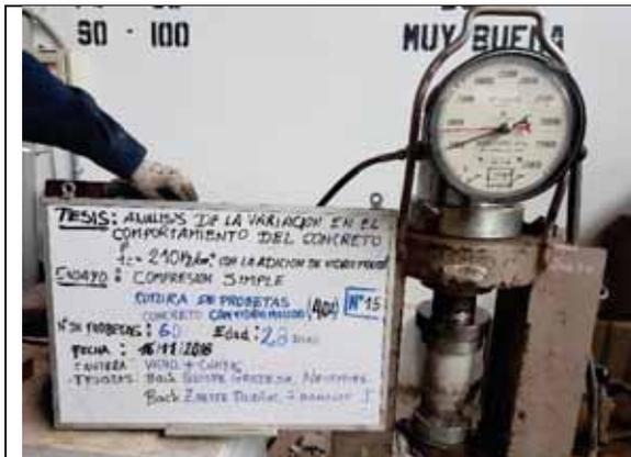
Probeta N° 15. Concreto con 40% de VM a los 28 días
