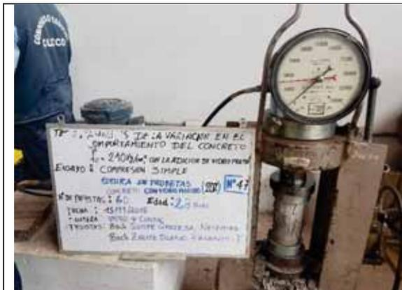
Probeta N° 47. Concreto con 20% de VM a los 28 días
