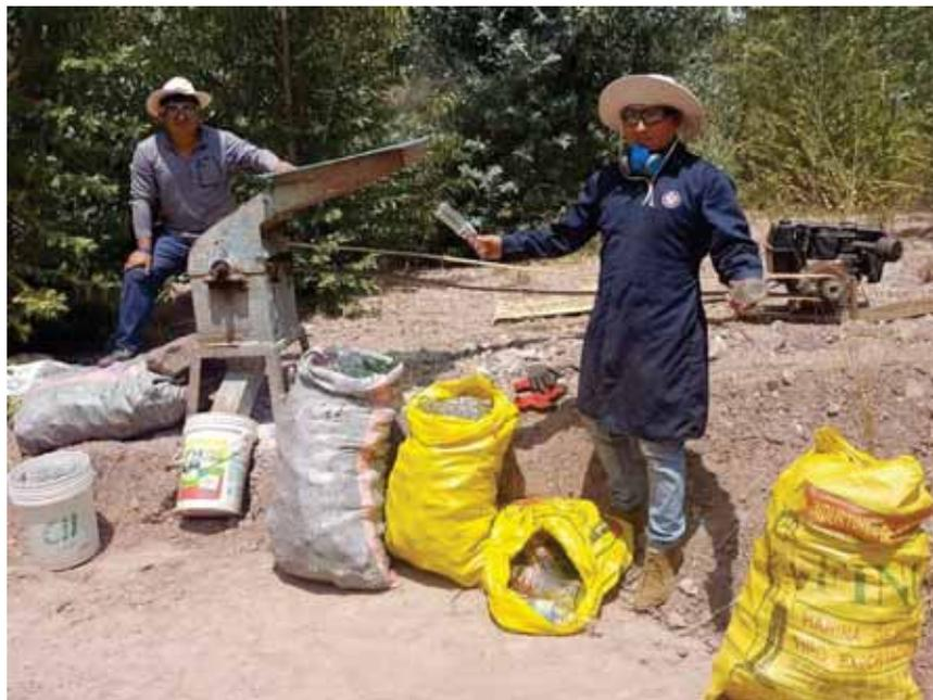
*Figura 12.* Proceso de molienda de las botellas y envases de vidrio
