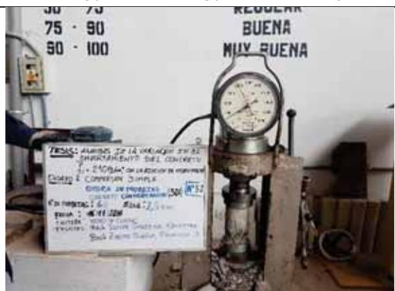
Probeta N° 52. Concreto con 30% de VM a los 28 días
