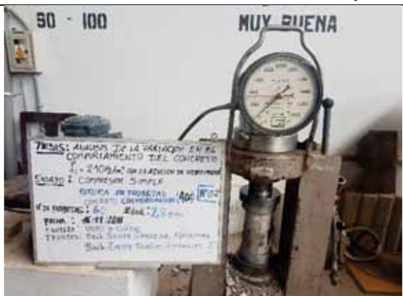
Probeta N° 02. Concreto con 40% de VM a los 28 días
