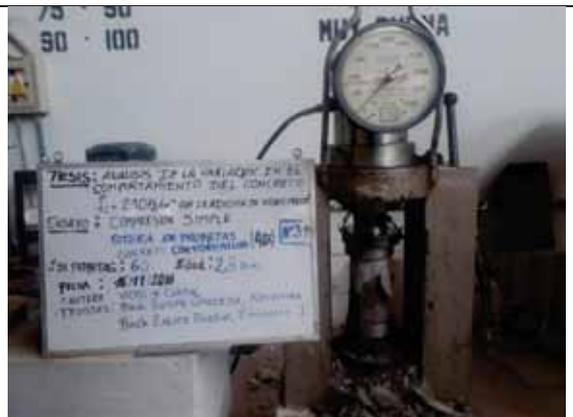
Probeta N° 34. Concreto con 40% de VM a los 28 días
