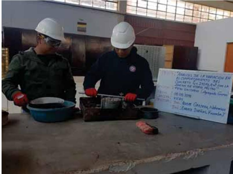
**Figura 31.** Enrasado del agregado fino corregido sobrante con la varilla de acero
