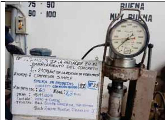
Probeta N° 23. Concreto con 20% de VM a los 28 días
