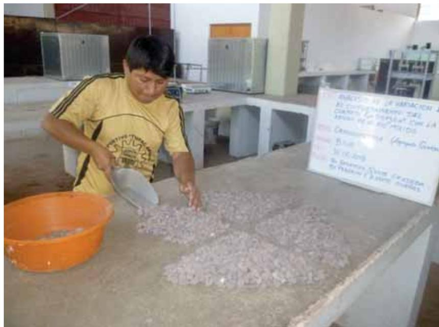
*Figura 14.* Selección de la muestra representativa del agregado grueso por el método del cuarteo
