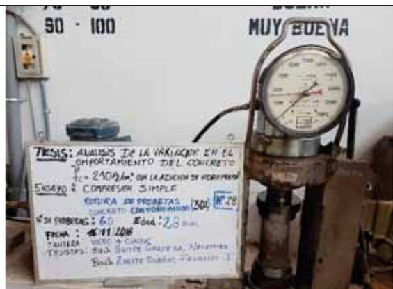
Probeta N° 28. Concreto con 30% de VM a los 28 días
