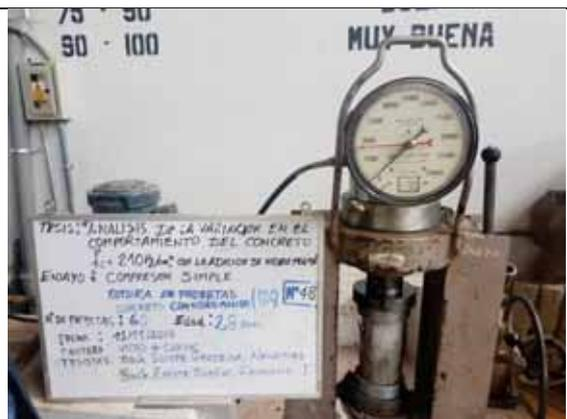
Probeta N° 48. Concreto con 0% de VM a los 28 días
