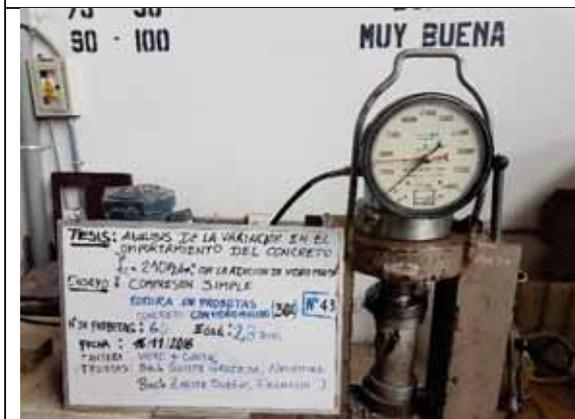
Probeta N° 43. Concreto con 30% de VM a los 28 días
