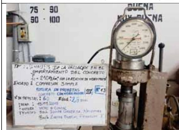
Probeta N° 13. Concreto con 20% de VM a los 28 días
