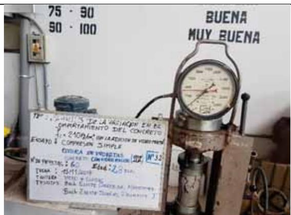
Probeta N° 32. Concreto con 20% de VM a los 28 días
