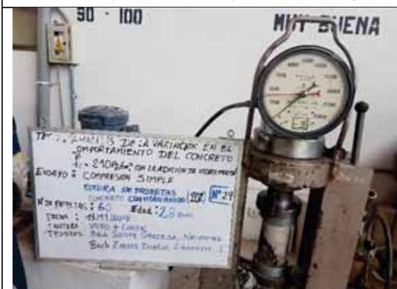
Probeta N° 29. Concreto con 20% de VM a los 28 días
