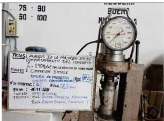
Probeta N° 06. Concreto con 40% de VM a los 28 días
