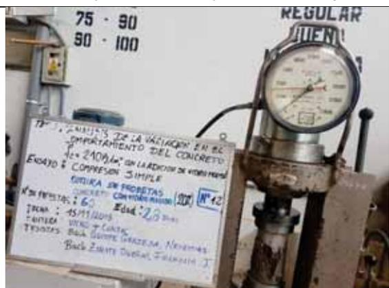
Probeta N° 12. Concreto con 20% de VM a los 28 días
