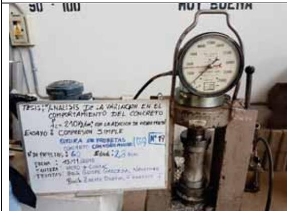
Probeta N° 19. Concreto con 0% de VM a los 28 días
