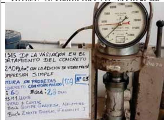
Probeta N° 03. Concreto con 0% de VM a los 28 días
