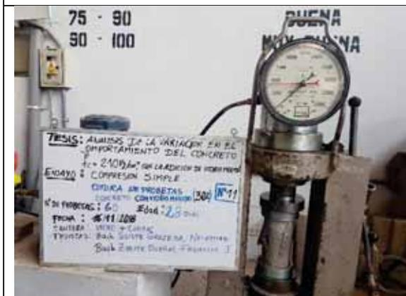
Probeta N° 11. Concreto con 30% de VM a los 28 días
