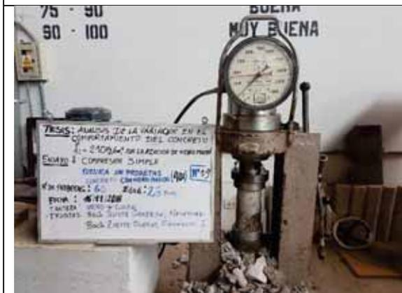
Probeta N° 19. Concreto con 40% de VM a los 28 días
