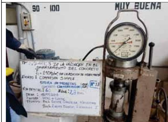
Probeta N° 33. Concreto con 20% de VM a los 28 días
