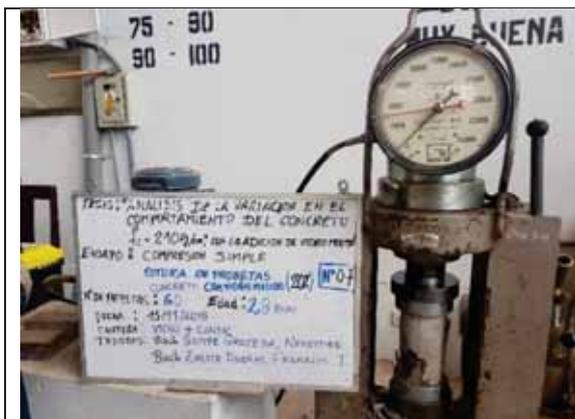
Probeta N° 07. Concreto con 20% de VM a los 28 días
