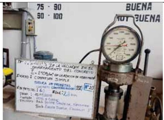
Probeta N° 20. Concreto con 20% de VM a los 28 días
