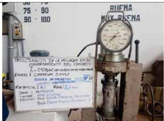
Probeta N° 58. Concreto con 0% de VM a los 28 días
