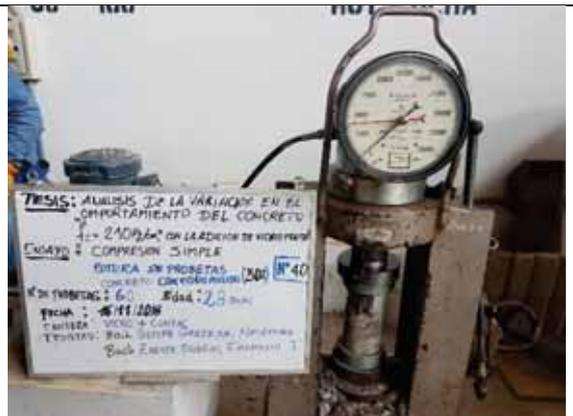
Probeta N° 40. Concreto con 30% de VM a los 28 días
