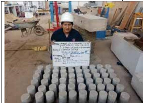
60 Probetas de concreto con 30% de VM a los 28 días
