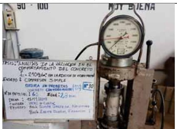
Probeta N° 30. Concreto con 0% de VM a los 28 días
