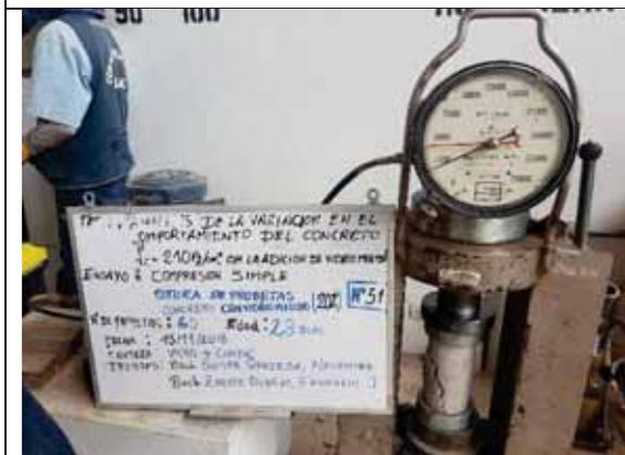
Probeta N° 51. Concreto con 20% de VM a los 28 días
