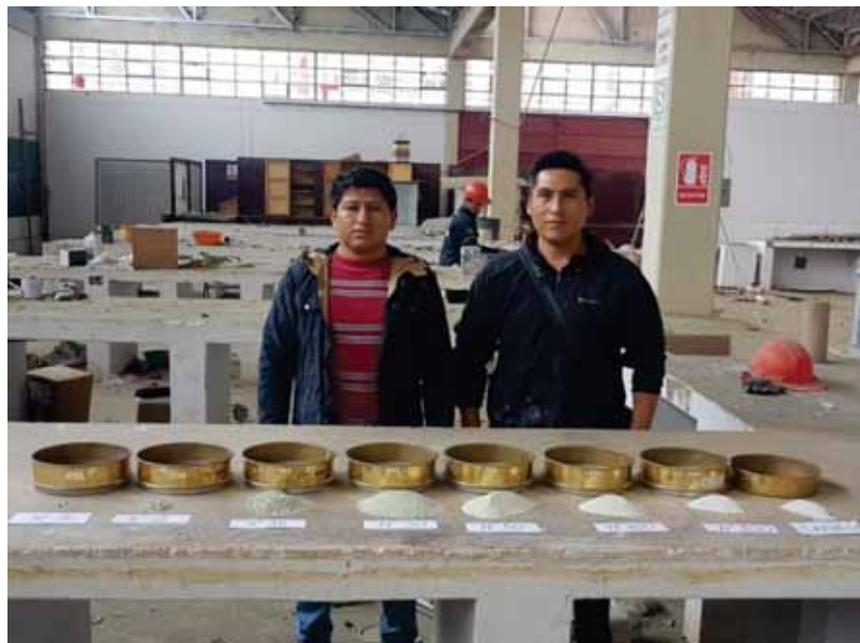
**Figura 22.** Granulometría del agregado fino - Vidrio molido
