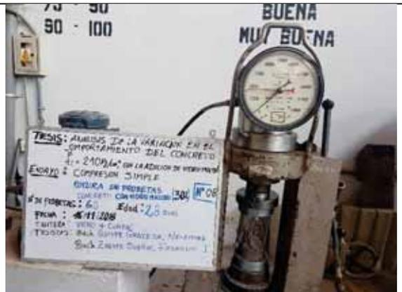
Probeta N° 08. Concreto con 30% de VM a los 28 días
