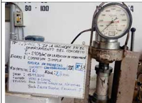
Probeta N° 53. Concreto con 20% de VM a los 28 días
