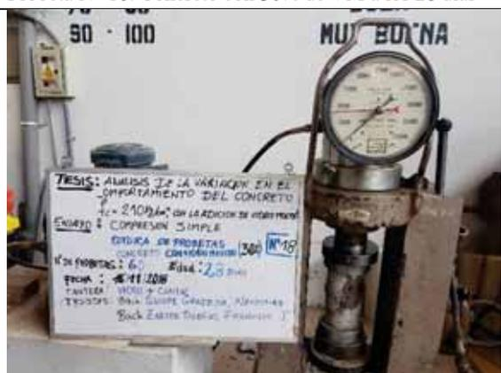
Probeta N° 18. Concreto con 30% de VM a los 28 días
