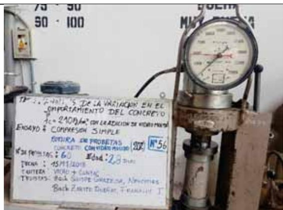
Probeta N° 56. Concreto con 20% de VM a los 28 días
