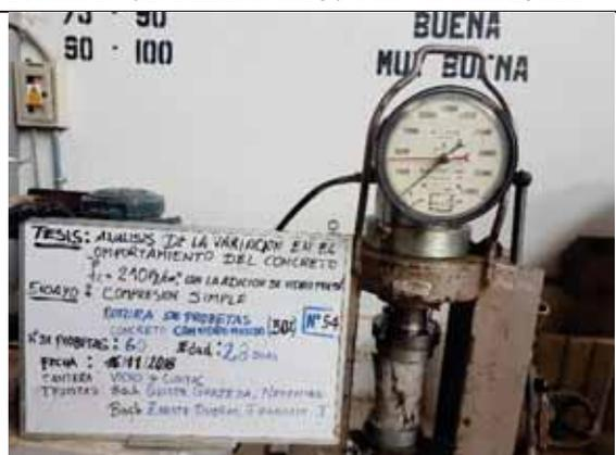
Probeta N° 54. Concreto con 30% de VM a los 28 días
