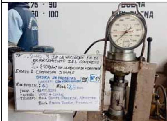
Probeta N° 49. Concreto con 20% de VM a los 28 días
