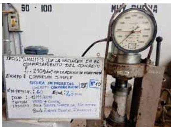
Probeta N° 10. Concreto con 20% de VM a los 28 días
