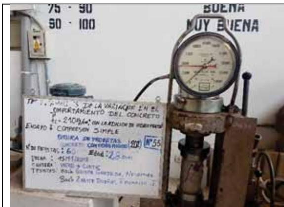
Probeta N° 55. Concreto con 20% de VM a los 28 días
