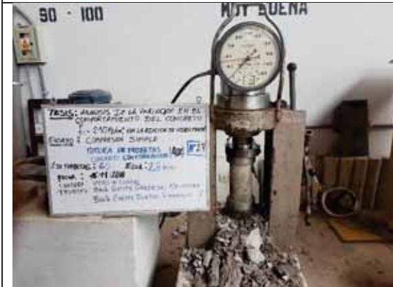
Probeta N° 27. Concreto con 40% de VM a los 28 días
