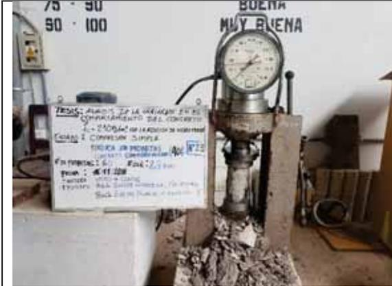
Probeta N° 23. Concreto con 40% de VM a los 28 días
