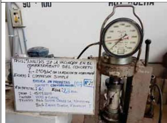
Probeta N° 21. Concreto con 0% de VM a los 28 días
