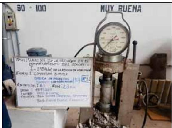
Probeta N° 52. Concreto con 0% de VM a los 28 días
