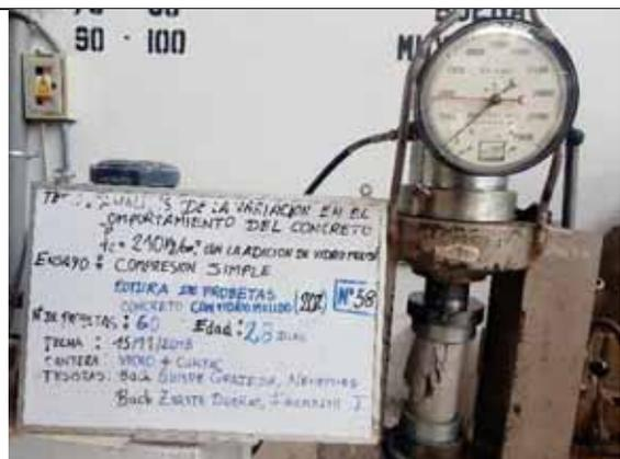
Probeta N° 58. Concreto con 20% de VM a los 28 días
