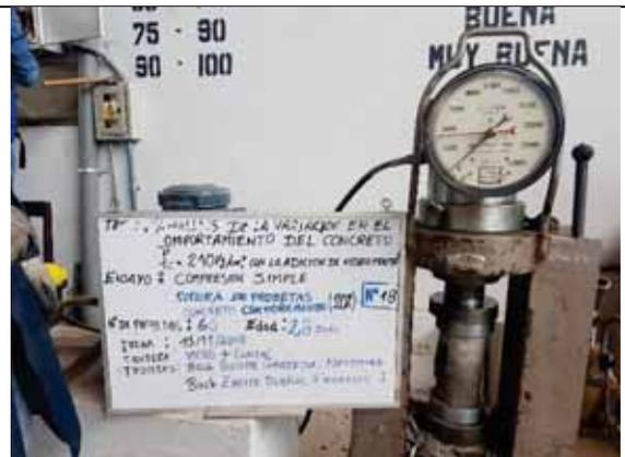
Probeta N° 18. Concreto con 20% de VM a los 28 días
