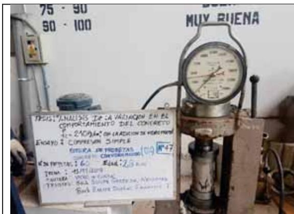
Probeta N° 47. Concreto con 0% de VM a los 28 días
