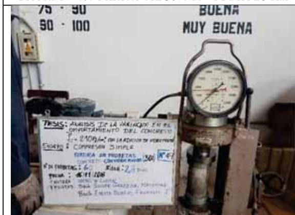
Probeta N° 49. Concreto con 30% de VM a los 28 días
