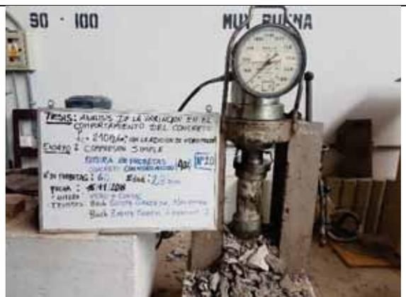
Probeta N° 20. Concreto con 40% de VM a los 28 días
