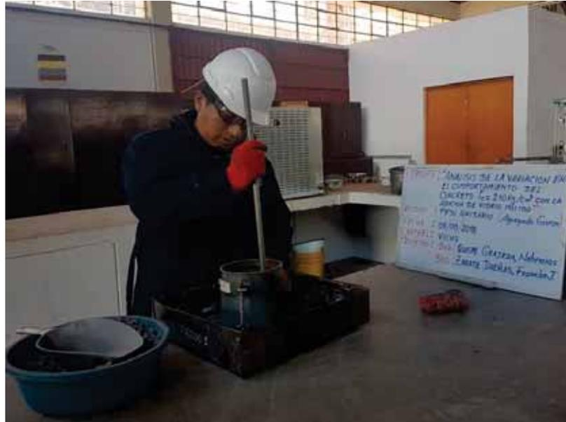
**Figura 29.** Llenado y apisonado del agregado grueso en Próctor
