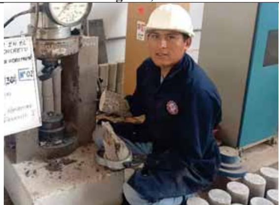
Probeta de concreto con 30% VM luego del ensayo
