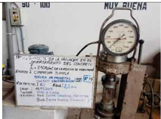
Probeta N° 34. Concreto con 20% de VM a los 28 días
