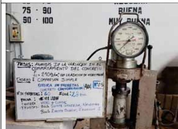
Probeta N° 05. Concreto con 40% de VM a los 28 días
