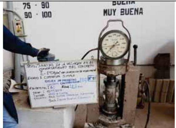
Probeta N° 18. Concreto con 0% de VM a los 28 días
