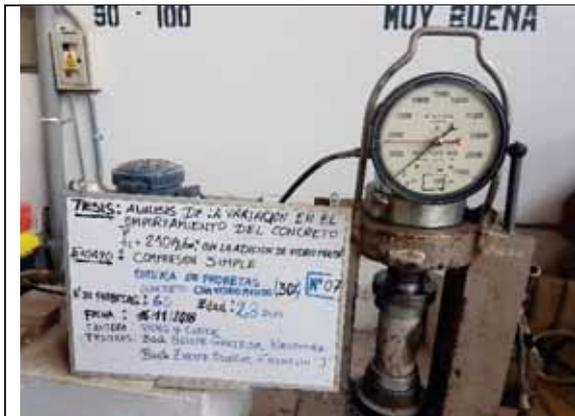
Probeta N° 07. Concreto con 30% de VM a los 28 días
