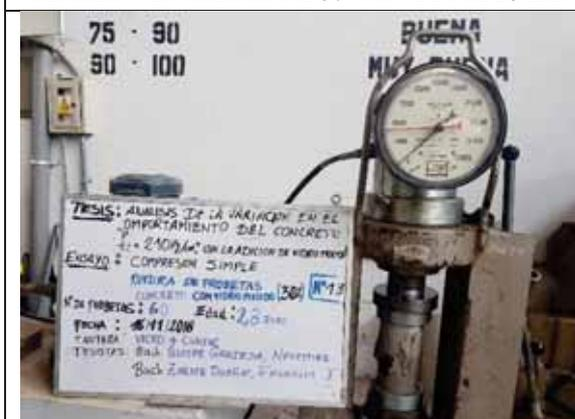
Probeta N° 13. Concreto con 30% de VM a los 28 días
