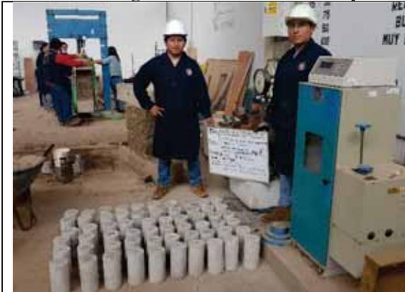
60 Probetas de concreto con 40% de VM a los 28 días
