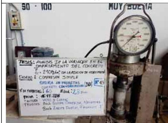
Probeta N° 45. Concreto con 30% de VM a los 28 días
