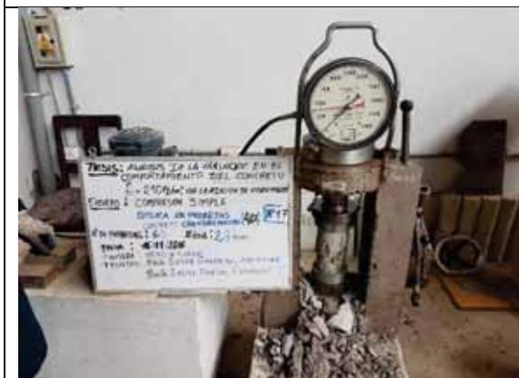
Probeta N° 17. Concreto con 40% de VM a los 28 días
