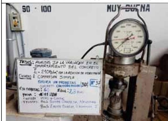
Probeta N° 37. Concreto con 30% de VM a los 28 días
