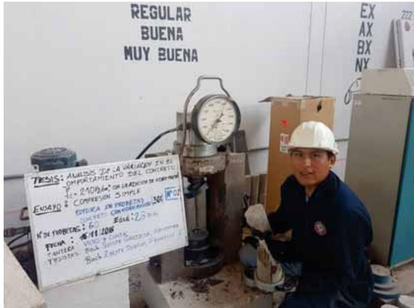
**Figura 46.** Rotura de briquetas de concreto de  $f'_c=210\text{kg/cm}^2$  con 30 % de vidrio molido, a la edad de 28 días.
