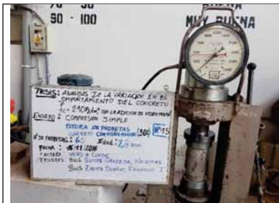
Probeta N° 15. Concreto con 30% de VM a los 28 días
