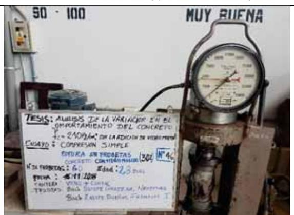
Probeta N° 46. Concreto con 30% de VM a los 28 días
