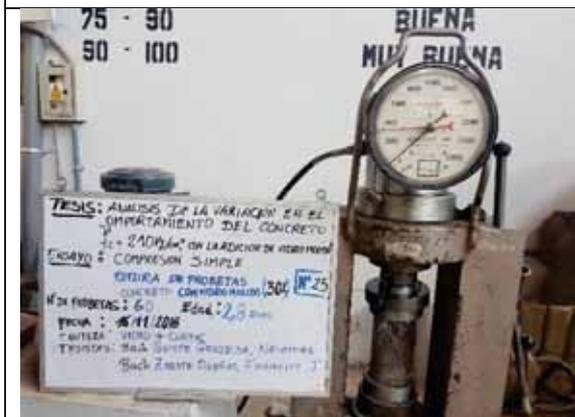
Probeta N° 25. Concreto con 30% de VM a los 28 días
