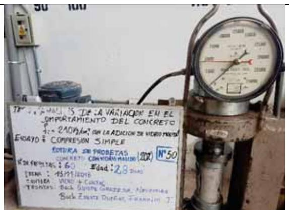
Probeta N° 50. Concreto con 20% de VM a los 28 días
