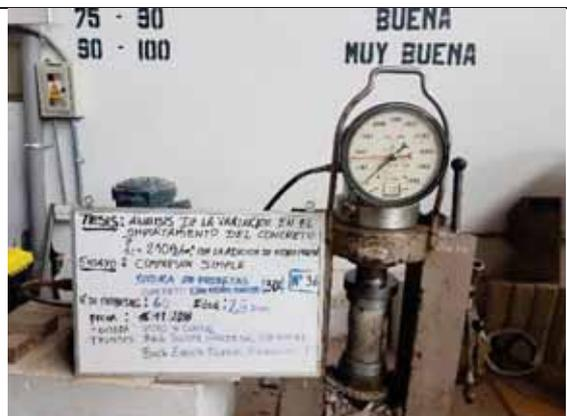
Probeta N° 36. Concreto con 30% de VM a los 28 días
