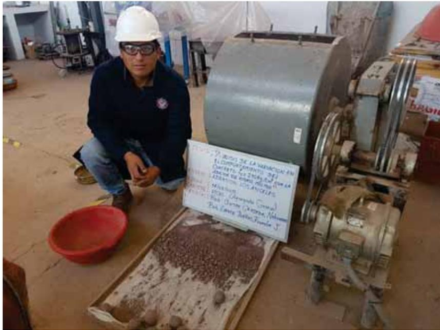
**Figura 35.** Muestra retirada de la máquina de Los Ángeles, luego del ensayo.
