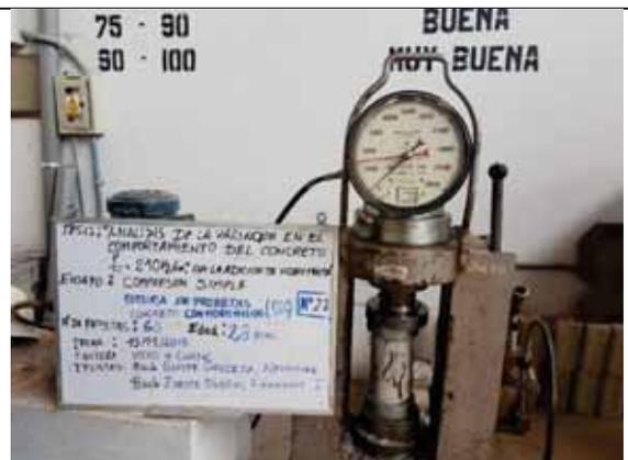
Probeta N° 22. Concreto con 0% de VM a los 28 días
