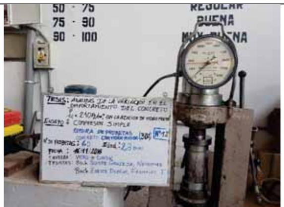
Probeta N° 12. Concreto con 30% de VM a los 28 días
