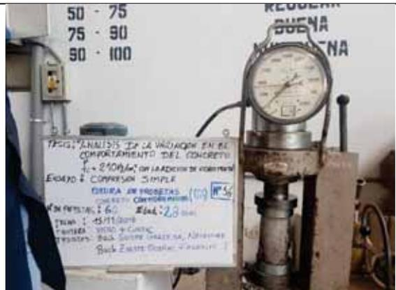
Probeta N° 56. Concreto con 0% de VM a los 28 días
