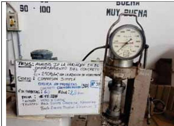
Probeta N° 39. Concreto con 30% de VM a los 28 días
