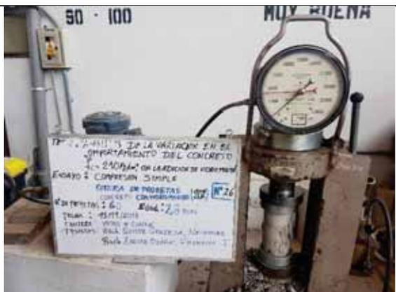
Probeta N° 26. Concreto con 20% de VM a los 28 días
