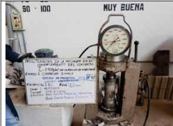
Probeta N° 17. Concreto con 0% de VM a los 28 días
