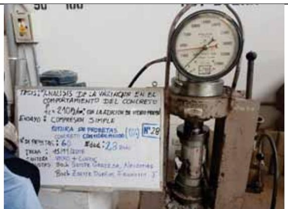
Probeta N° 28. Concreto con 0% de VM a los 28 días
