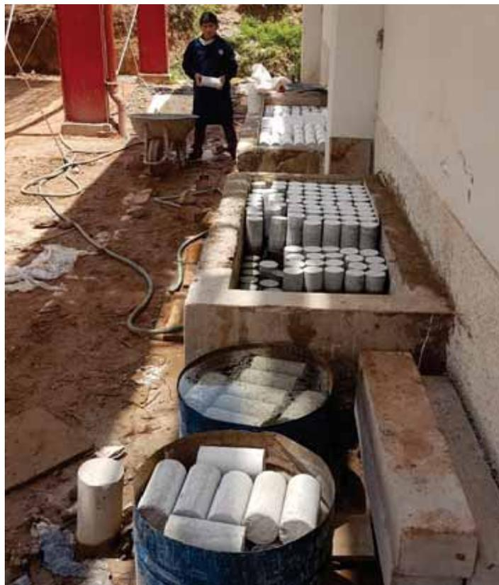
**Figura 43.** Probetas de concreto, en los pozos de curado y cilindros
