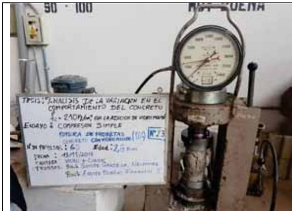
Probeta N° 23. Concreto con 0% de VM a los 28 días
