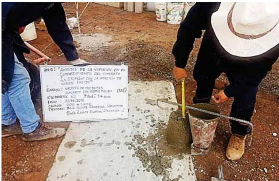
*Figura 39.* Prueba de revenimiento del concreto
