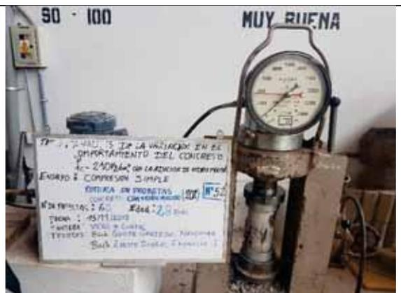
Probeta N° 52. Concreto con 20% de VM a los 28 días
