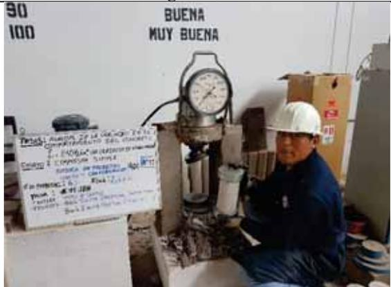
Probeta de concreto con 40% VM antes del ensayo
