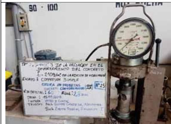
Probeta N° 25. Concreto con 20% de VM a los 28 días
