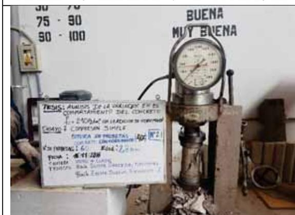
Probeta N° 21. Concreto con 40% de VM a los 28 días
