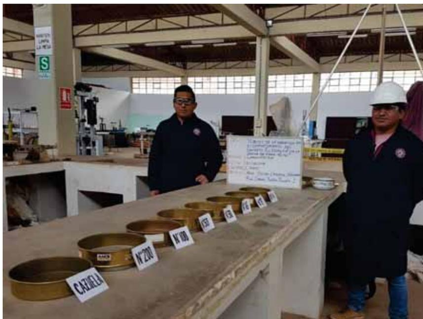
**Figura 20.** Granulometría del agregado fino - Arena fina de Cunyac
