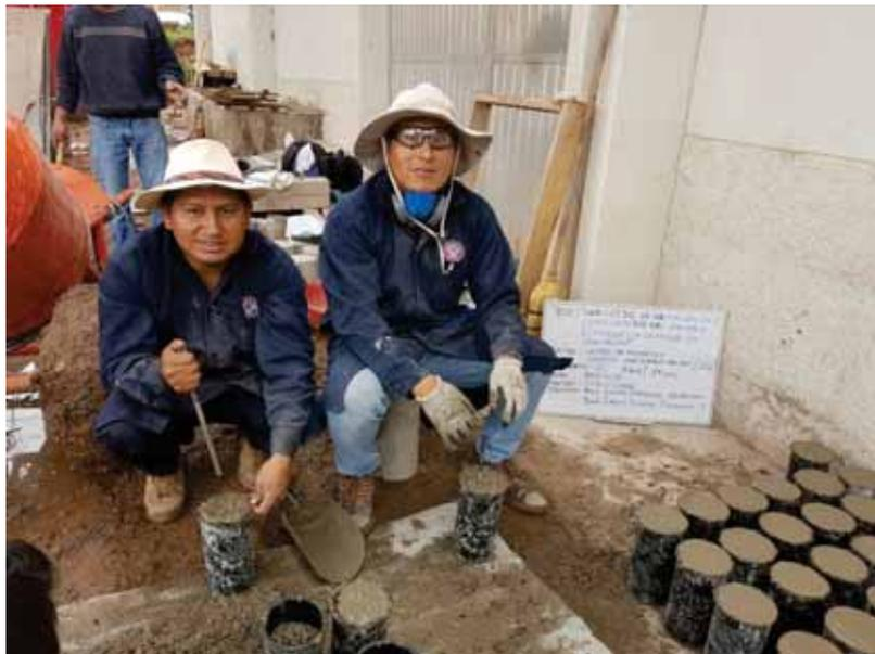
*Figura 40.* Llenado de los moldes cilíndricos con concreto
