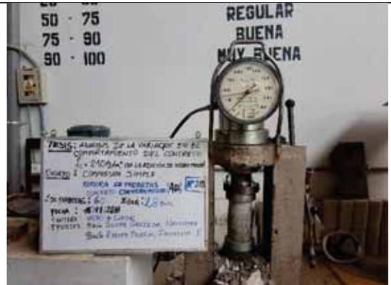
Probeta N° 28. Concreto con 40% de VM a los 28 días
