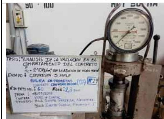
Probeta N° 29. Concreto con 0% de VM a los 28 días
