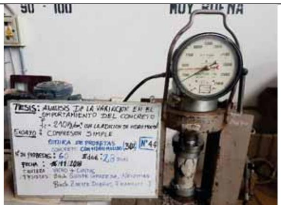
Probeta N° 44. Concreto con 30% de VM a los 28 días
