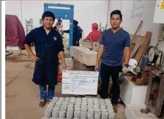
60 Probetas de concreto con 0% de VM a los 28 días
