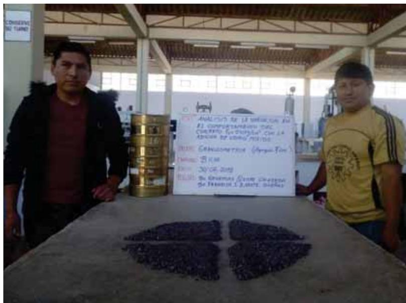
*Figura 17.* Selección de la muestra representativa del agregado fino
