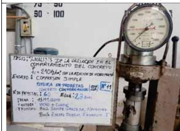
Probeta N° 11. Concreto con 20% de VM a los 28 días
