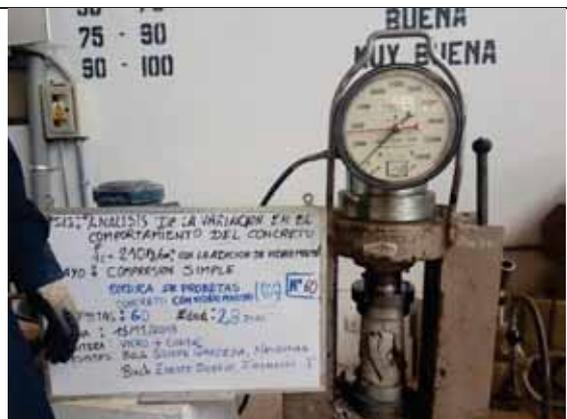
Probeta N° 60. Concreto con 0% de VM a los 28 días
