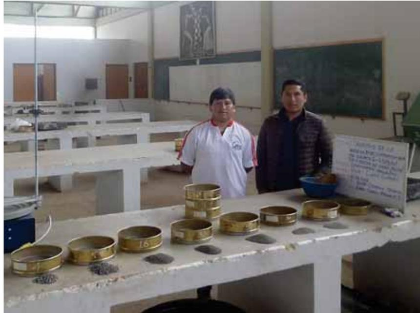
**Figura 21.** Granulometría del agregado fino corregido - (70% Confitillo + 30% Arena fina de Cunyac)
