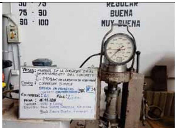
Probeta N° 34. Concreto con 30% de VM a los 28 días
