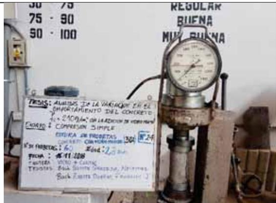
Probeta N° 24. Concreto con 30% de VM a los 28 días
