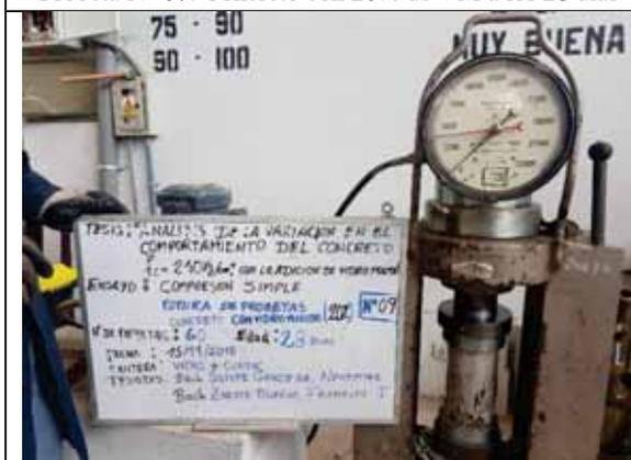
Probeta N° 09. Concreto con 20% de VM a los 28 días
