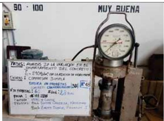
Probeta N° 48. Concreto con 30% de VM a los 28 días
