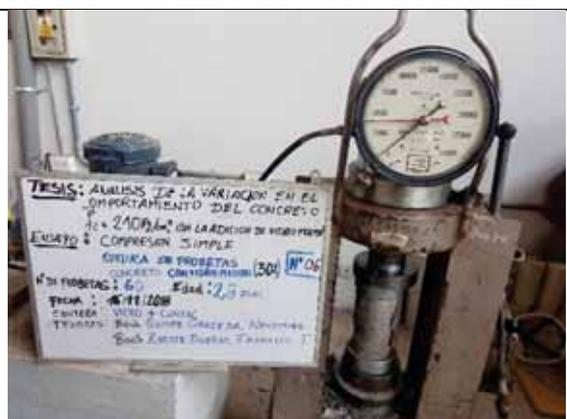
Probeta N° 06. Concreto con 30% de VM a los 28 días
