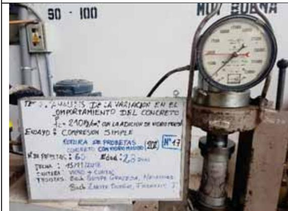
Probeta N° 17. Concreto con 20% de VM a los 28 días
