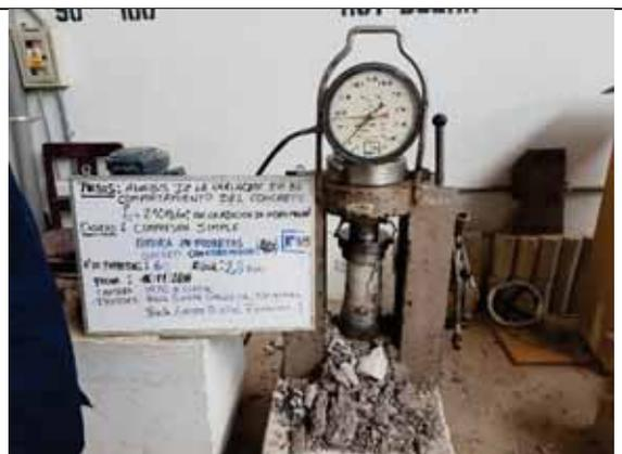
Probeta N° 18. Concreto con 40% de VM a los 28 días
