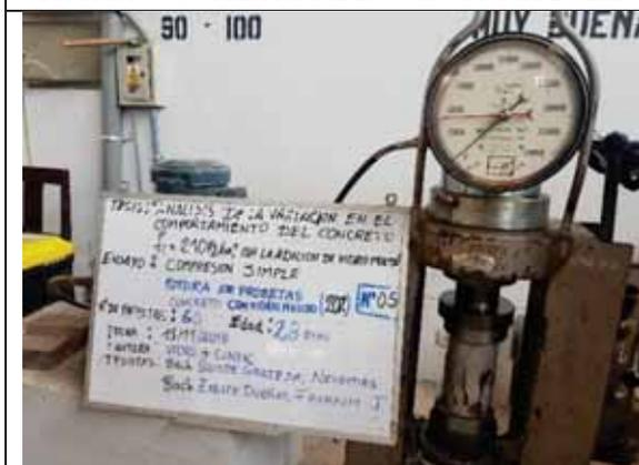
Probeta N° 05. Concreto con 20% de VM a los 28 días
