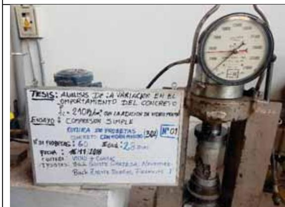
Probeta N° 01. Concreto con 30% de VM a los 28 días
