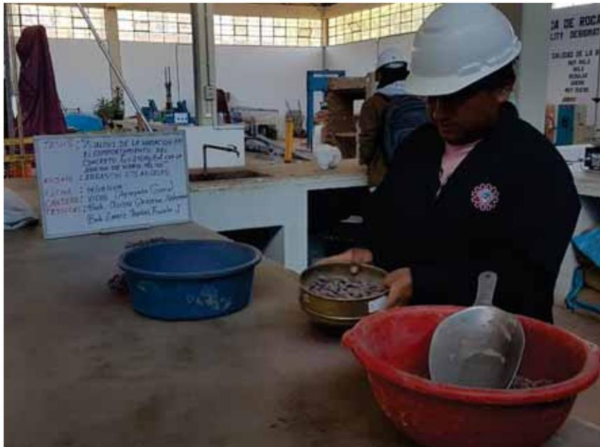
**Figura 36.** Tamizado de la muestra resultante con la malla N° 12
