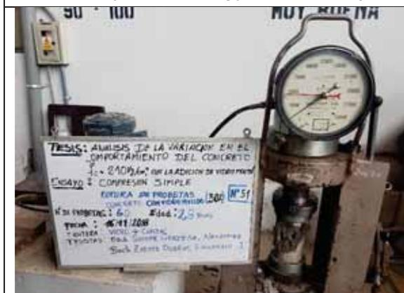
Probeta N° 51. Concreto con 30% de VM a los 28 días
