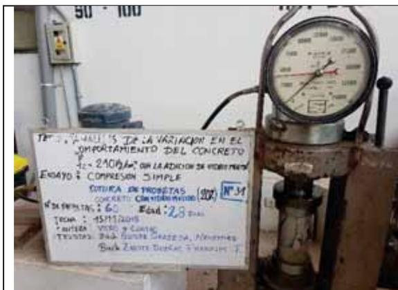
Probeta N° 31. Concreto con 20% de VM a los 28 días
