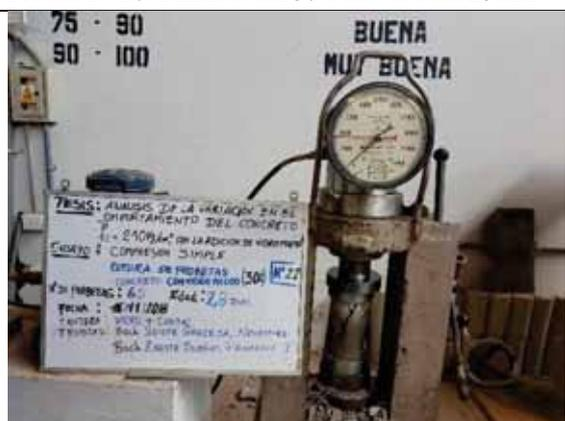
Probeta N° 22. Concreto con 30% de VM a los 28 días
