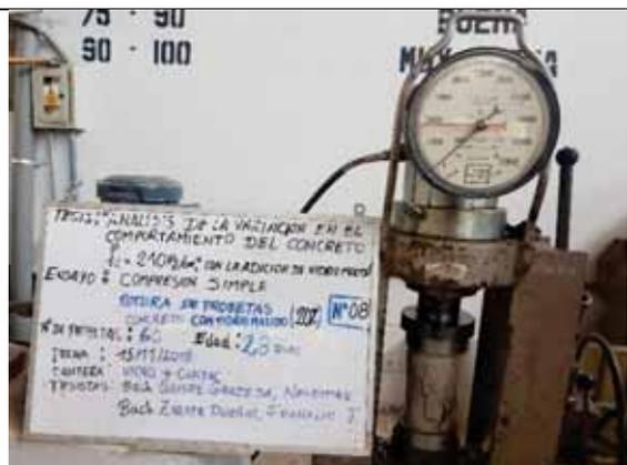
Probeta N° 08. Concreto con 20% de VM a los 28 días
