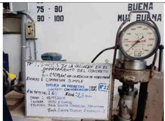
Probeta N° 22. Concreto con 20% de VM a los 28 días
