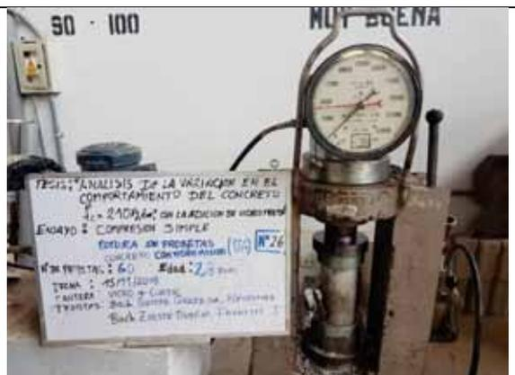
Probeta N° 26. Concreto con 0% de VM a los 28 días
