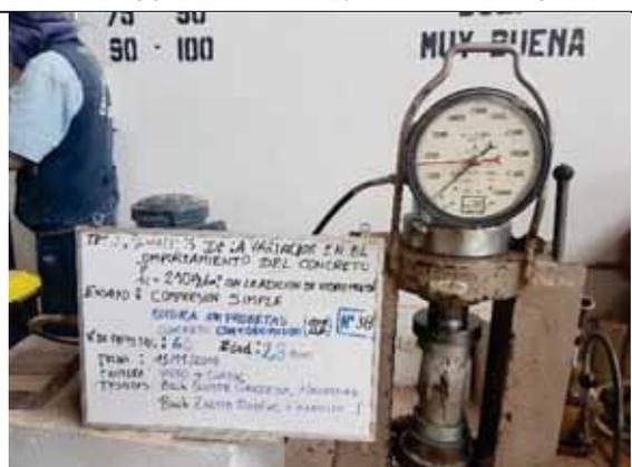
Probeta N° 38. Concreto con 20% de VM a los 28 días
