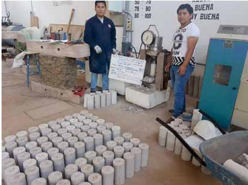
Figura 45. Probetas de concreto con 0% y 20% de vidrio molido a edad de 07 días, que fueron sometidos a ensayo de compresión
