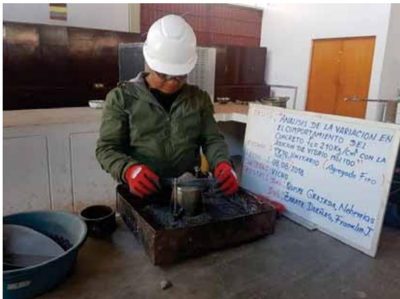
*Figura 28.* Enrasado del agregado fino corregido
