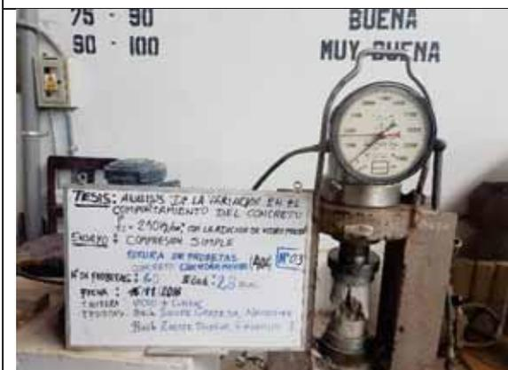
Probeta N° 03. Concreto con 40% de VM a los 28 días
