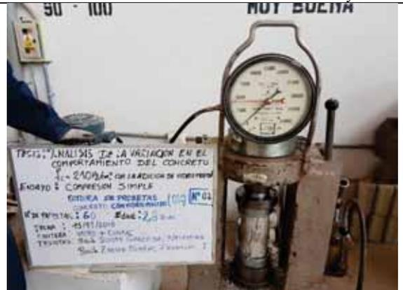
Probeta N° 02. Concreto con 0% de VM a los 28 días
