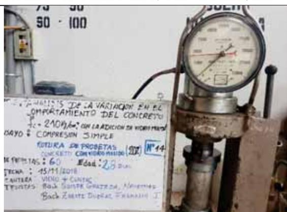
Probeta N° 14. Concreto con 20% de VM a los 28 días
