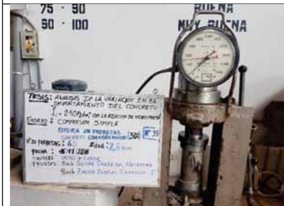
Probeta N° 35. Concreto con 30% de VM a los 28 días
