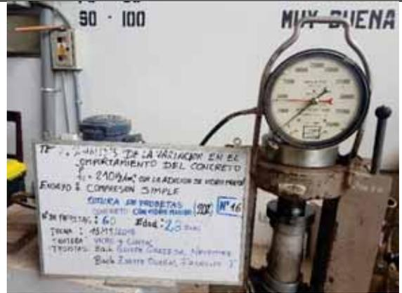
Probeta N° 16. Concreto con 20% de VM a los 28 días
