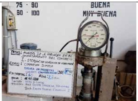
Probeta N° 10. Concreto con 30% de VM a los 28 días
