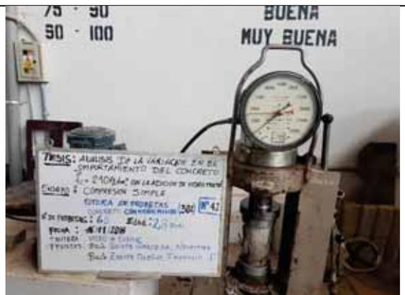
Probeta N° 42. Concreto con 30% de VM a los 28 días
