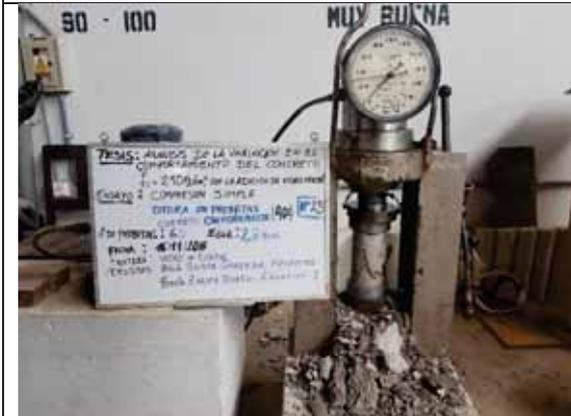
Probeta N° 25. Concreto con 40% de VM a los 28 días
