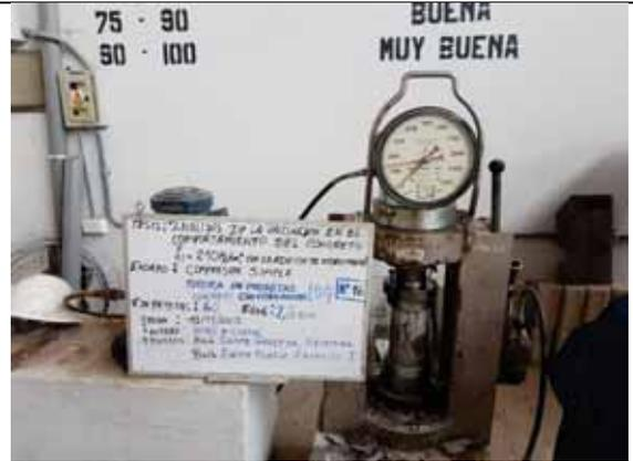
Probeta N° 16. Concreto con 0% de VM a los 28 días
