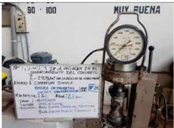
Probeta N° 28. Concreto con 20% de VM a los 28 días
