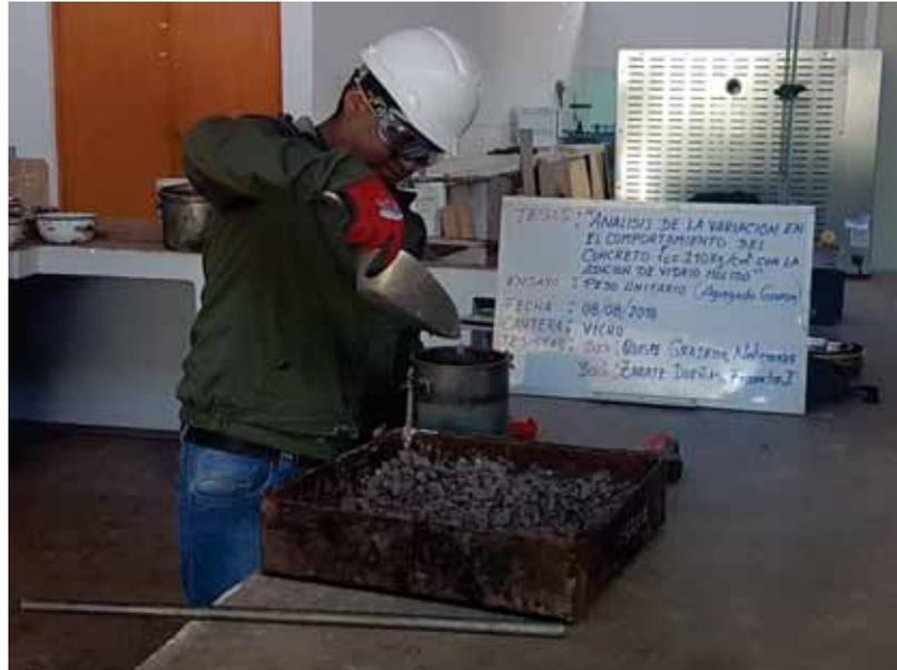
*Figura 25.* Llenado del Próctor con agregado grueso
