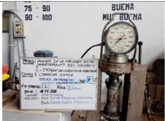
Probeta N° 32. Concreto con 30% de VM a los 28 días
