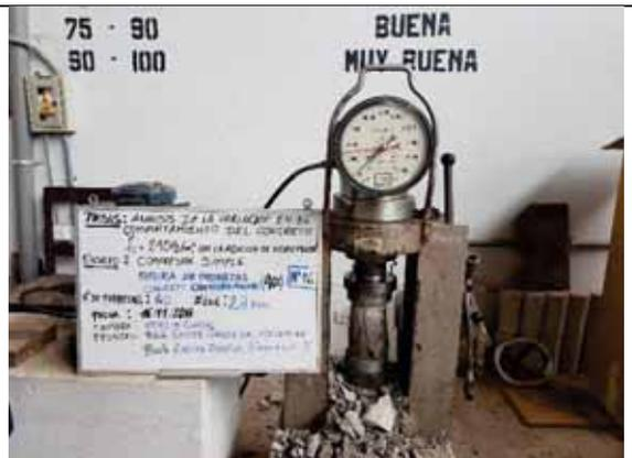
Probeta N° 16. Concreto con 40% de VM a los 28 días
