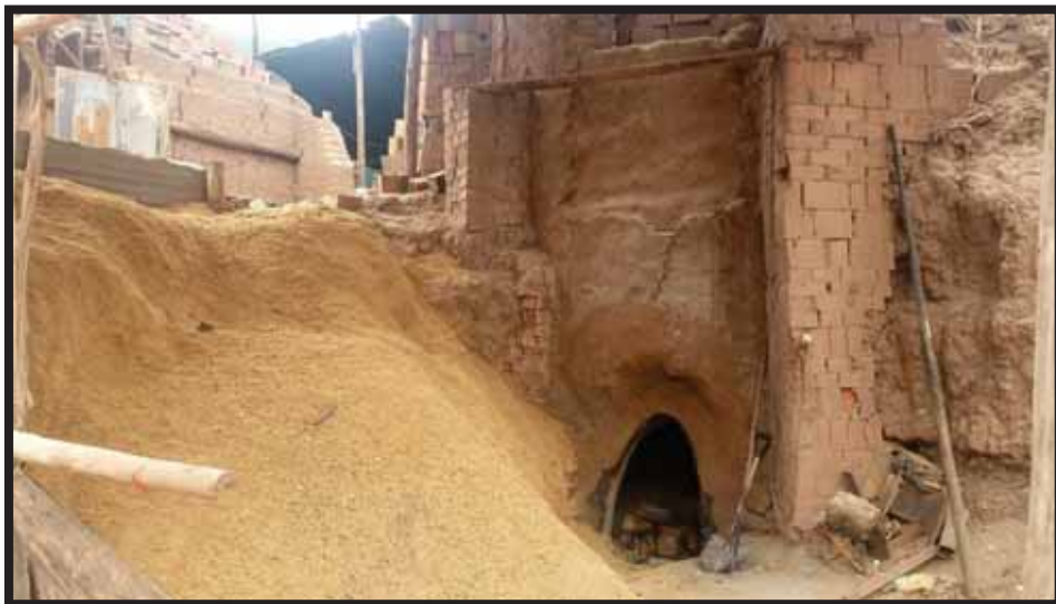
6. Horno artesanal para la elaboración de ladrillos y tejas.
