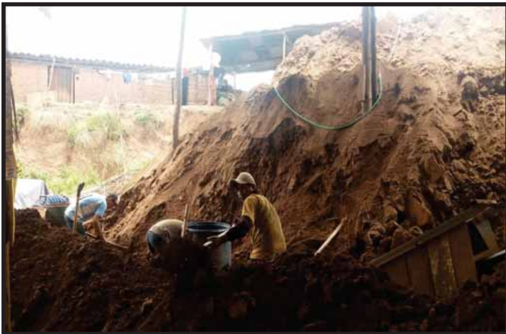
8. Preparación del material para la elaboración de tejas y ladrillos.
