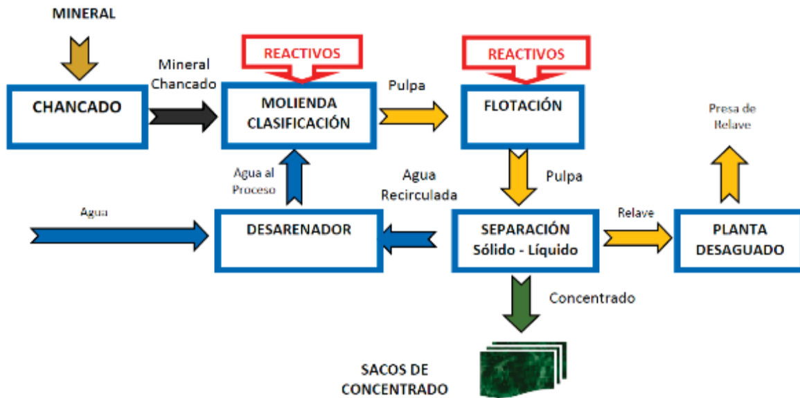
Imagen 18: Proceso de tratamiento de minerales en U.M. Selene.
