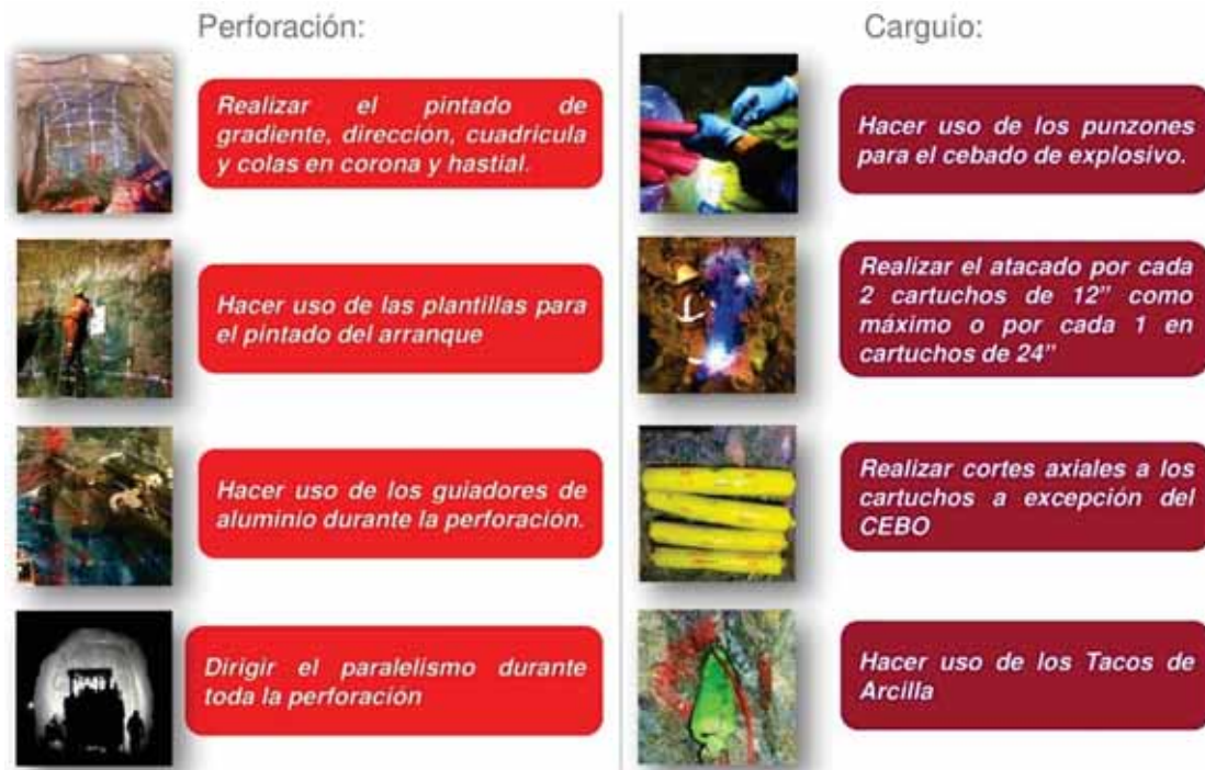
Imagen 43: Reglas de oro de perforación y voladura
