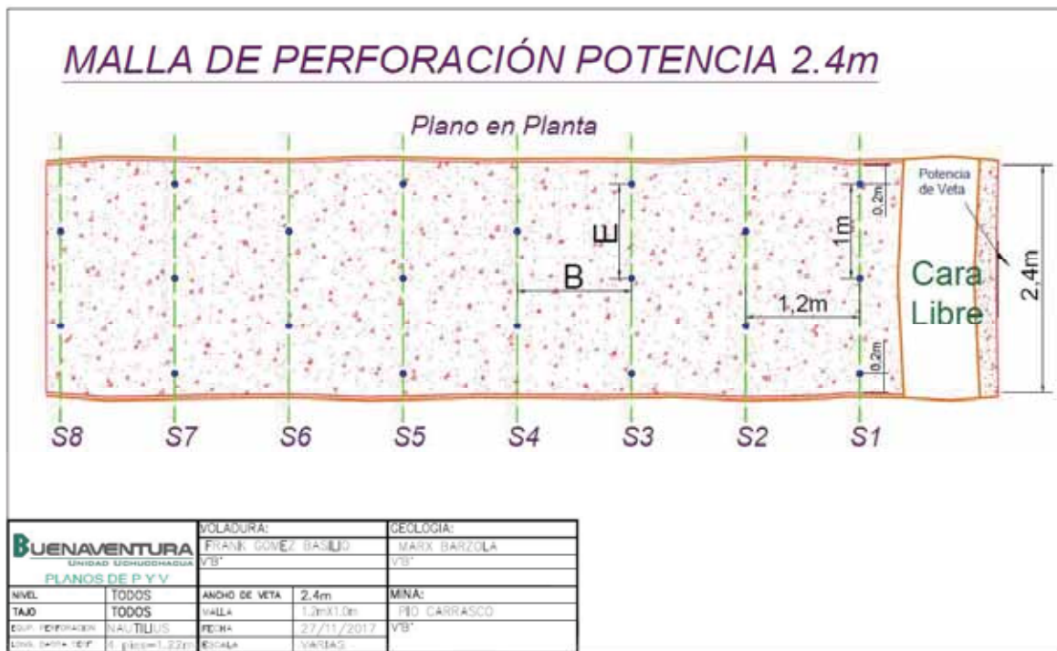
Gráfico 7. Malla de perforación para potencia de 2.4 m
