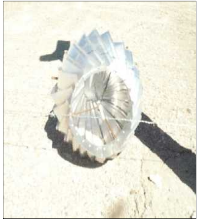
VENTILADOR MAL INSTALADO CAIDO POR EFECTOS DEL VIENTO
