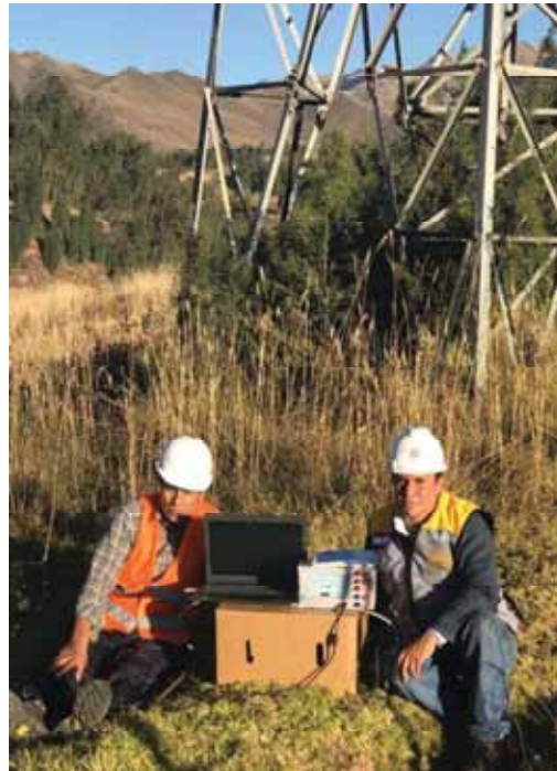
Foto 1:Medición de la RI con instrumento RIV Meter
