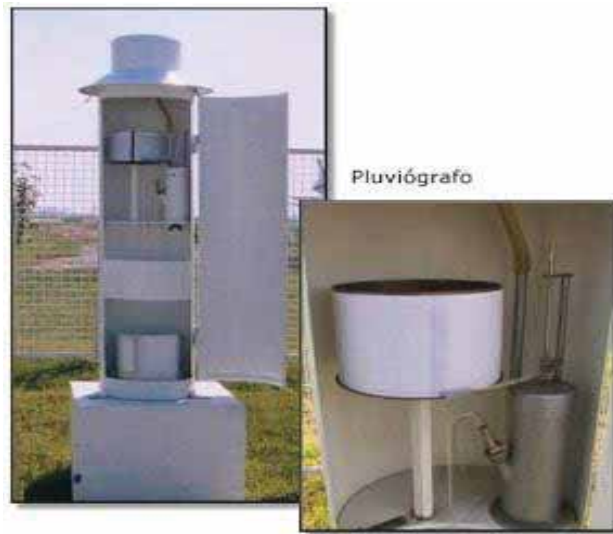
Figura 2 Pluviógrafo. Fuente: "El Pluviógrafo". Neil Carrero (2008).
