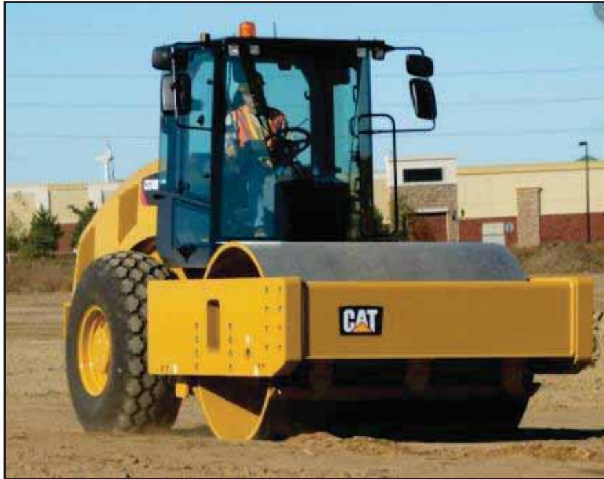
Figura N° 30: Rodillo vibratorio CAT SC533D
