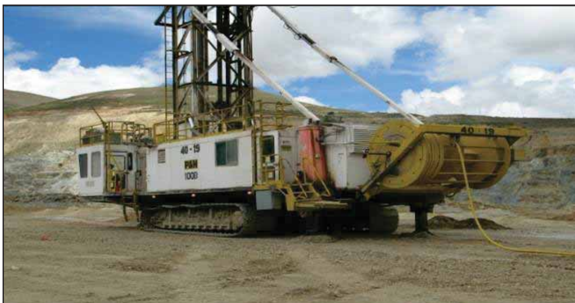
Figura N° 17: Perforadora Diésel Antapaccay.
