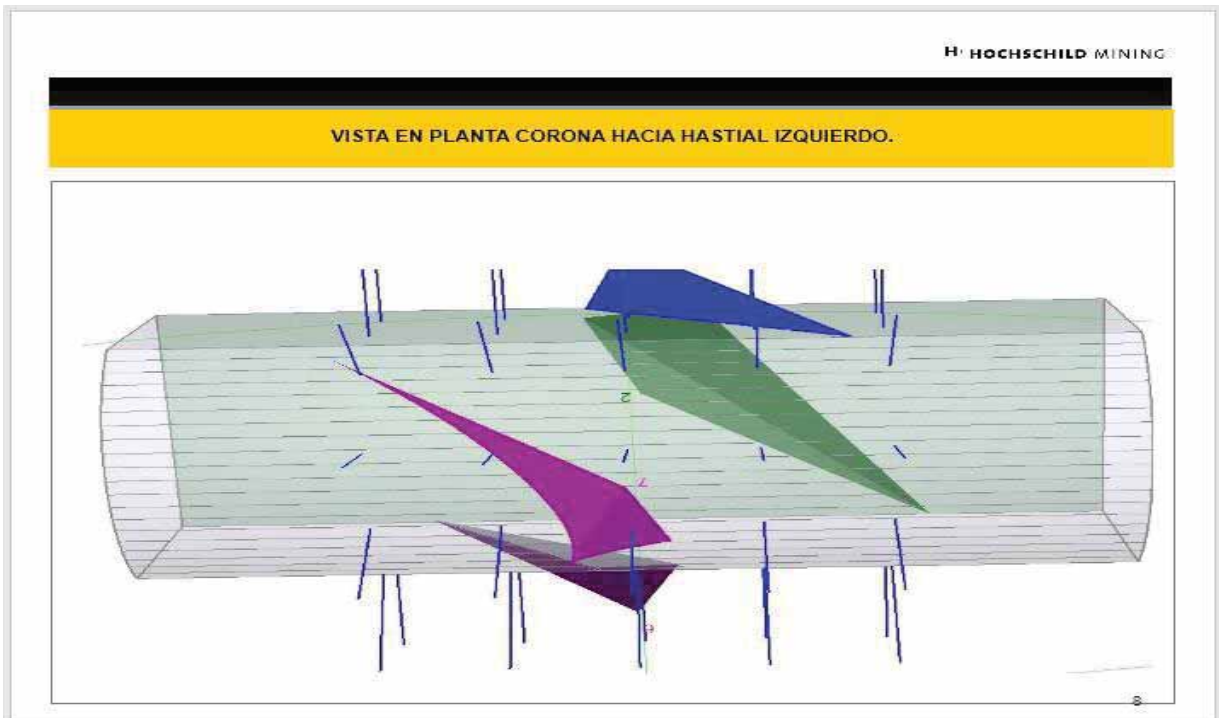
Figura 60: Estudio de la zona de desprendimiento de rocas, vista en planta corona hacia el hastial izquierdo Fuente: Elaboración propia
