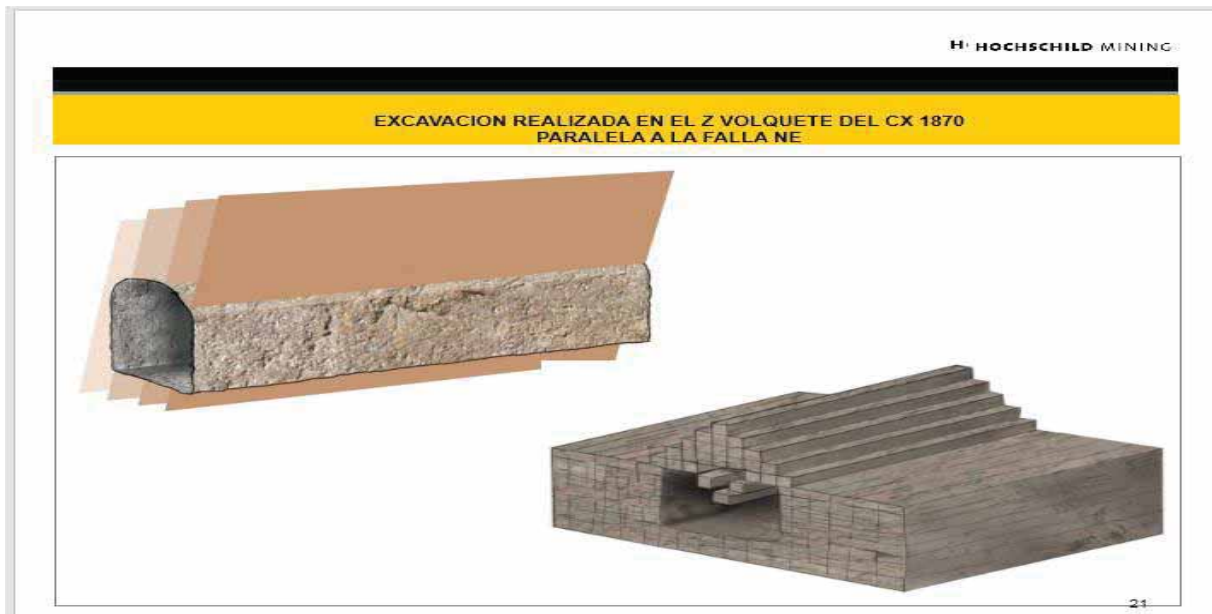
Figura 69: Excavación realizada en el Z volquete, paralela a la falla con dirección NE Fuente: Departamento de Geomecánica
