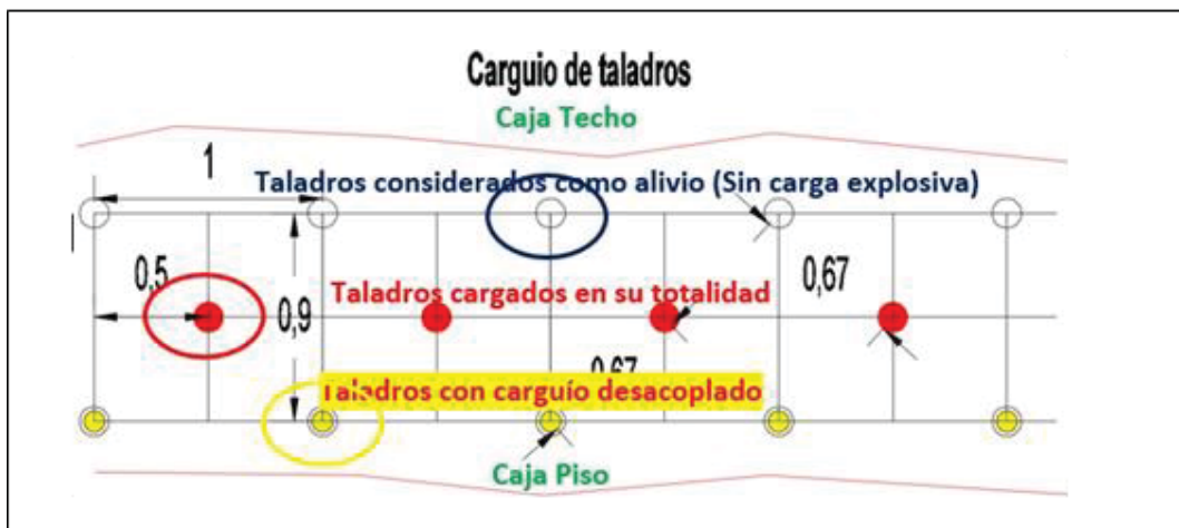
Figura N° 23: Esquema de carguío de taladros.
