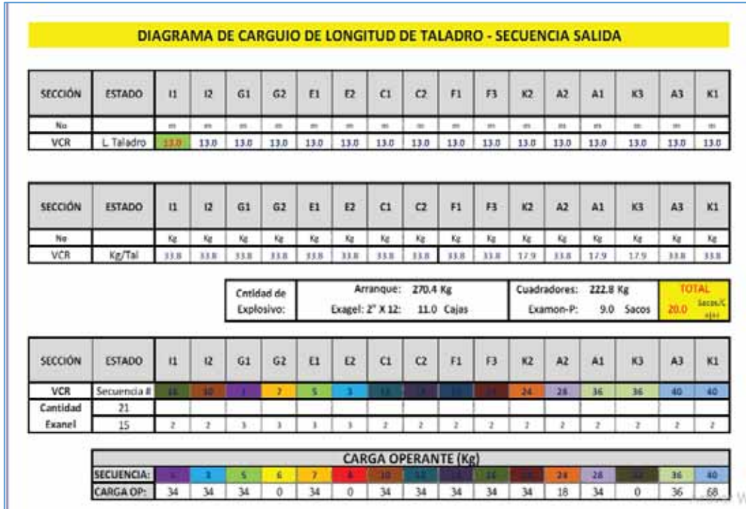
Figura N° 21: Carguío de los taladros de un VCR.
