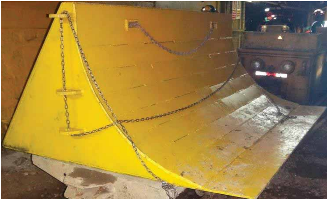
Figura N° 41: Berma metálica de seguridad terminada.
