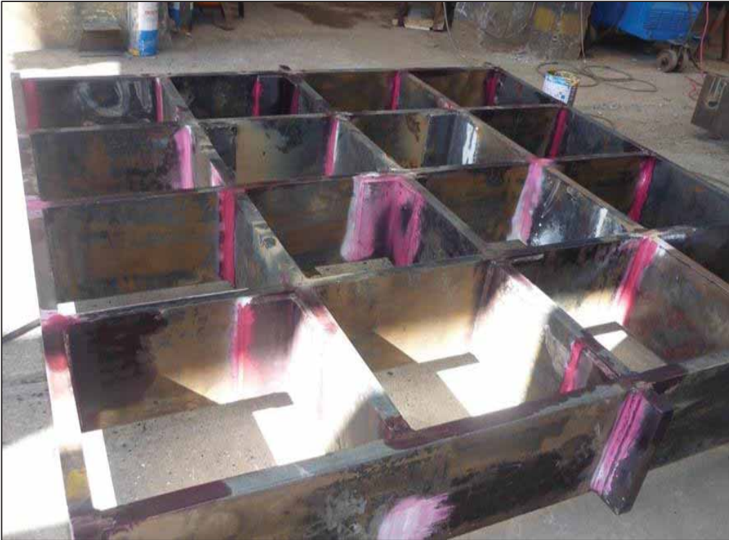
Figura N° 40: Proceso de prueba con líquidos penetrantes del proceso de soldadura.
