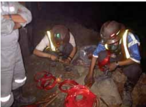
Figura 28. Cebado de Explosivos. Fuente: Mina Huarón.
