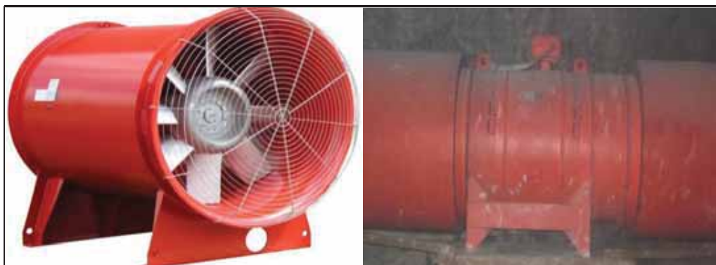
Figura 42 ventiladores de 30 000 CFM Minera Arcata. Fuente: fotografía propia mina Arcata
