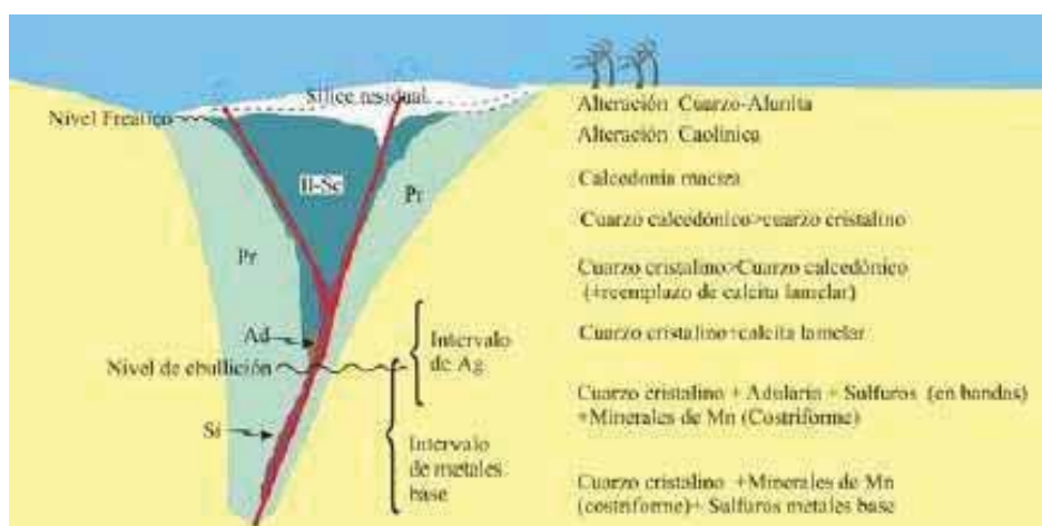
Figura 10. Esquema de la distribución vertical de minerales y metales observada en Arcata, sobre la base del modelo de Buchanan (1981). Modificado de Echavarría (1997) y Sillitoe (1998). Abreviaciones: Pr: propilitización, Alteración: illita-sericita, Ad: adularia, Si: silicificación.
