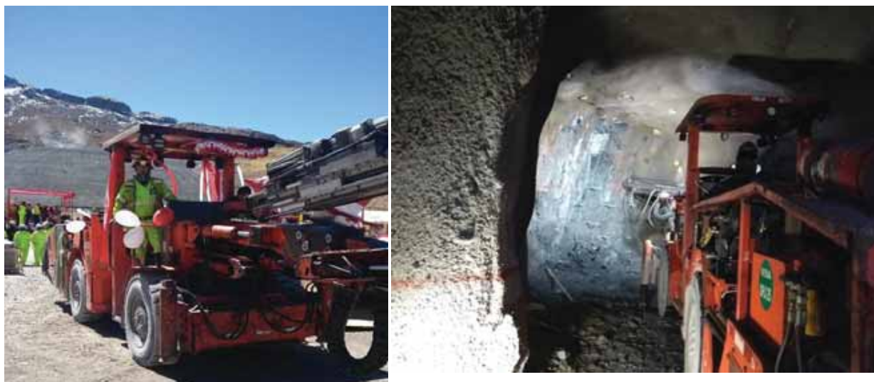
Figura 36. Jumbo SandvikTamrock de un brazo. Fuente: fotografía propia mina Arcata
