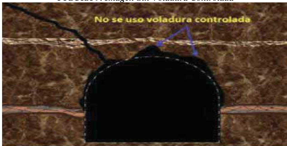
FIGURA 9. Imagen Sin Voladura Controlada
