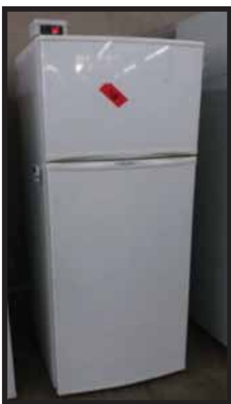
Fotografía 14: Termostato ubicado en la parte superior del refrigerador domestico
