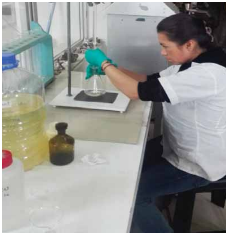
Figura 3.10. Determinación de cianuro libre por volumetría
