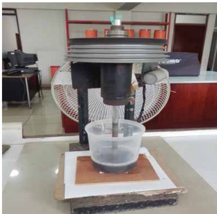
Figura 3.12. Proceso de adsorción de oro con carbón activado de cáscara de castaña por agitación.
