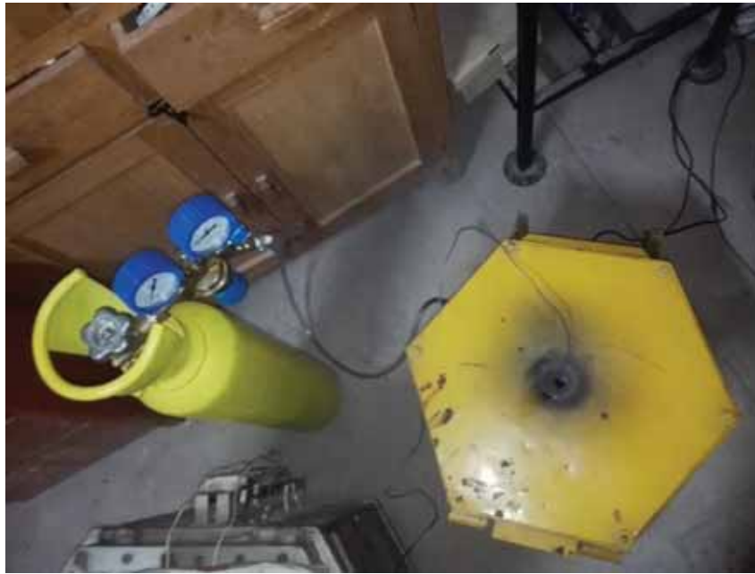
Figura 3.5. Carbónización y activación en sistema inerte generado por Nitrógeno
