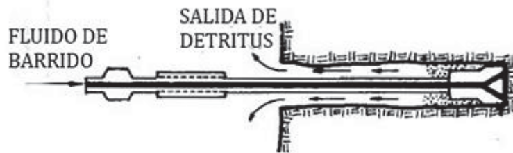
Figura 16. Principio de barrido de un barreno
