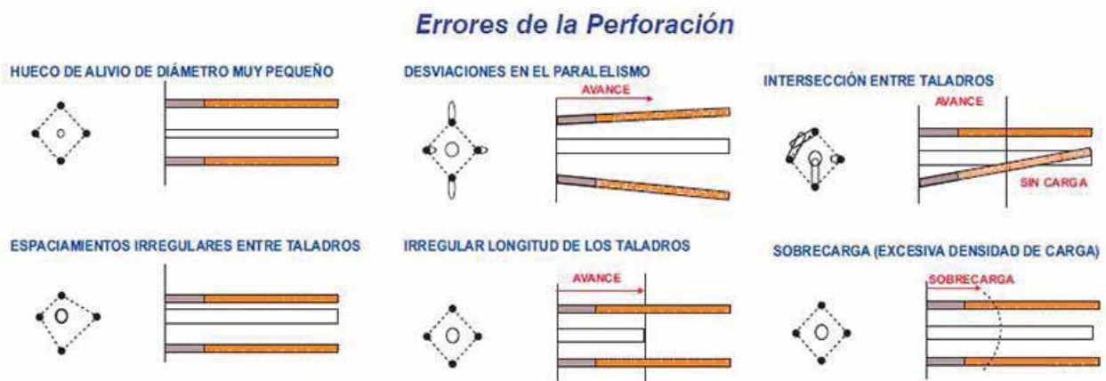
Figura 18. Fallas de perforación en los taladros
