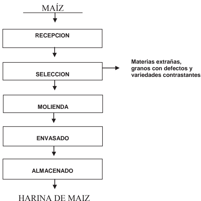
Figura 10. Diagrama de flujo para la obtención de harina de maíz.
