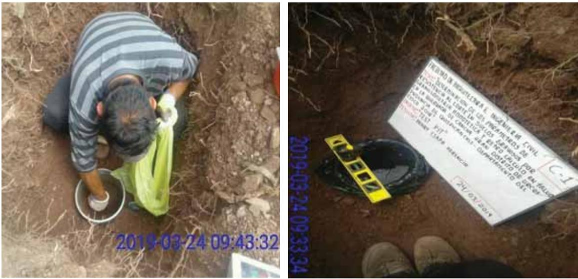
***Img. 9 Obtención de la Densidad “IN SITU” para gravas por el método de “Test Pit”
