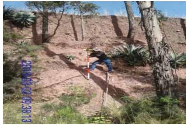
Levantamiento topográfico del talud en estudio
