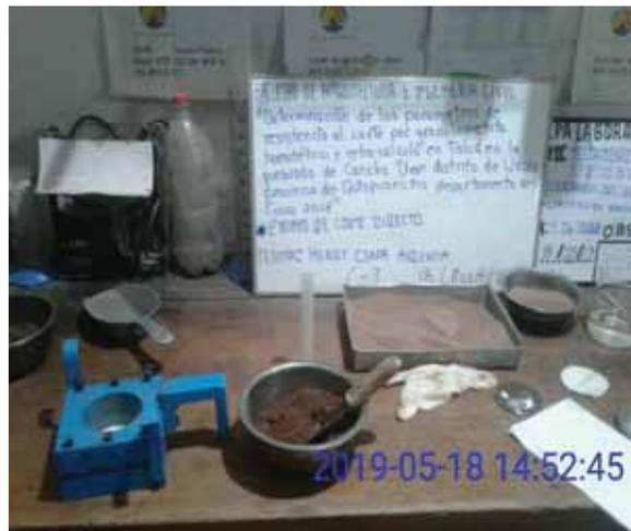
Preparación de la muestra para el ensayo de corte directo a deformación controlada en el laboratorio de mecánica de suelos “ALLPA LABORATORIO”
