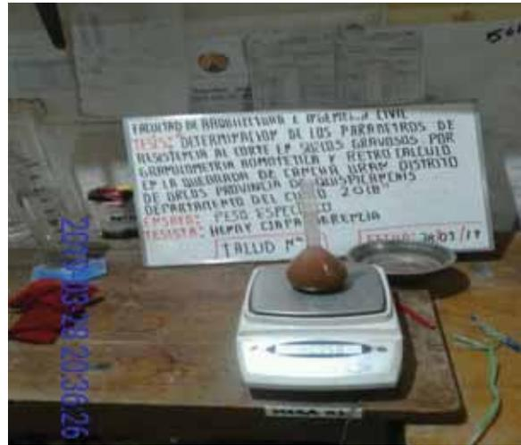
Ensayo de peso específico realizado en el laboratorio de mecánica de suelos “ALLPA LABORATORIO”
