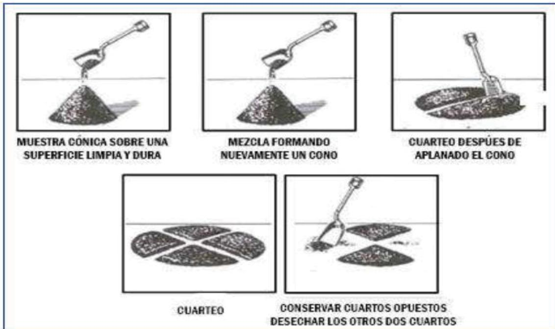
*Img. 7 Método B por cuarteo fuente MTC E 103*
