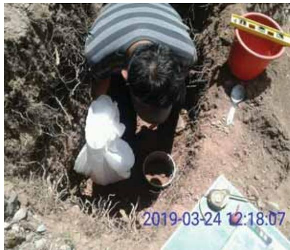
Ensayo de densidad natural Test Pit (método remplazo por agua)
