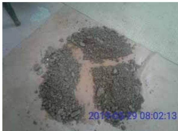
Preparación de la muestra original para el ensayo de corte directo a gran escala a carga controlada
