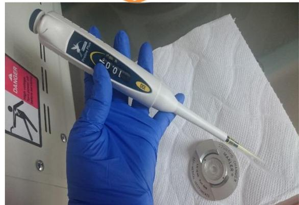
FIGURA 51: Se colocan 10 microlitros de la muestra en la cámara Makler
