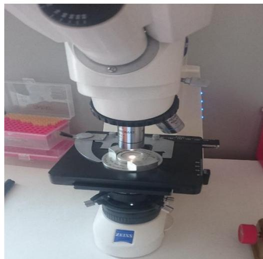
FIGURA 54: Llevar la cámara Makler al microscopio para la evaluación de la muestra
