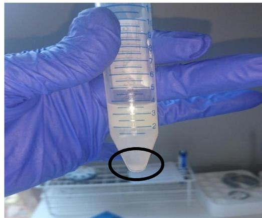
FIGURA 57: Descartar el sobrenadante y dejar solamente la muestra decantada.
