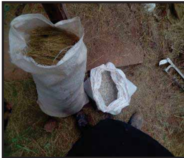
FIGURA 95. DOSIFICACION DE PLASTICO PICADO de 4.75 mm DE DIAMETRO Y PAJA de 7cm DE LONGITUD
