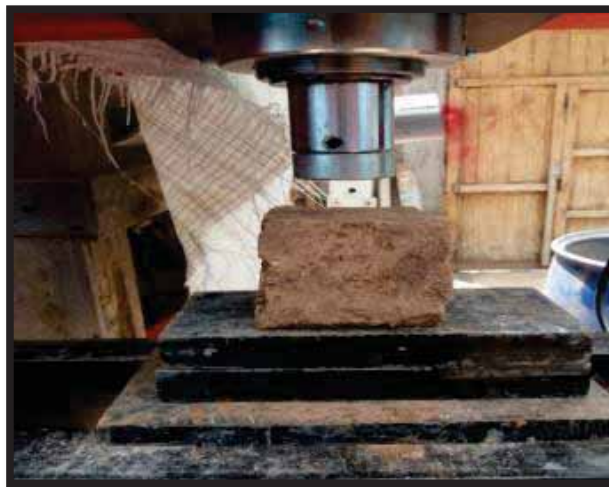
Figura 29. Ensayo de resistencia a compresión del mortero.
