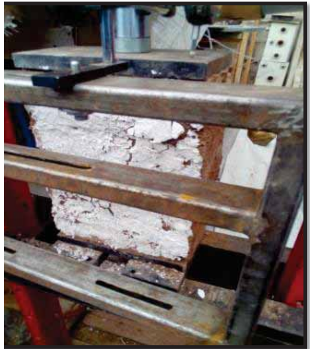
FIGURA 131. CONTROL DE LA DEFORMACION DE LA PILA
