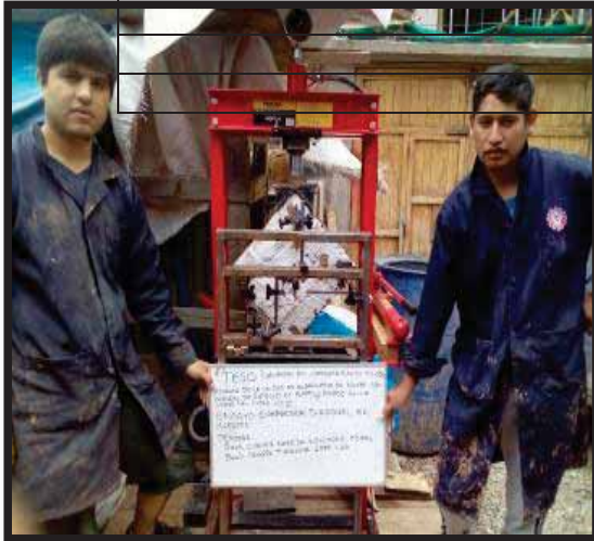
FIGURA 132. ENSAYO DE COMPRESION DIAGONAL DEL MURETE
