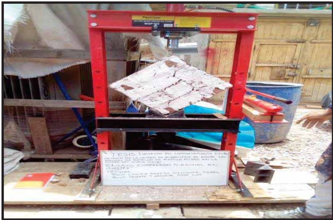
FIGURA 134. MURETE DESPUES DE SER SOMETIDO A CARGA
