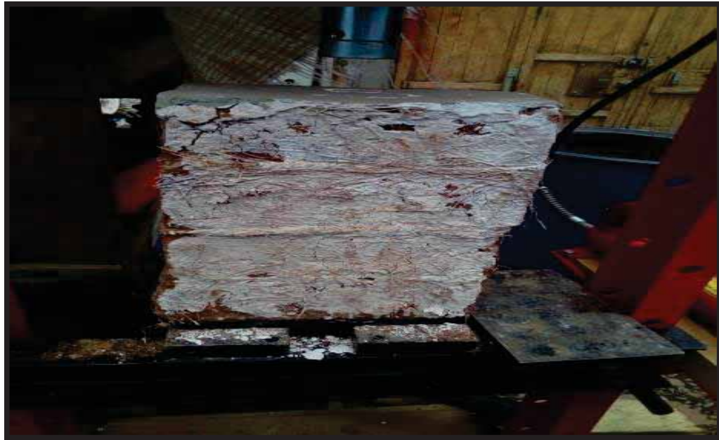
FIGURA 129. PILA DE ADOBE ESTABILIZADO
