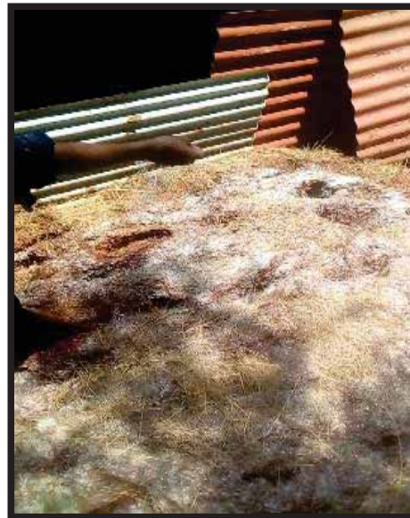
FIGURA 99. MEZCLADO DE TIERRA, PAJA Y AGUA PARA LA ELABORACION DE ADOBES ESTABILIZADOS CON PLASTICO PICADO DE BOTELLAS
