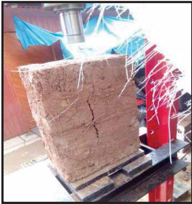
FIGURA 130. FALLA DE LA PILA
