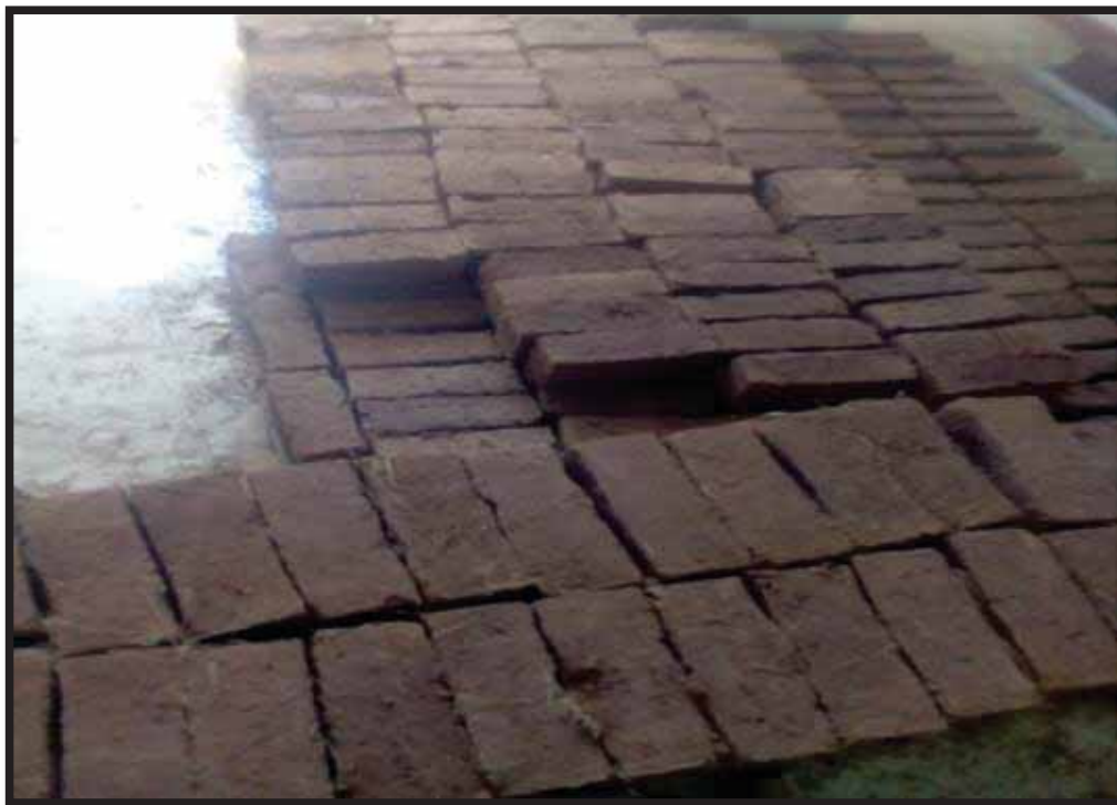
FIGURA 110. ACOPIO DE UNIDADES DE ADOBES
