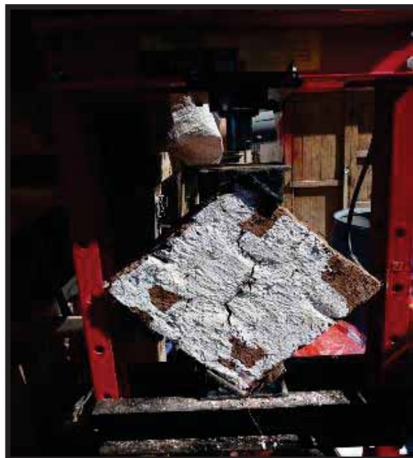
FIGURA 137. FALLA DE MURETE
