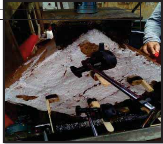
RA 133. DIALES COLOCADOS EN LOS TACOS DE MADERA PARA DETERMINAR DEFORMACIONES
