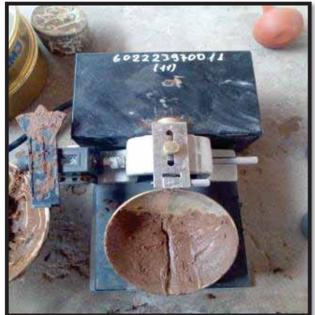
FIGURA 87. MARCADOR EN 22 GOLPES DE LA MAQUINA DE CASAGRANDE DESPUES DEL ENSAYO DE LIMITE LIQUIDO
