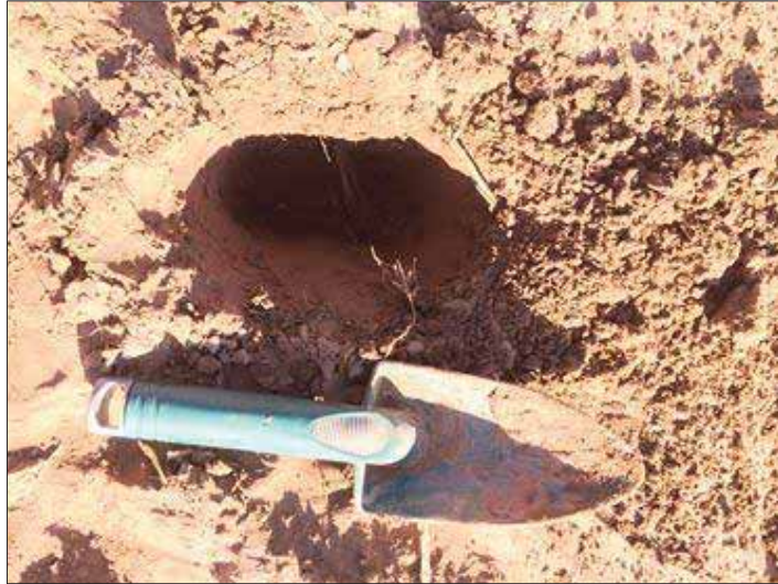
Fotografía N° 07.- hoyo listo para la extracción de muestra.
