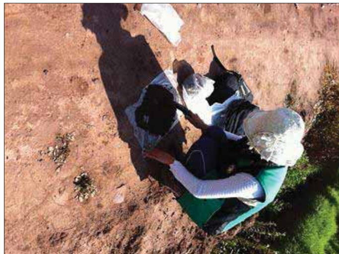
Fotografía N°09.- Mezcla y separación de la muestra representativa.
