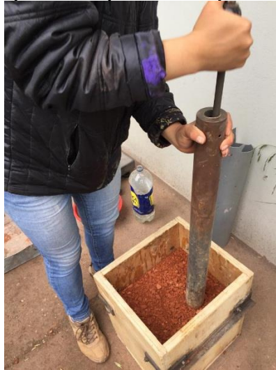
Fotografía 30: Compactación para el ensayo de módulo de reacción
