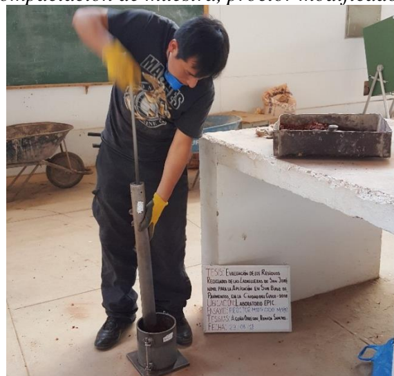
Fotografía 10: Compactación de muestra, proctor modificado (56 Golpes)
