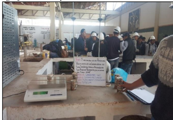
Fotografía 9: Ensayo de contenido de humedad
