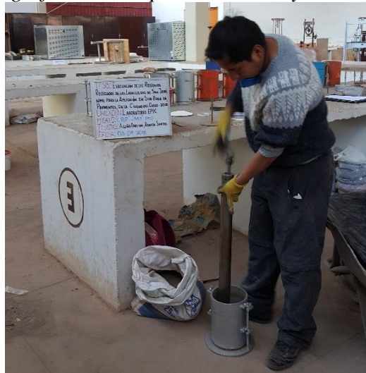
Fotografía 12: Compactación, ensayo CBR
