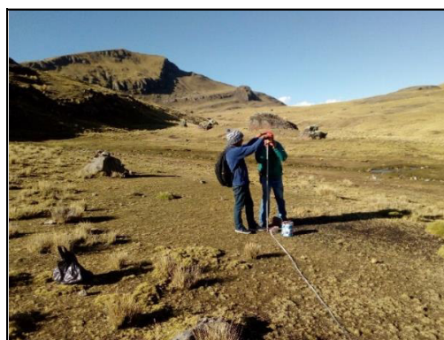
Fot. 4. Control de línea de gradiente con eclímetro, jalones y wincha en la ruta elegida N° 1.
