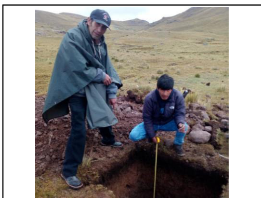
Fot. 9. Medición de la profundidad de excavación de la calicata.
