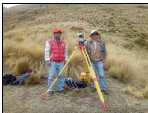
Foto 6. Continuación del levantamiento topográfico con Estación Total Leica, estacionado en el punto de cambio PC 1189.
