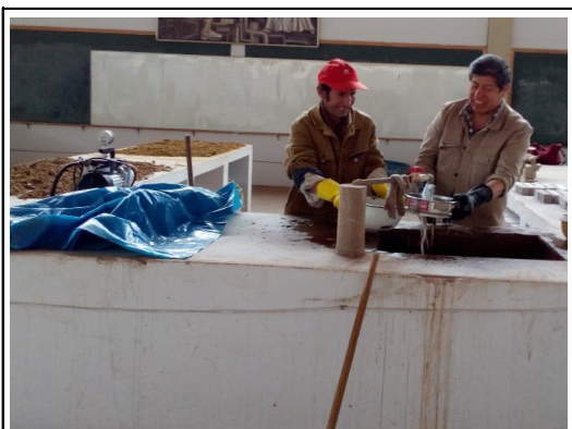
Foto 13. Lavado de la muestra de suelo con tamiz N° 200.
