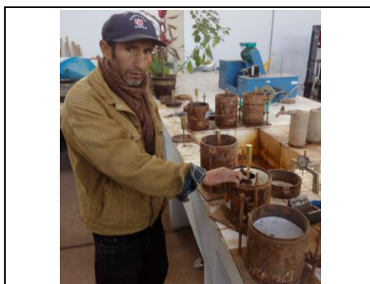
Foto 16. Colocación de los anillos para el ensayo CBR.
