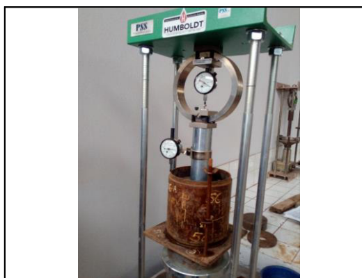
Foto 18. Ensayo de penetración con la máquina Humboldt.
