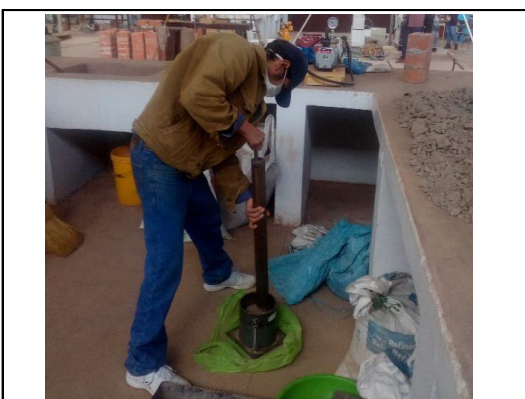
Foto 15. Ensayo de Compactación Proctor Modificado de la muestra de suelo.
