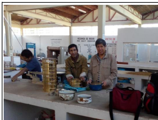
Foto 14. Zarandeo de la muestra de suelo en los tamices normados.
