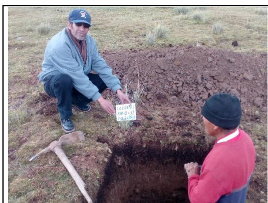
Foto 7. Excavación de la calicata N° 1 en el Km 0 + 32.
