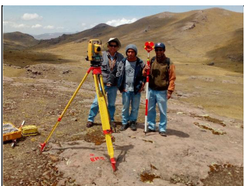
Foto 5. Inicio de los trabajos de levantamiento topográfico con Estación Total Leica, estacionado en el punto de Referencia BM 2.
