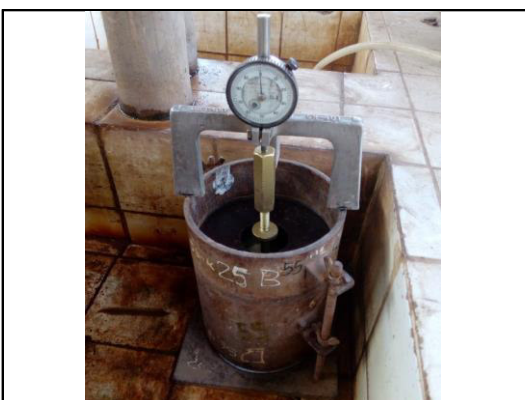
Foto 17. Colocación de manómetro para la lectura inicial de expansión en el molde de 25 golpes para el ensayo de CBR.
