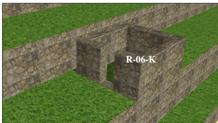
Imagen N° 44: Representación gráfica del recinto 06-K, donde uno de sus muros laterales forma parte del muro de contención. Elaboración propia.
