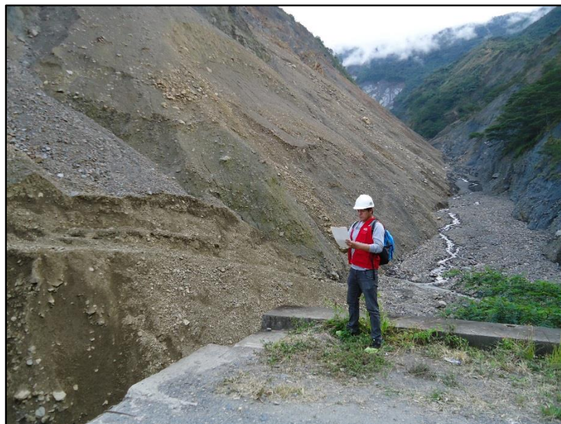
Foto N° 3. Se aprecia los depósitos de los deslizamientos en el Km 12+040. Sector Puentemayo. (W. Atauchí R. / A. Hacha S.)
