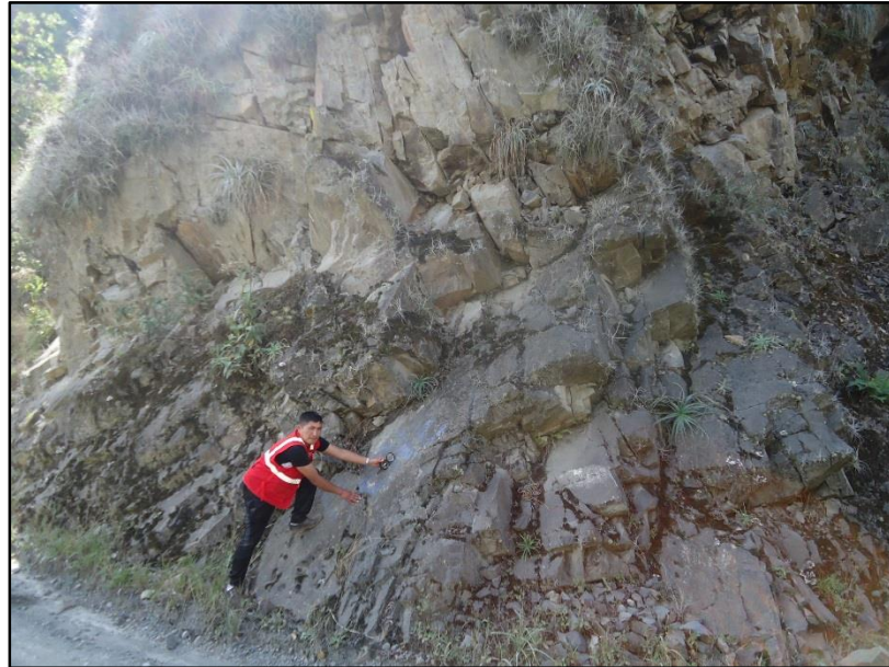
Foto N° 4. Afloramiento rocoso del Grupo San José, midiendo la dirección y el buzamiento del afloramiento. (W. Atauchí R. / A. Hacha S.)
