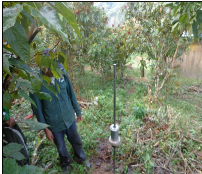
Foto N° 12. Ensayo DPL, en Km 7+460. (W. Atauchí R. / A. Hacha S.)
