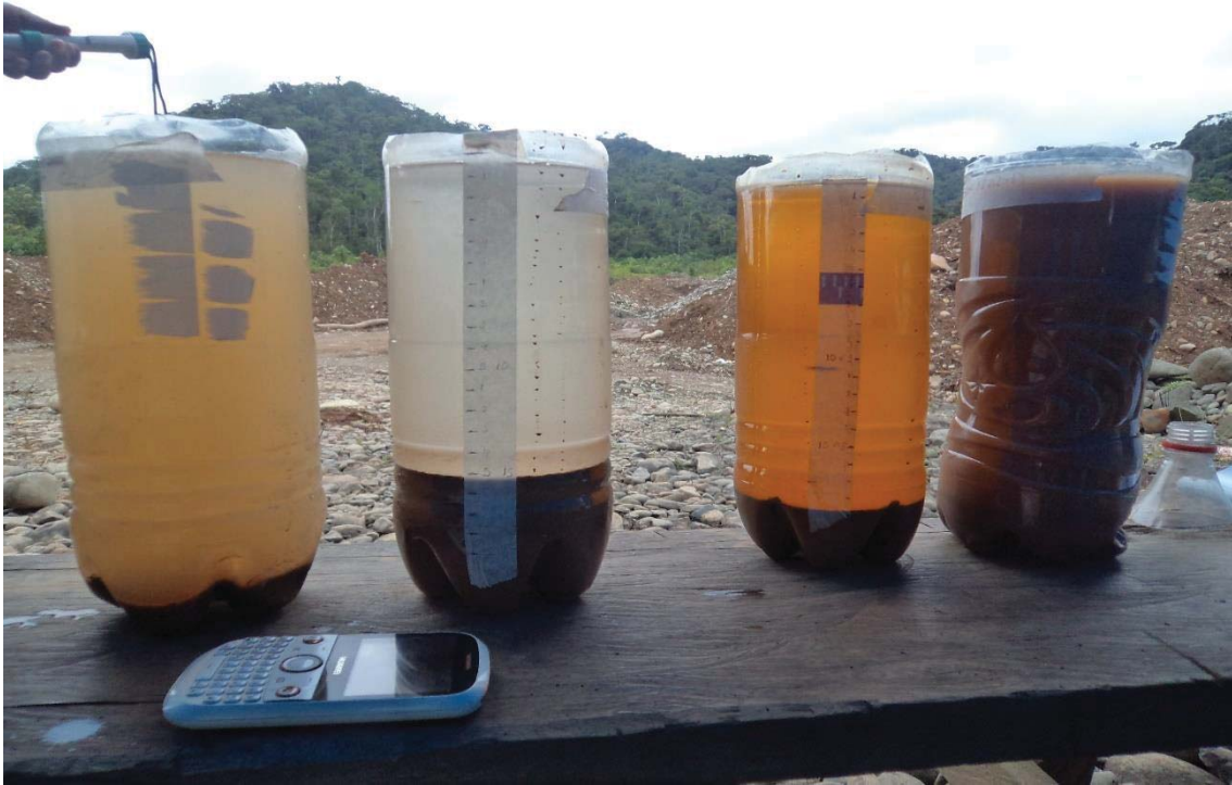
Figura 34 Pruebas de Coagulación - Floculación insitu
