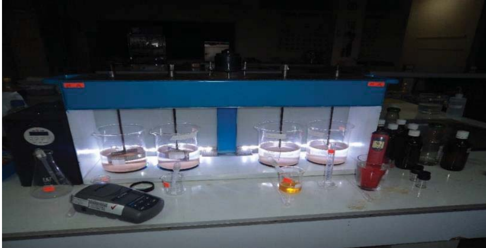
Figura 19 Agitador mecánico construido
