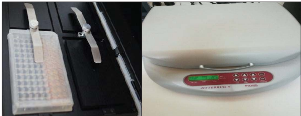
Figura 10. Incubación de la placa perfectamente sellada para evitar la evaporación a 37 °C ( \pm 2 °C) durante 60 minutos ( \pm 5 minutos)
