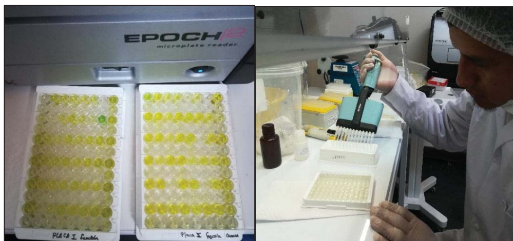
Figura 13. Se agregó 50 \mu l de la solución frenado en cada pocillo para detener la reacción y medir la absorbancia a 450 nm
