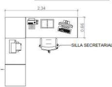
ESC 1:40 [MODULO DE RECEPCION POR PISO - VISTA PLANTA]
