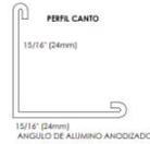
**DETALLE 14-F [FIJACION DE CIELO RASO SUSPENDIDO]**
