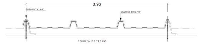
**DETALLE C [CORTE FIJACION DE PANELES]**
