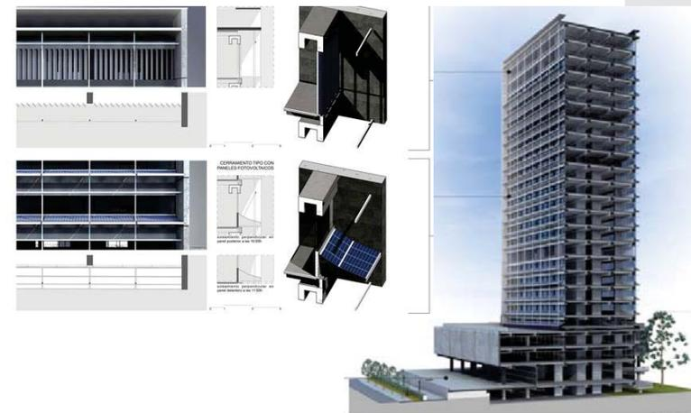
En lo alto del edificio se resuelven unos pisos técnicos para el procesamiento de la energía alternativa. La plaza recolecta agua lluvia a través de unos pisos con junta abierta sobre una loza en pendiente, para sanitarios y jardinería, en una cisterna ubicada al nivel -1.50 de los parqueaderos.
