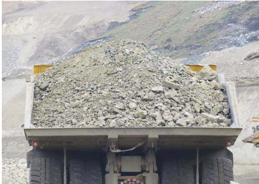
FIGURA N°5.1. Fragmentación línea base con Fortis Advantage Matriz.
