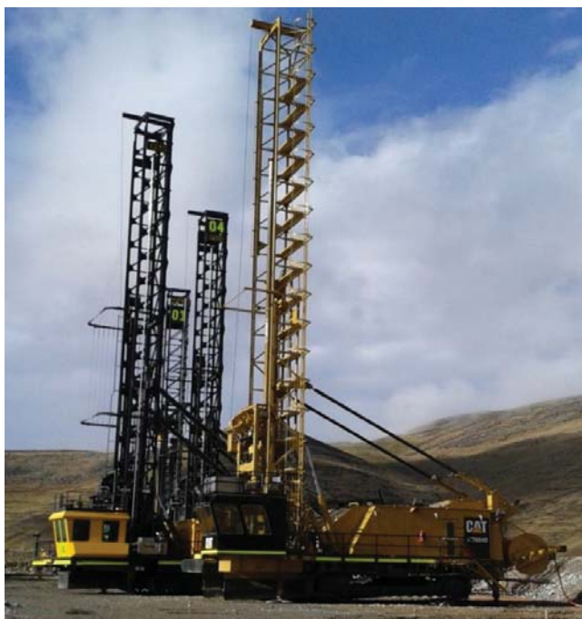
FIGURA N°3.11. Equipos de perforación eléctrica marca P&H 320XPC y CAT 6640 MD.
