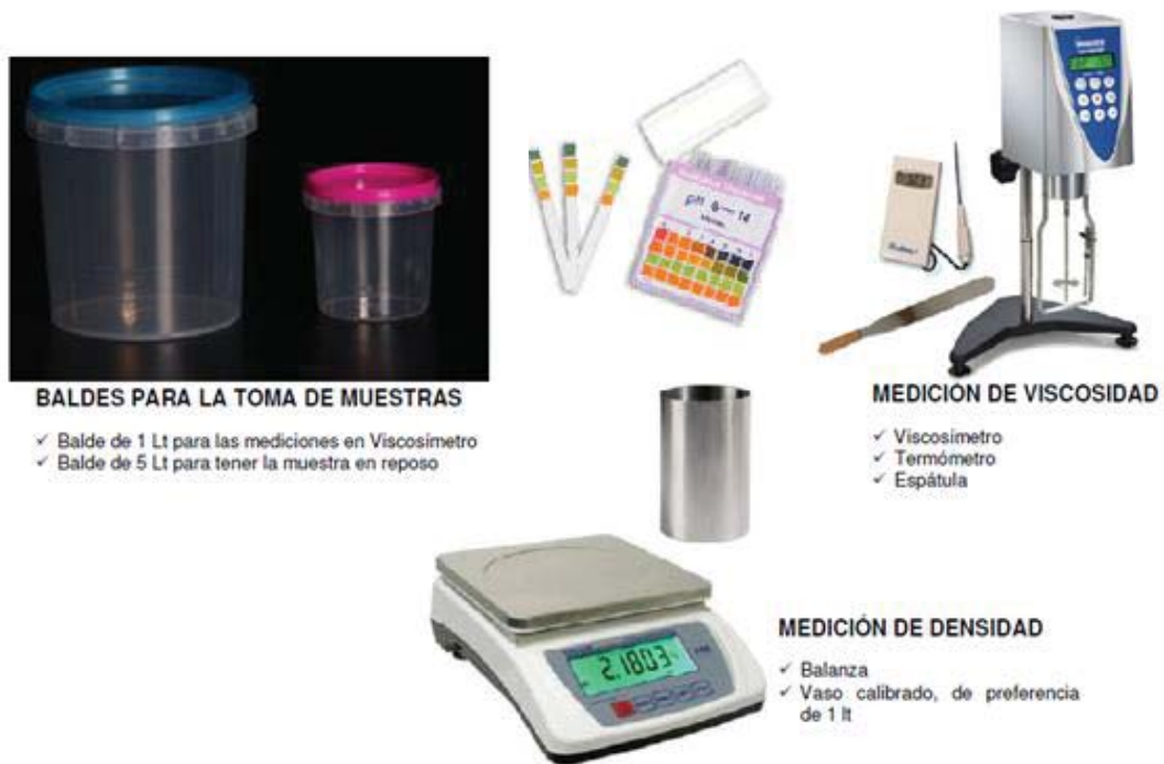
FIGURA N°4.4. Materiales necesarios para la medición de densidad, viscosidad y grado de acides.
