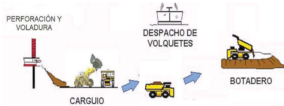
FIGURA N°3.9 Diagrama de flujo en etapa de construcción
