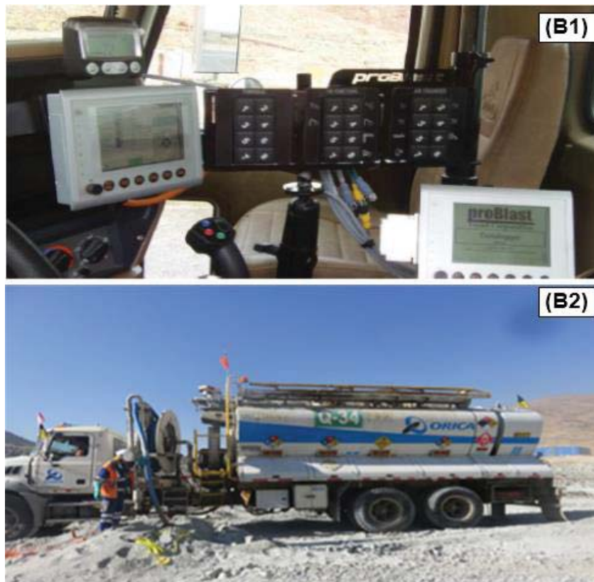
FIGURA N°2.10. Cabina del operador con automatización del software proBlast (B1) y la unidad de fabricación móvil MMU (B2).
