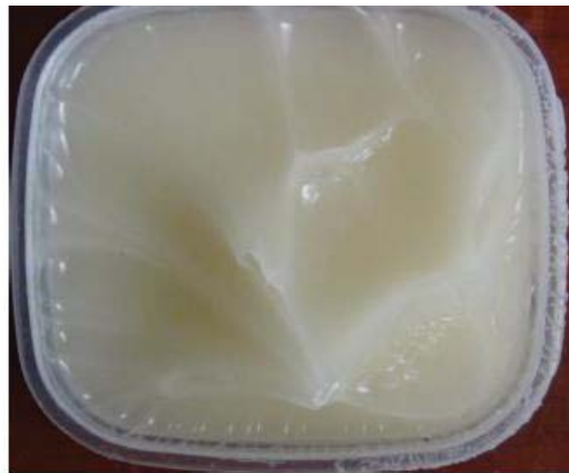
FIGURA N°4.1. Fotografía de Fortis Advantage a base de emulsión matriz.
