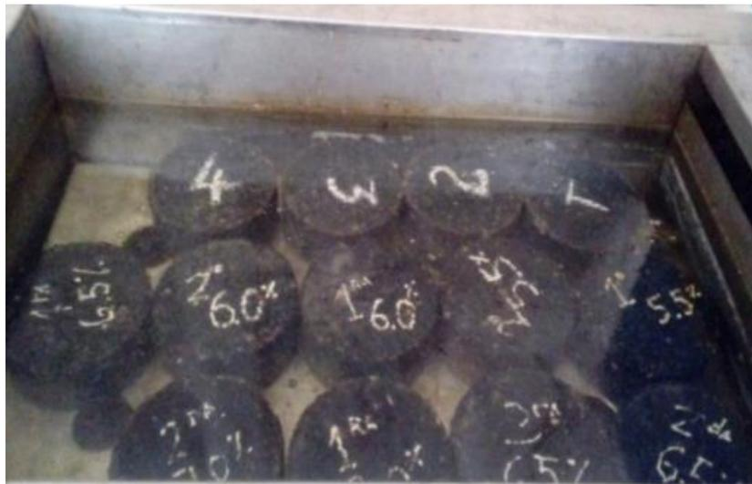
*Figura 19: Baño María de briquetas Marshall a 60°C*
