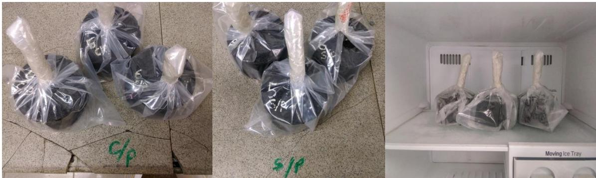
*Figura 42: Colocación de los especímenes a temperar a -18°C*
