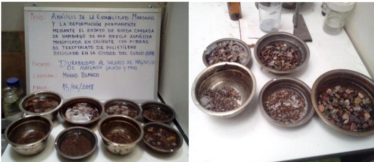
*Figura 69: Material tamizado y lavado inmerso en solución de sulfato de magnesio*
