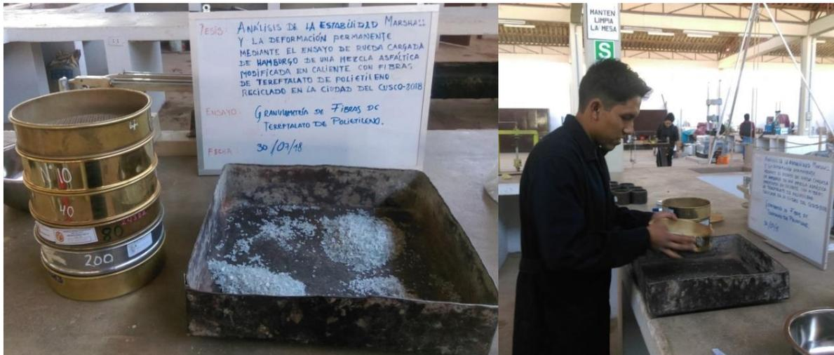
*Figura 13: Ensayo de granulométrico de fibras PET*
