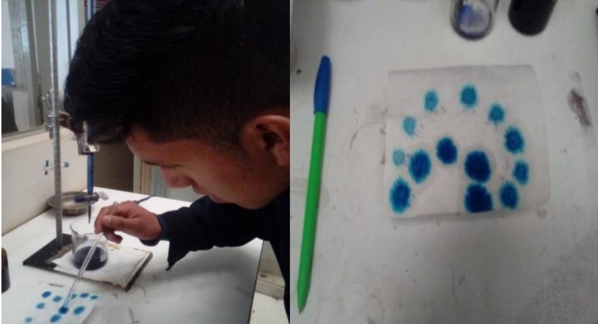
Figura 88: Proceso de ensayo para determinar la aureola azul de la solución empleada
