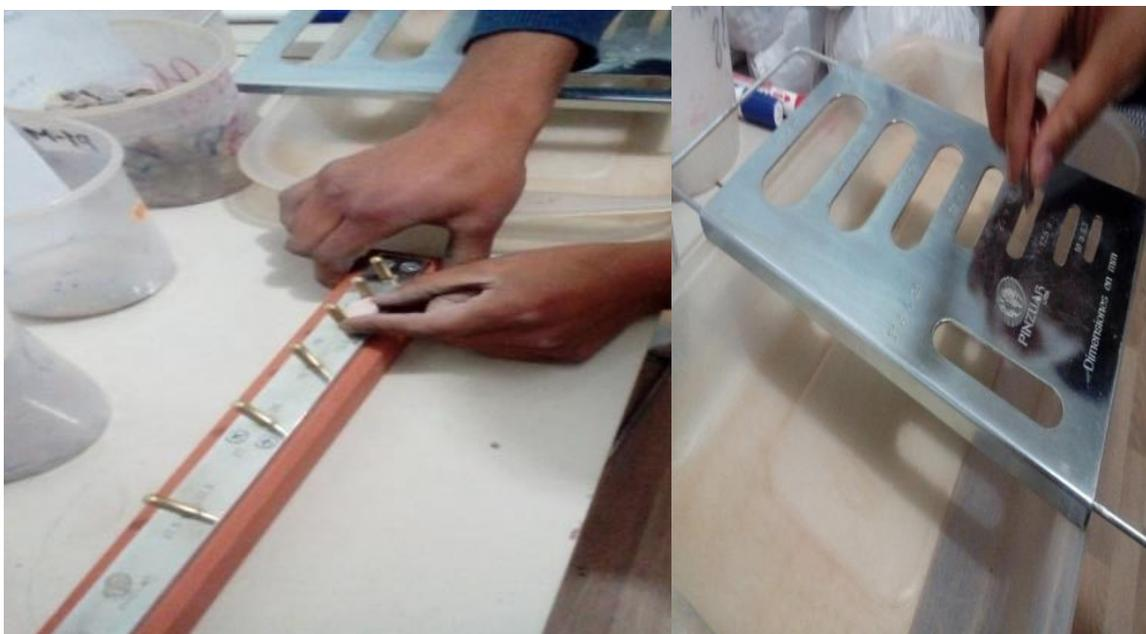
*Figura 77: Caracterización de cada elemento de muestra en el calibrador de partículas chatas y partículas alargadas*
