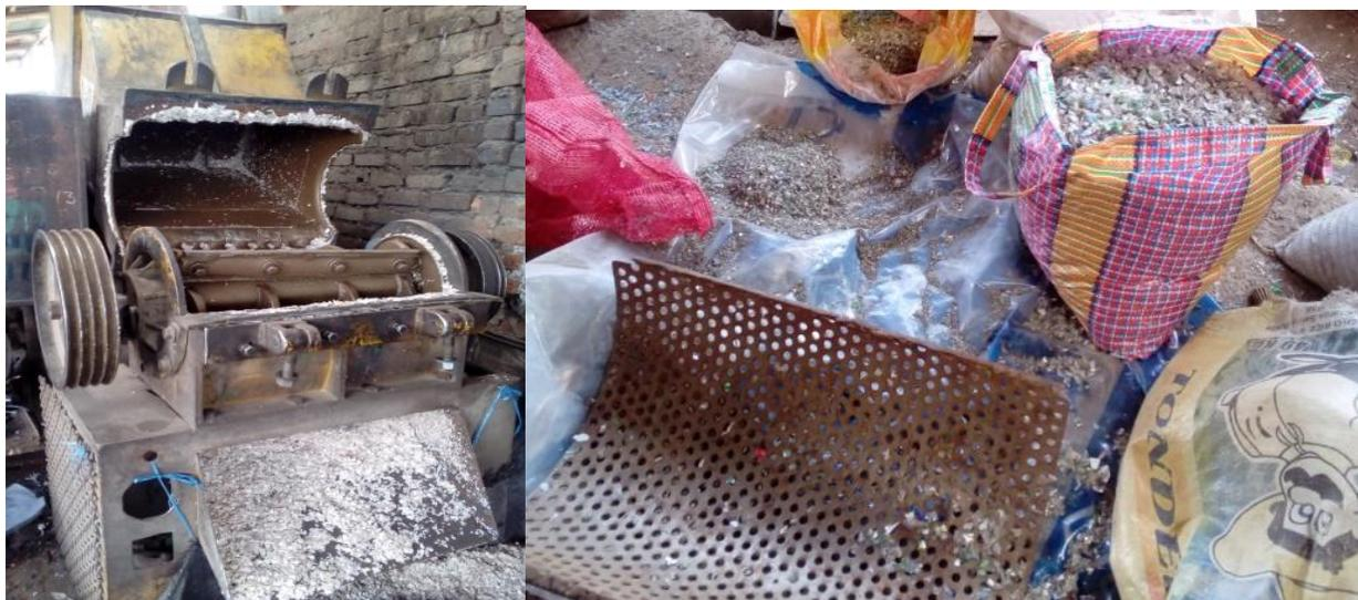
*Figura 12: Máquina picadora de plástico de botella PET y malla interna de picado*
