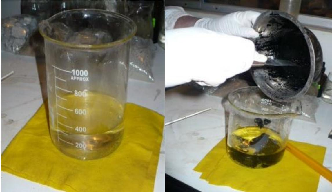
*Figura 80: Vertido de la mezcla en agua destilada*
