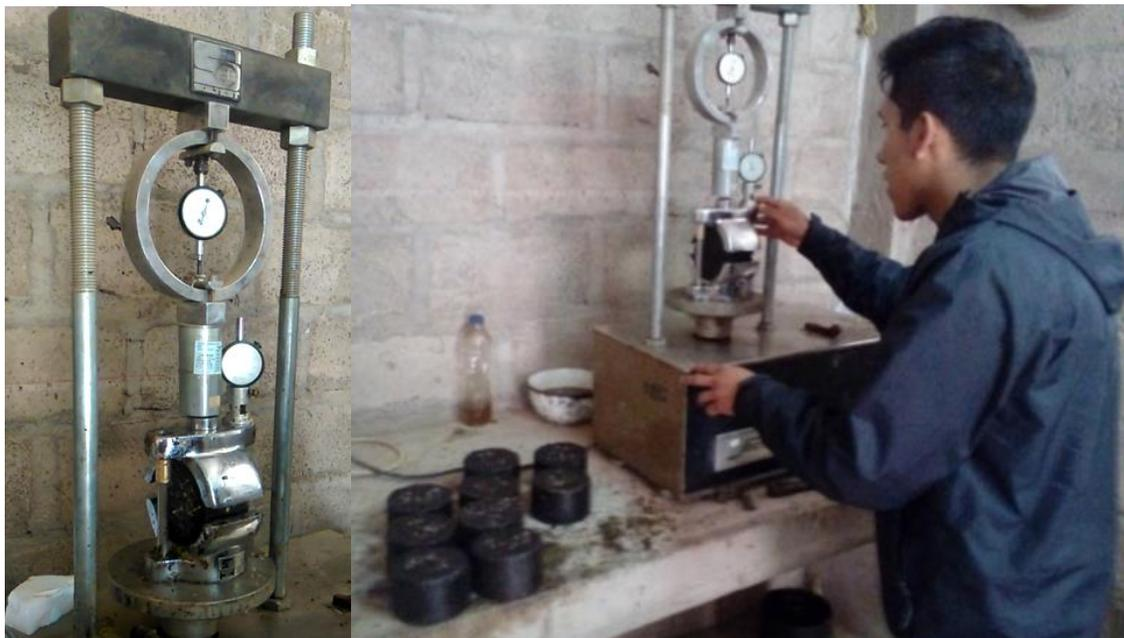
*Figura 20: Rotura de briquetas en la presa Marshall*
