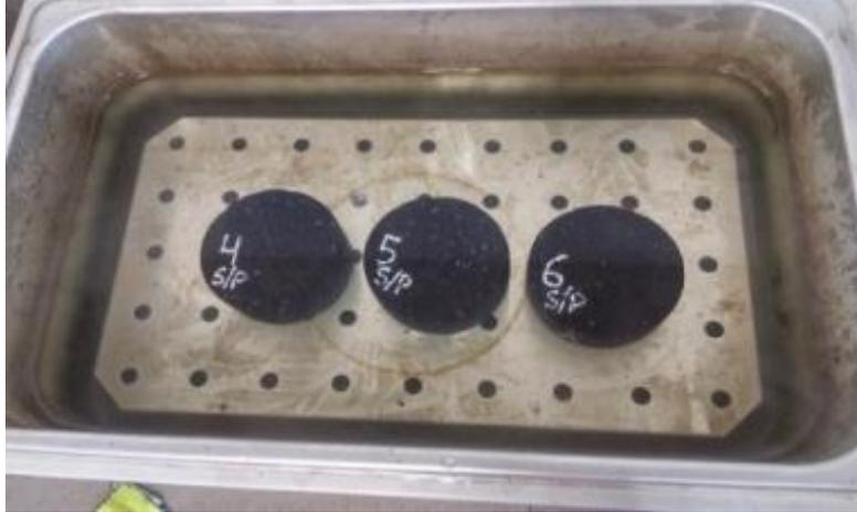
*Figura 43: Especímenes de mezcla asfáltica convencional en baño maría a 60°C*
