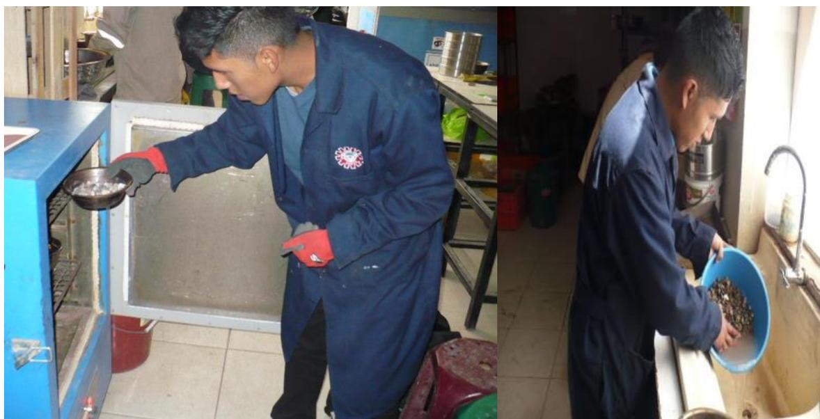
*Figura 67: Lavado y colocado en el horno del material tamizado*
