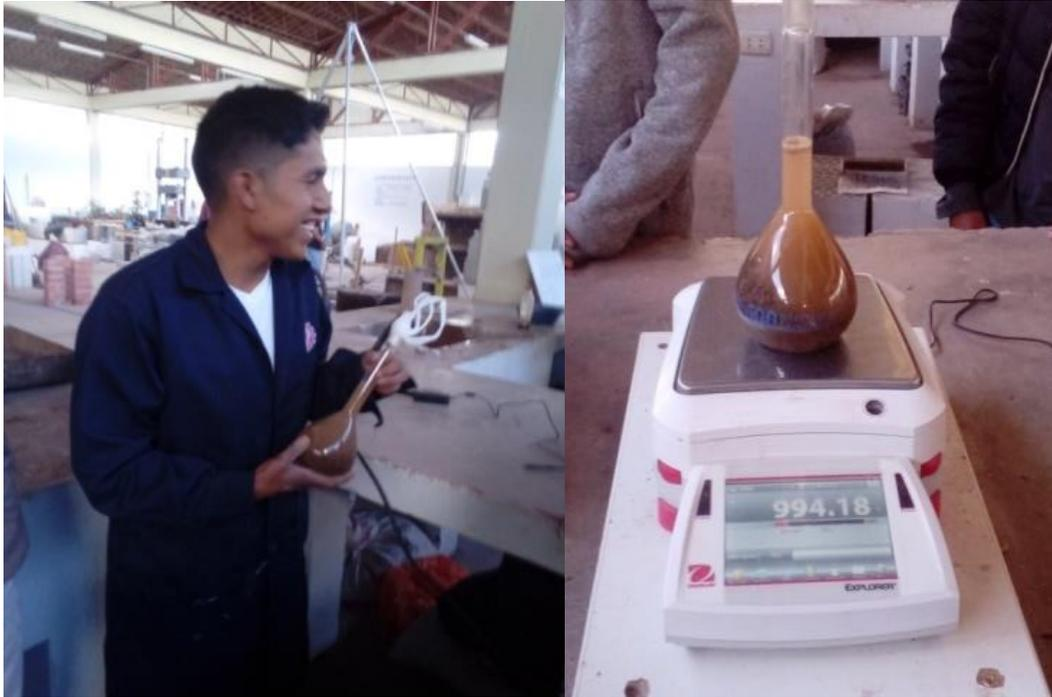
*Figura 94: Extracción de vacíos del matraz con agua y material previamente ingresado*
