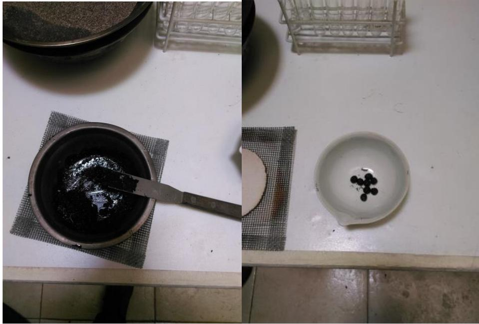
*Figura 100: Preparación de la mezcla de agregado fino con asfalto y formación de esferas de 0.5 gr aproximadamente*
