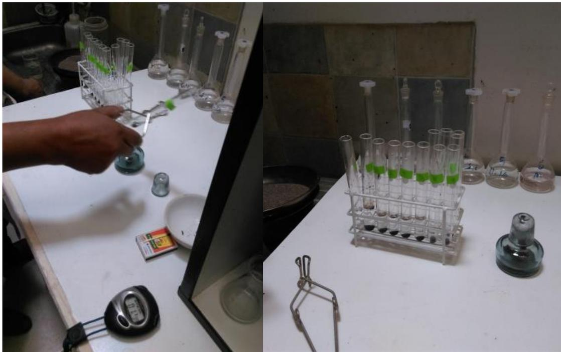
*Figura 101: Ingreso de las esferas formadas en los tubos de ensayo y posterior agitación de los mismos sobre un mechero*
