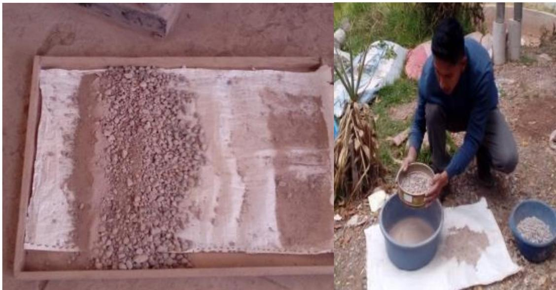
*Figura 57: Material extraído de la máquina y posterior tamizado por la malla N°12*
