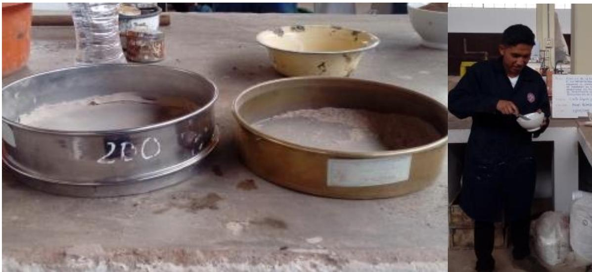
*Figura 64: Tamizado del material fino por la malla N°200*
