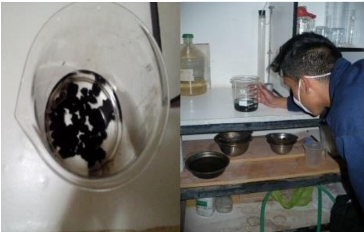
*Figura 81: Control del desprendimiento de la mezcla pasadas 18 horas de inmersión en agua destilada*
