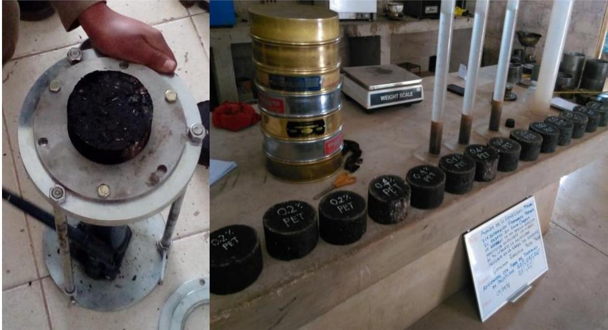
*Figura 24: Probetas desmoldadas de mezcla asfáltica modificada*
