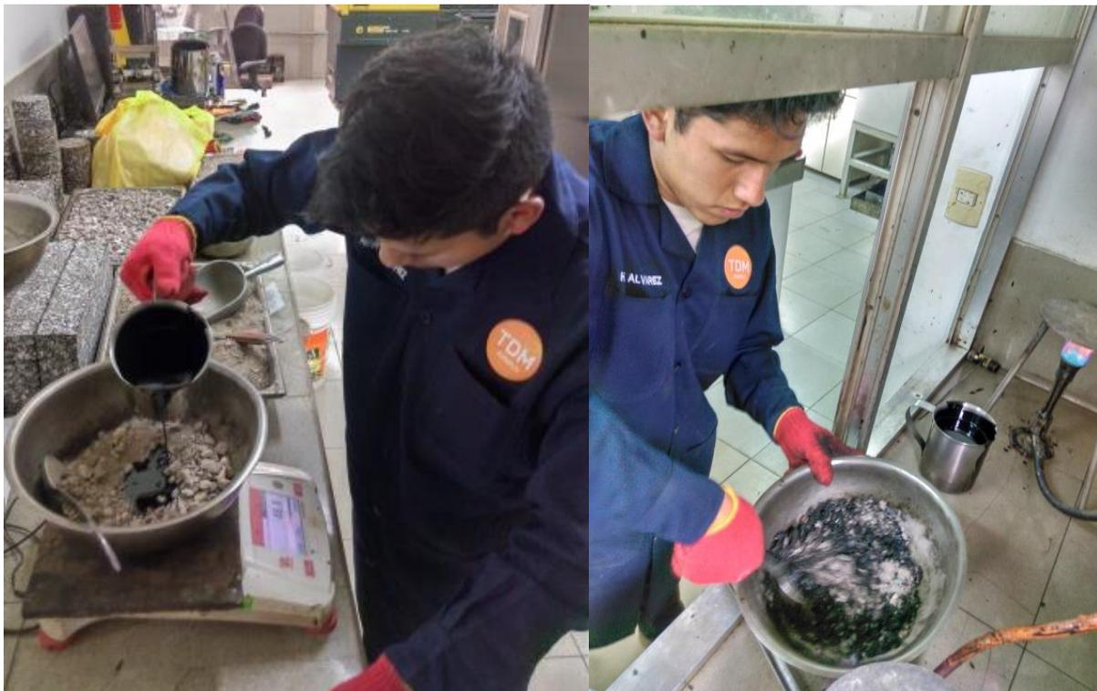
Figura 32: Vertido del ligante asfáltico y mezclado de material
