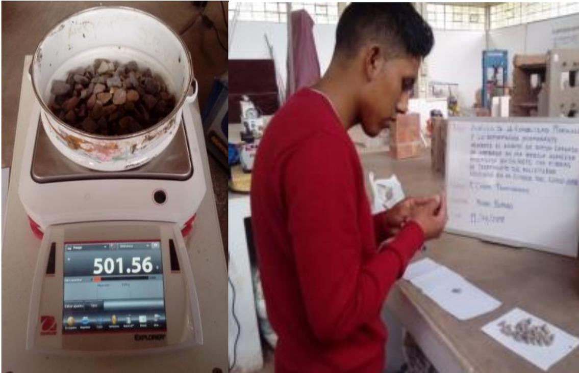
*Figura 58: Material seleccionado para la prueba y posterior caracterización de acuerdo al número de caras fracturadas*
