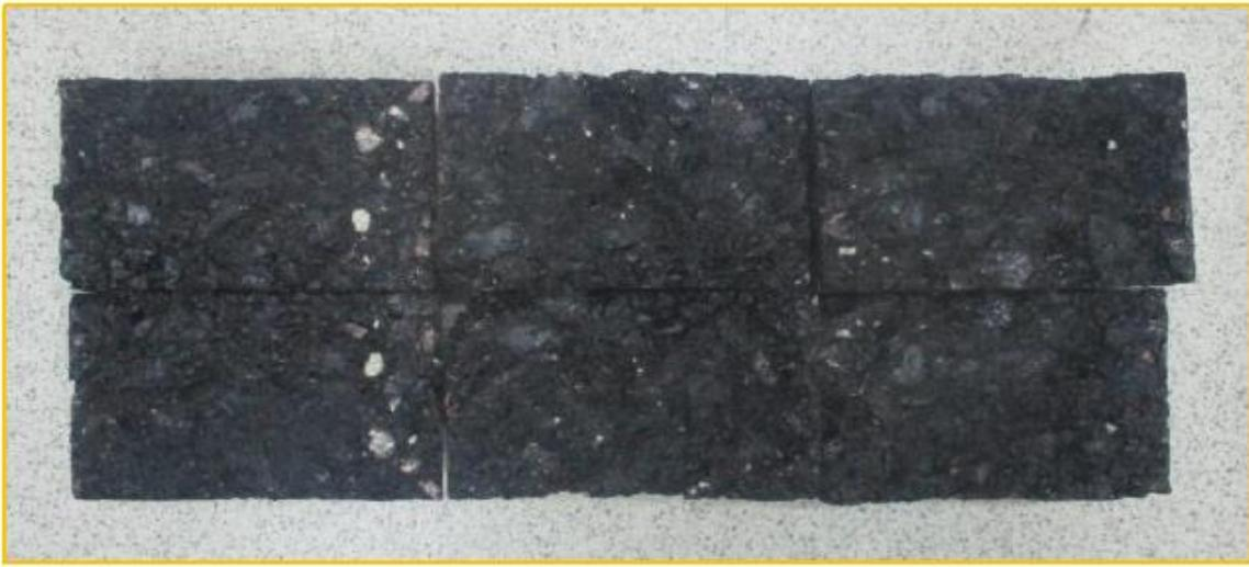
**7. ESPECÍMENES DE ENSAYO DE LA CONDICIÓN HÚMEDA**
