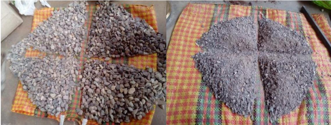
*Figura 54: Cuarteo de agregado grueso y agregado fino*
