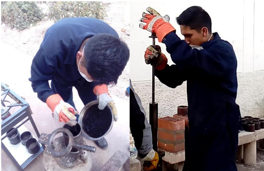
*Figura 16: Compactación mecánica manual de las briquetas Marshall*
