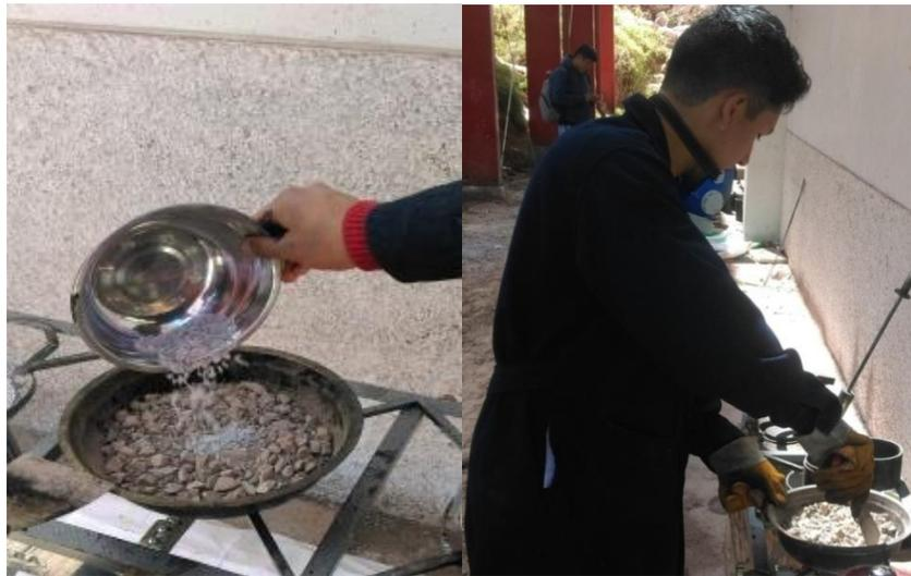
Figura 22: Colocación de fibras PET como sustitución de agregado fino
