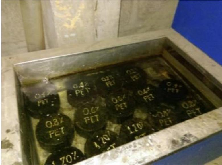
*Figura 26: Baño María a 60°C de las probetas de mezcla modificada*
