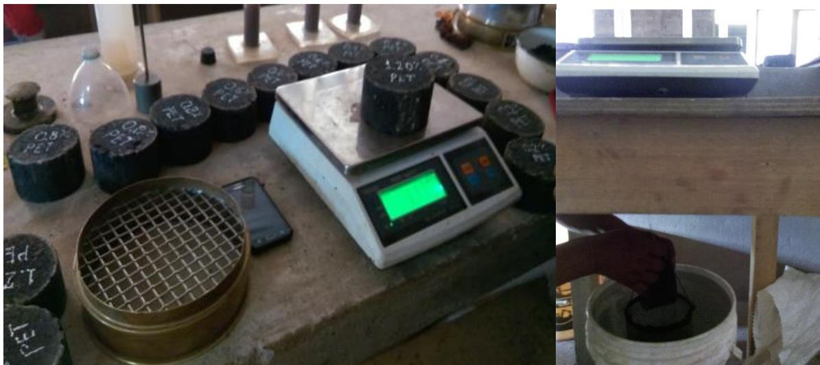
*Figura 25: Determinación del peso específico de las probetas de mezcla asfáltica modificada*
