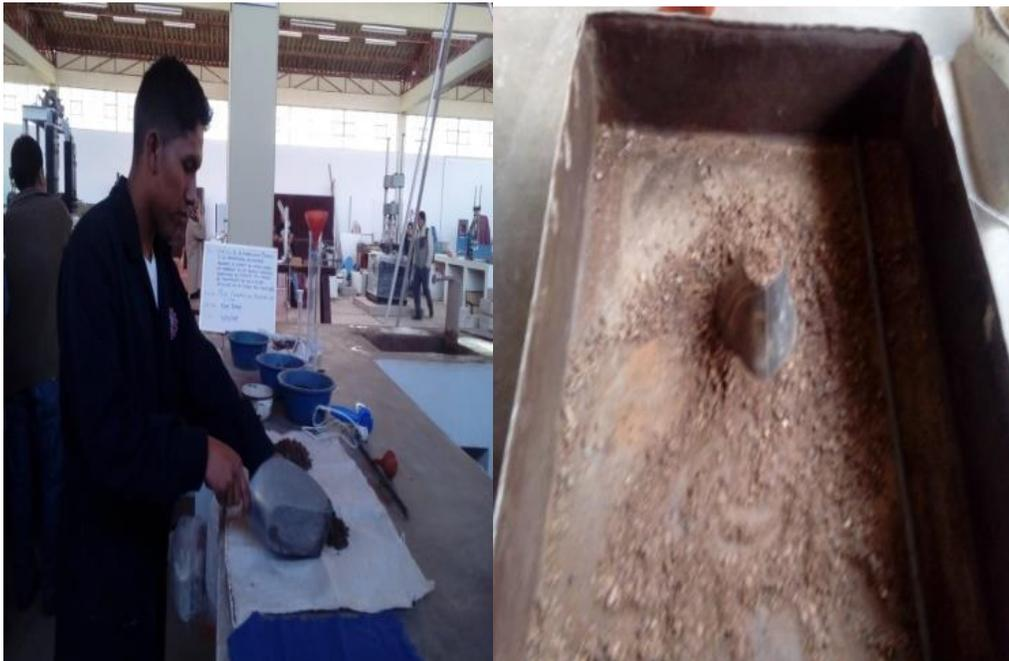
*Figura 93: Determinación del material con superficie seca saturada*
