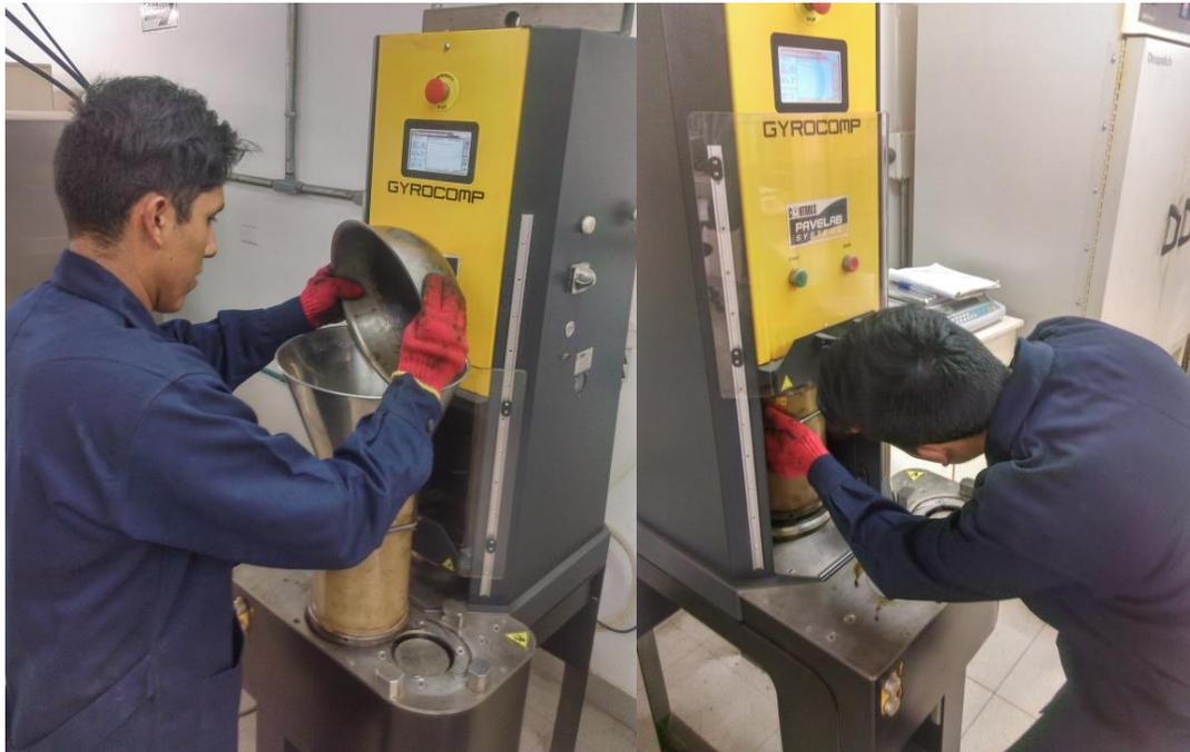
*Figura 33: Colocación de la mezcla asfáltica dentro del molde de Compactación Giratorio Superpave*
