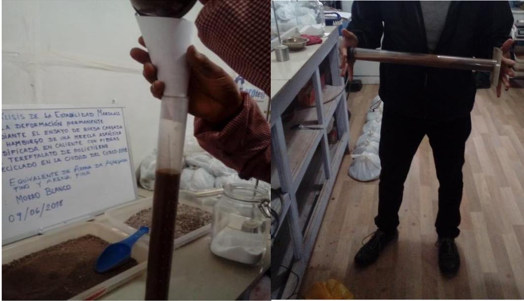
Figura 84: Ingreso del material y posterior agitación manual de la probeta de ensayos con solución stock
