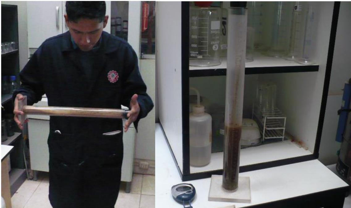
*Figura 91: Agitamiento manual del material y asentado por el periodo de tiempo establecido*
