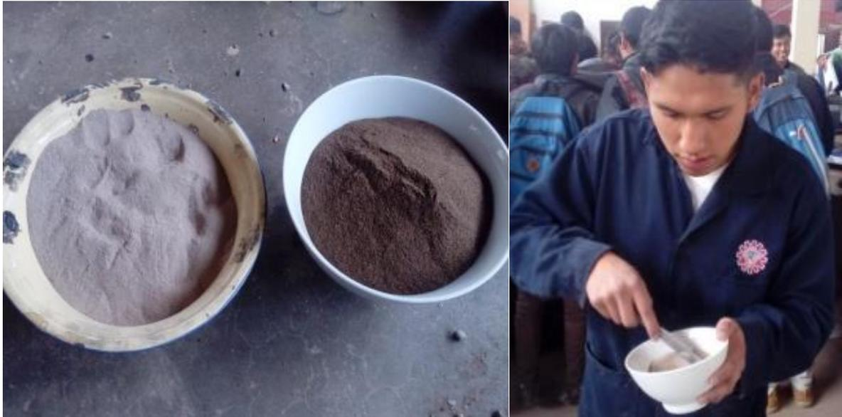
*Figura 62: Material tamizado por la malla N°40 y posterior mezclado con agua*
