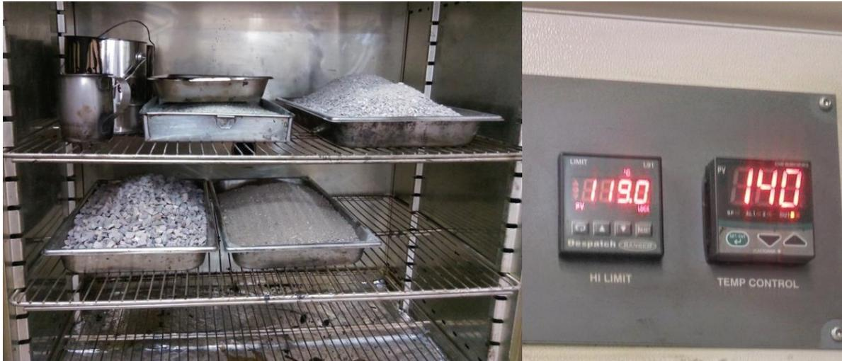
*Figura 29: Calentamiento de los agregados, PET y el ligante asfáltico PEN 120/150 a temperatura controlada en horno de convección forzada*
