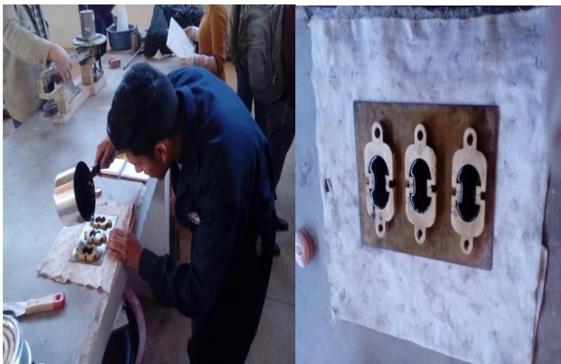
*Figura 105: Vertimiento del ligante asfáltico PEN120/150 en los moldes de ensayo*
