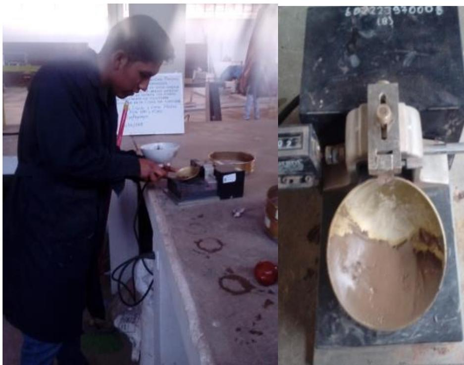
*Figura 65: Colocado del material mezclado con agua en la cuchara Casagrande*
