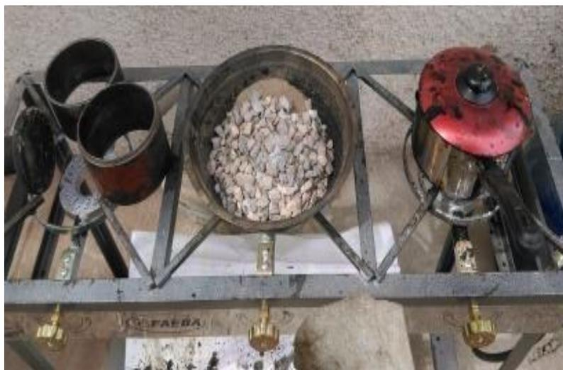
*Figura 14: Calentamiento de los componentes de mezcla asfáltica y de moldes Marshall*
