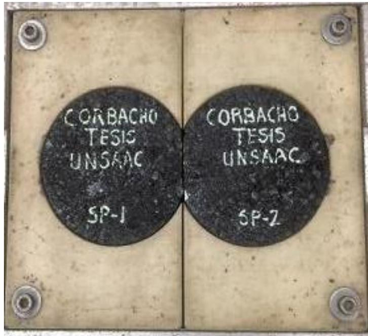
*Figura 35: Doble núcleo del cuerpo de prueba de mezcla asfáltica convencional*
