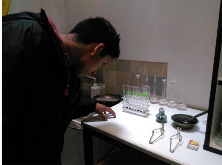
*Figura 102: Se observa si existiese algún desprendimiento en las esferas luego del proceso de agitación*
