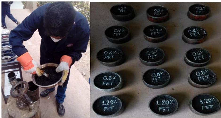
Figura 23: Probetas de mezcla asfáltica modificada
