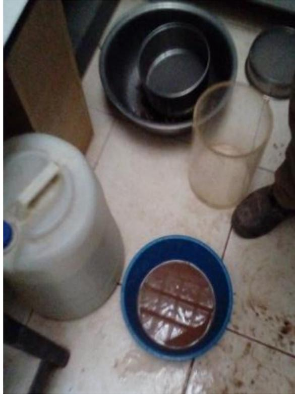
Figura 74: Material pasante la malla N°200 después del proceso de agitación
