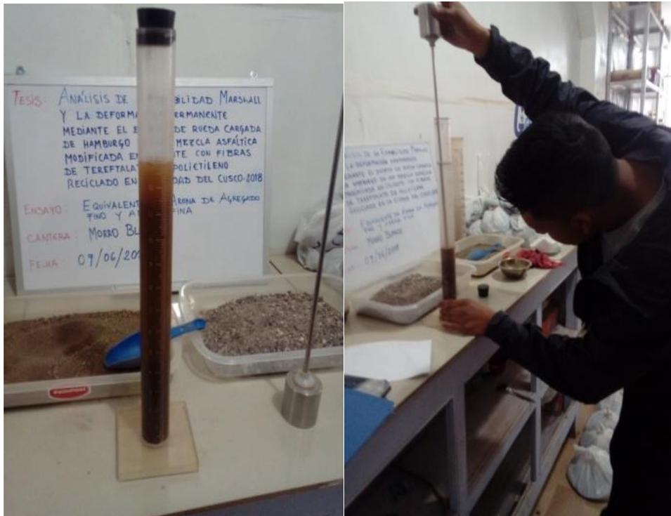
Figura 85: Asentado del material y medición correspondiente del ensayo
