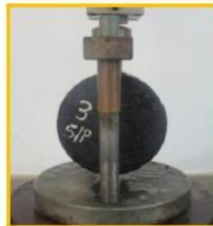
**5. ENSAYO DE ESPECIMENES EN CONDICIÓN HÚMEDA**
