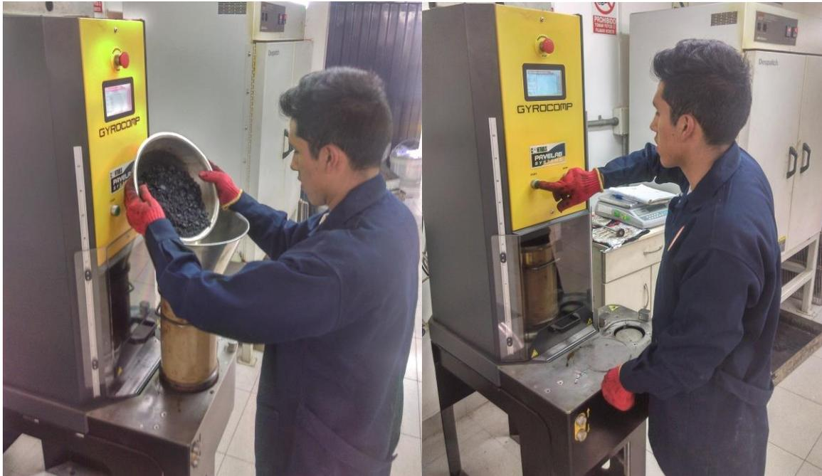
*Figura 39: Colocación de mezcla asfáltica dentro del molde de compactación*
