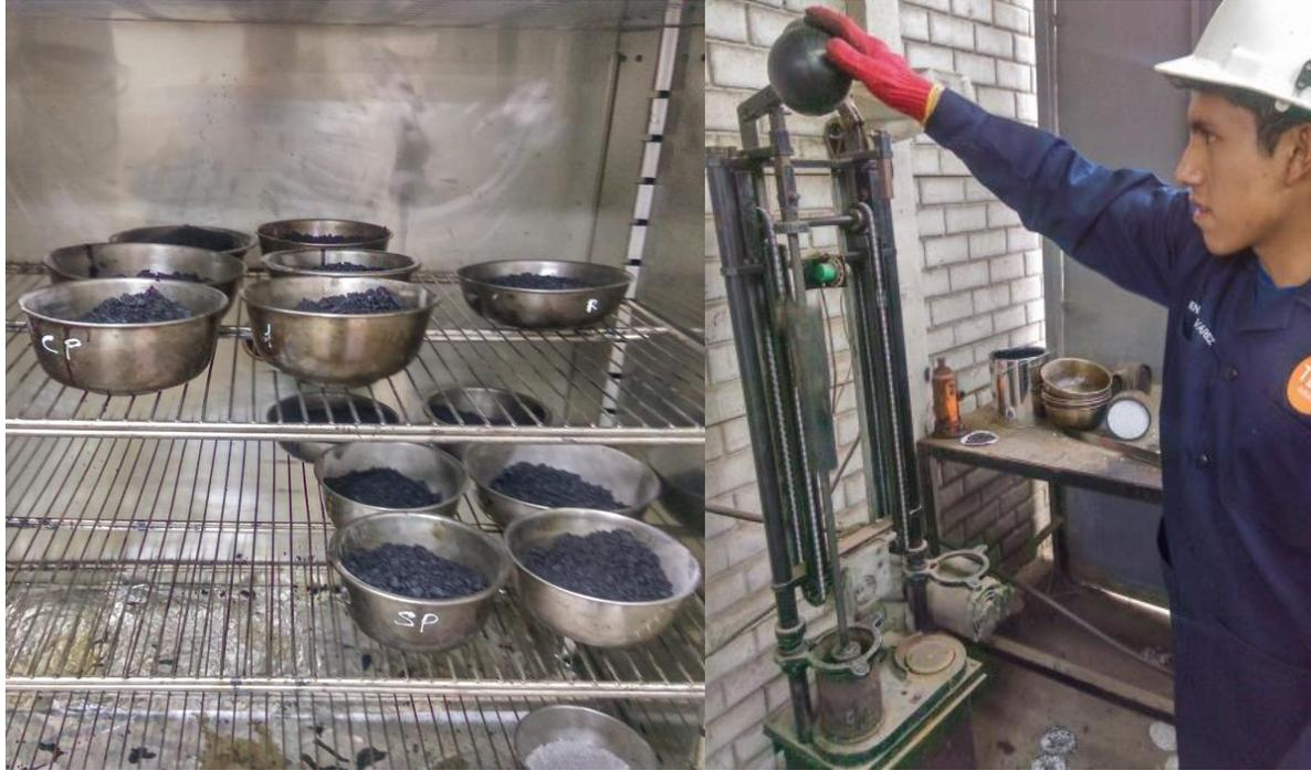
*Figura 46: Compactación de especímenes en el compactador electromecánico Marshall*
