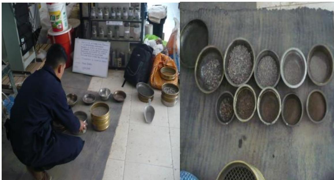
*Figura 66: Tamizado del material para ensayo de durabilidad al sulfato de magnesio*
