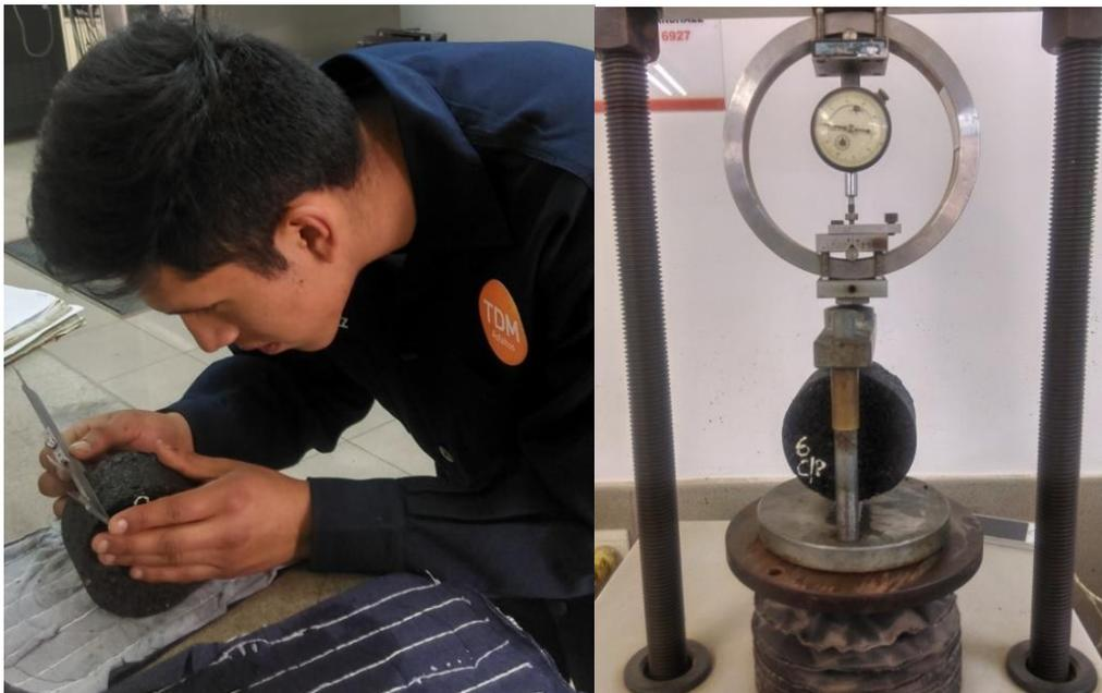
*Figura 45: Rotura a tracción indirecta de los especímenes*
