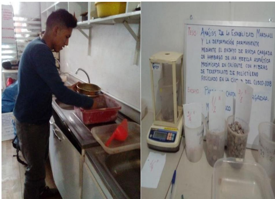
*Figura 76: Tamizado del material por las mallas correspondientes*
