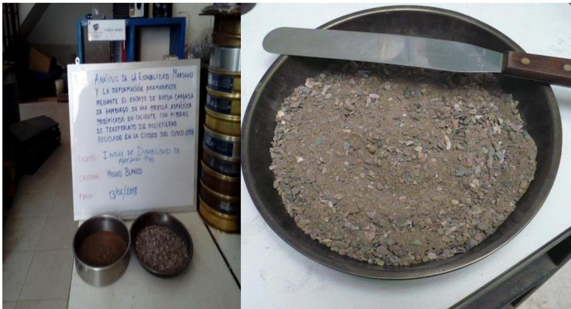
Figura 89: Tamizado del material para el ensayo de índice de durabilidad de agregado fino
