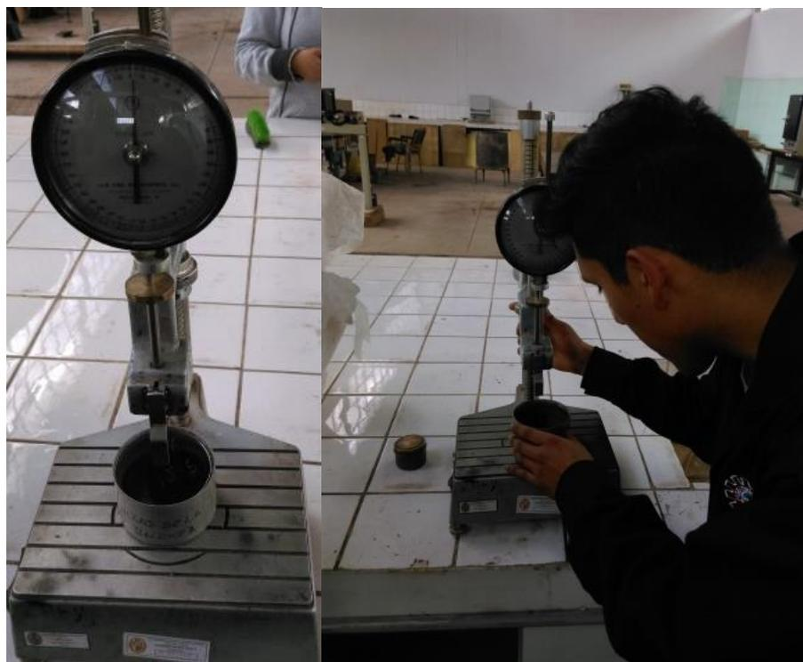
*Figura 104: Colocación del envase lleno de asfalto a temperatura de agua 25°C*
