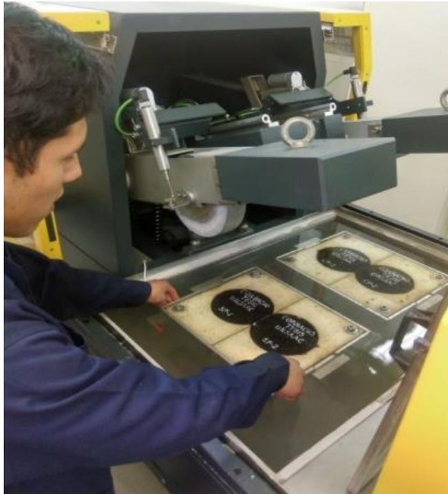
*Figura 37: Colocación de los cuerpos de prueba dentro de la máquina de Rueda Cargada de Hamburgo*
