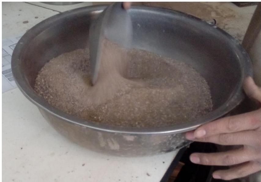
*Figura 95: Material tamizado para ensayo de angular de agregado fino*
