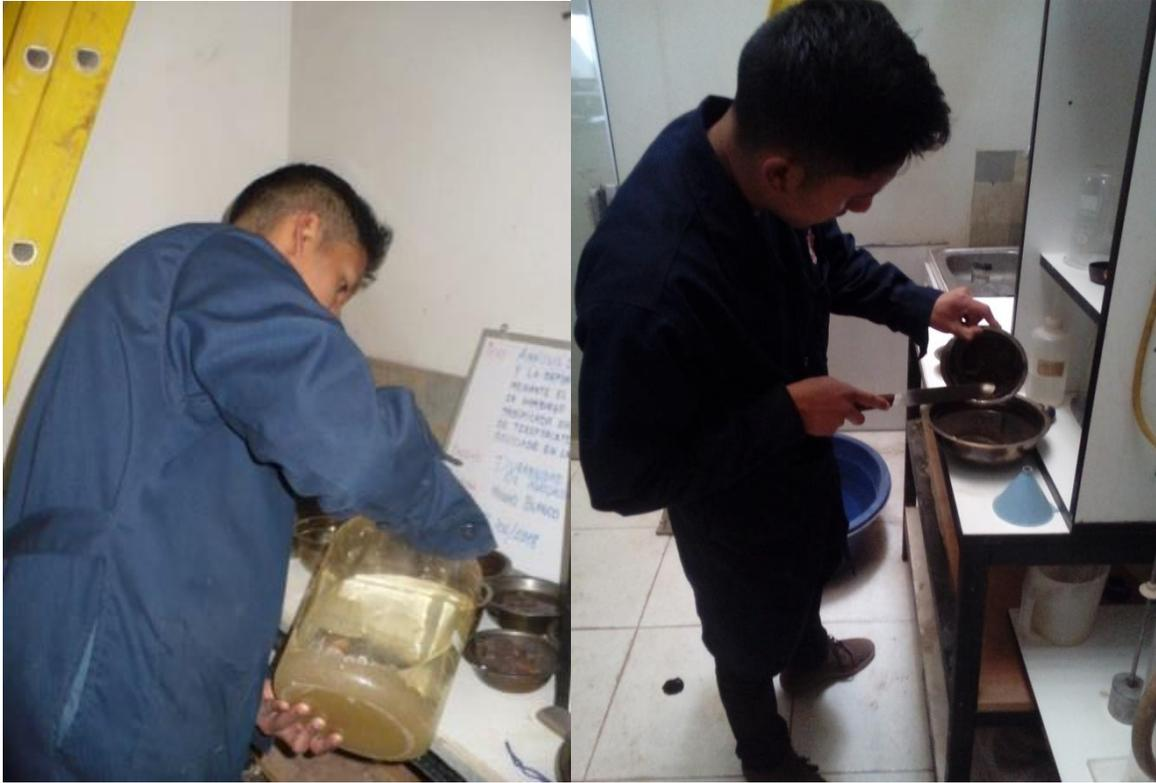
*Figura 68: Vertimiento de la solución de sulfato de magnesio*
