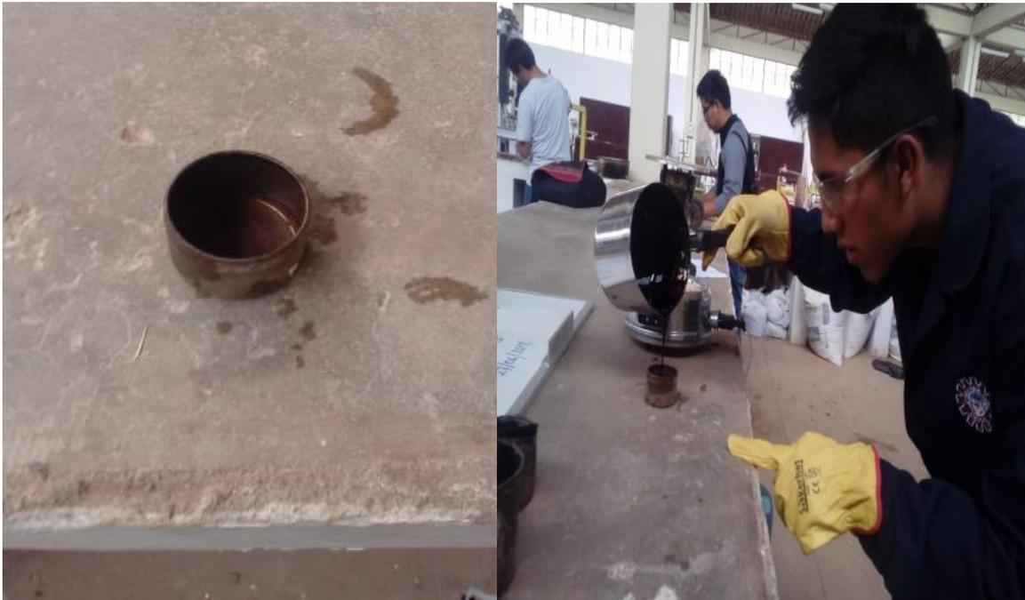
*Figura 103: Envase utilizado y posterior vertimiento del ligante asfáltico PEN 120/150*
