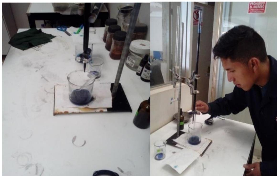
*Figura 87: Mezcla del material seleccionado con la solución de azul de metileno*
