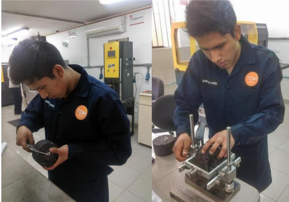
*Figura 50: Colación de los apoyos de en el molde de ensayo de Modulo de Resiliencia*
