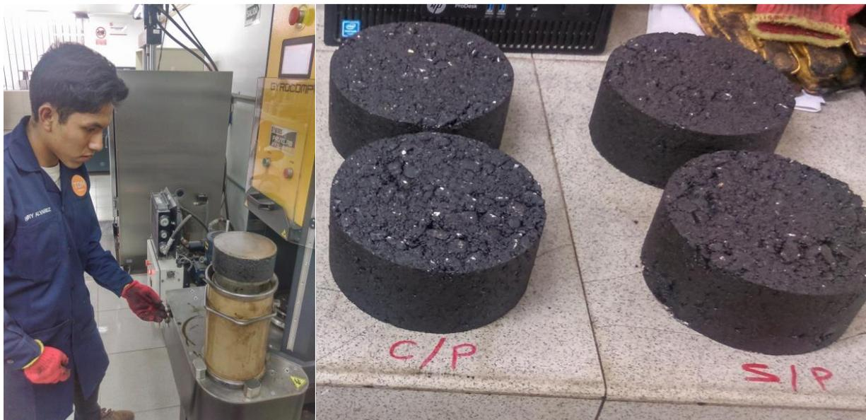
*Figura 34: Extracción de moldes del Compactador Giratorio Superpave*
