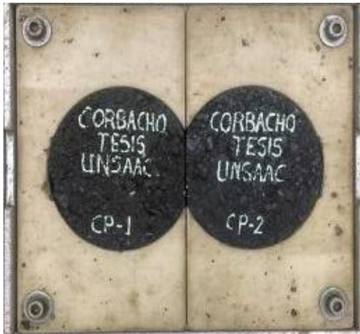
*Figura 36: Doble núcleo del cuerpo de prueba de mezcla asfáltica modificada*
