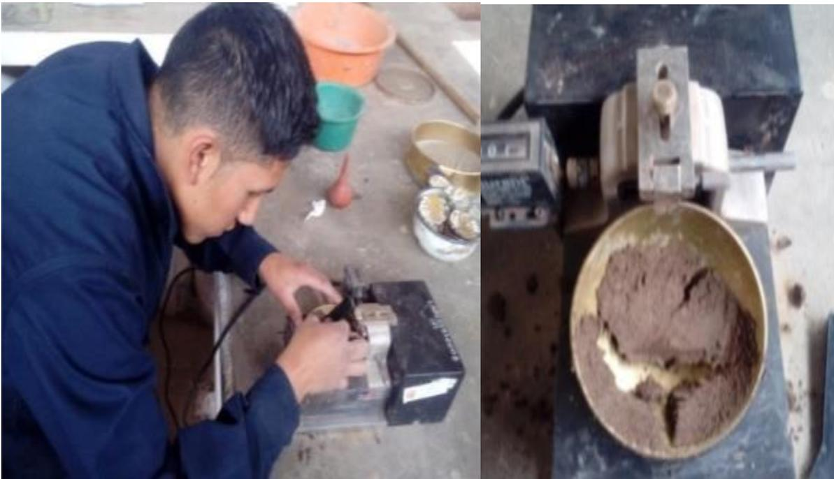
*Figura 63: Colocado y ensayo de la prueba en la cuchara de Casagrande*
