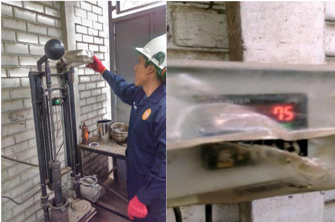
*Figura 47: Programación de 75 golpes a compactar-Método Marshall*
