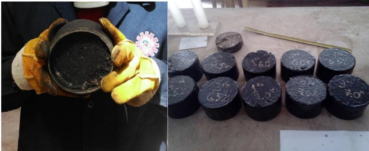
*Figura 17: Producción de briquetas Marshall convencional*
