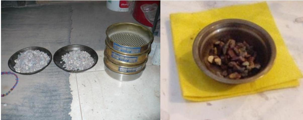
*Figura 78: Material tamizado para prueba de adherencia de agregado grueso*
