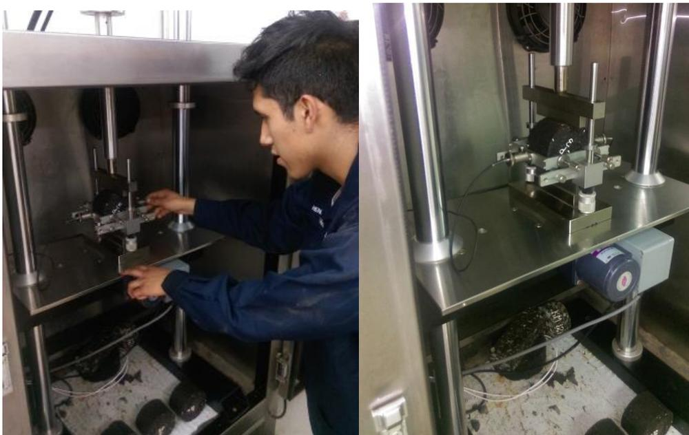
*Figura 51: Colocación del molde con el espécimen dentro de la máquina universal*
