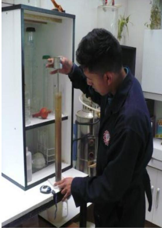
*Figura 92: Medición del ensayo para determinar la altura de asentado del material*
