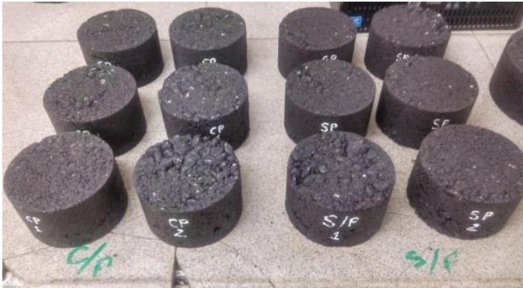
*Figura 40: Especímenes de mezcla asfáltica convencional y mezcla modificada*
