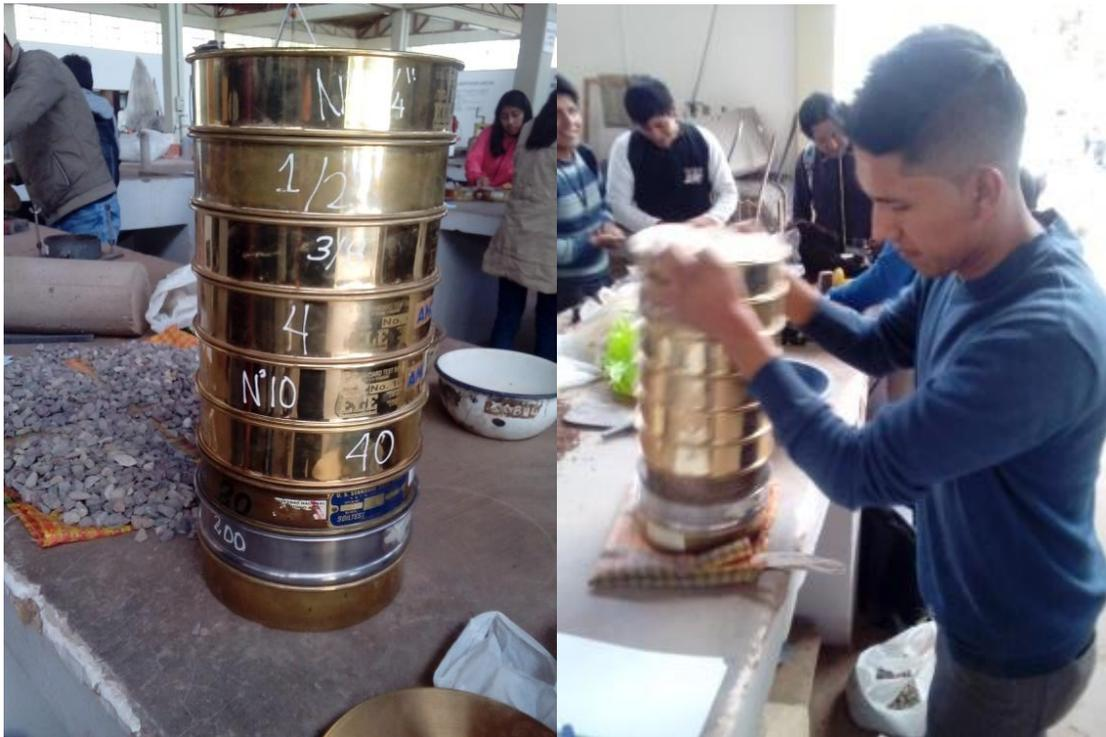
*Figura 55: Mallas para tamizado manual de agregado pétreo*
