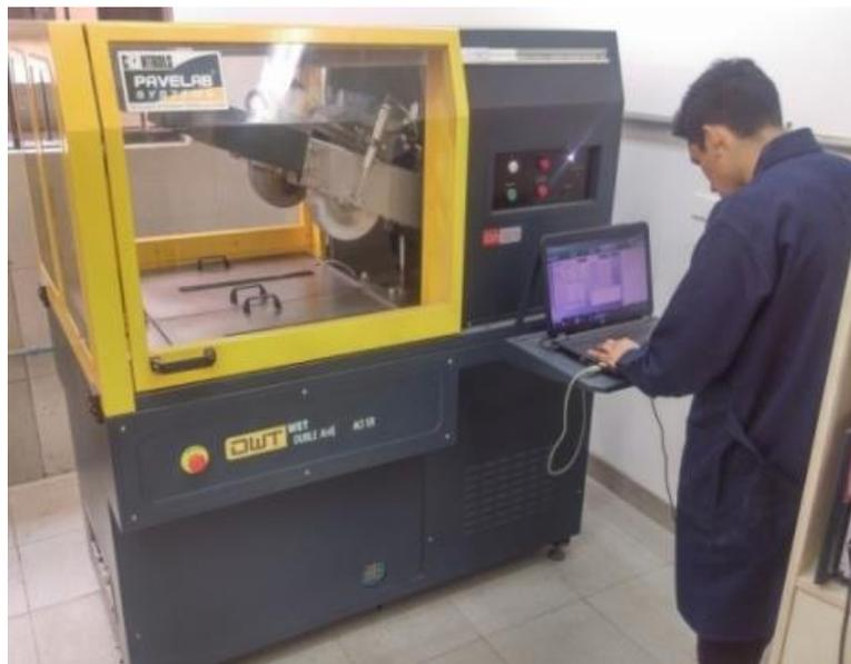
*Figura 38: Colocación de los datos antes del inicio de la prueba de ensayo de Rueda Cargada de Hamburgo*
