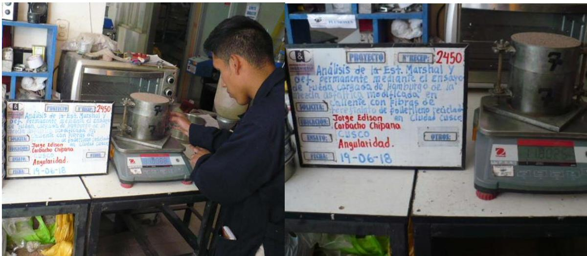
Figura 98: Enrasado del material y pesado del material en el envase de volumen conocido
