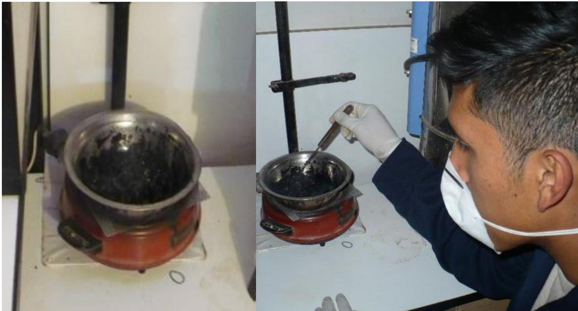
*Figura 79: Mezclado en hornilla del ligante con el agregado tamizado*
