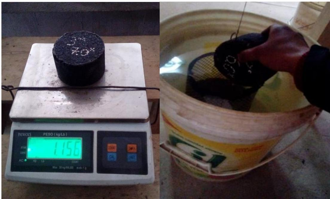
*Figura 18: Determinación del peso específico de briquetas Marshall convencional*
