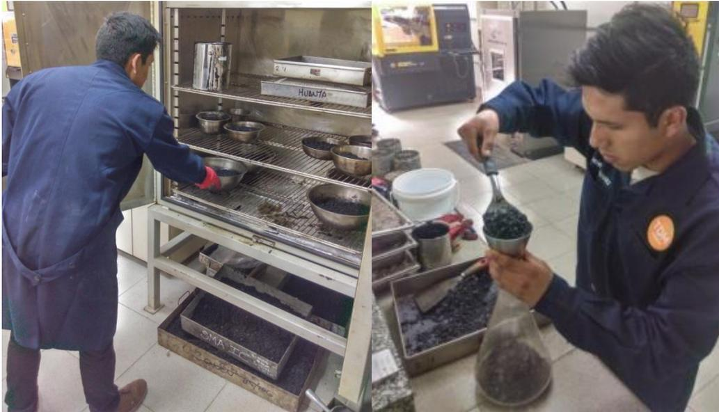
*Figura 30: Colocación del material dentro del matraz*
