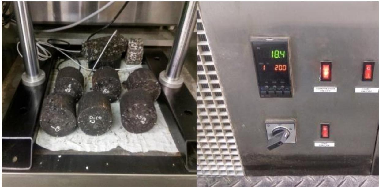
*Figura 49: Proceso de temperado de las muestras de ensayo a 20°C y 25°C*
