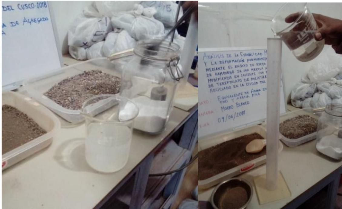
Figura 83: Vertido de la solución Stock en la probeta de ensayos
