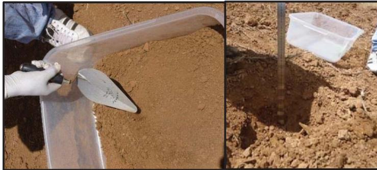
Figura 42. Muestra compuesta y quarreo para la obtención de muestra final
