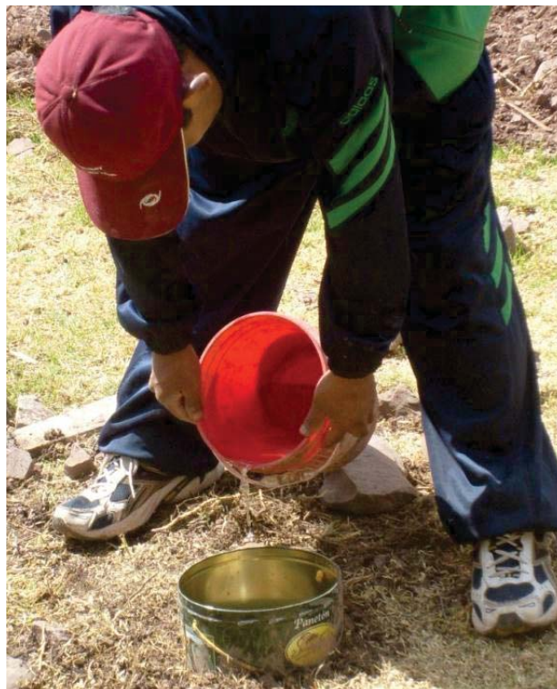
Fotos N° 11: Pruebas de infiltración en Formación San Sebastián.
