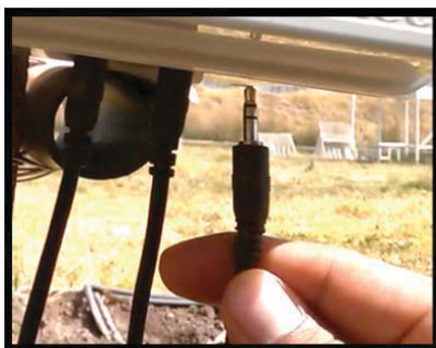
Fotografía 38: Conector de 3.5mm del sensor de humedad
