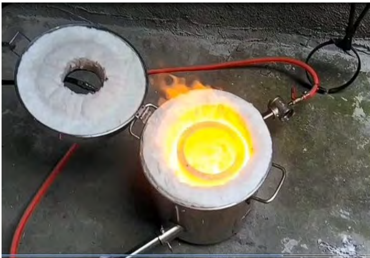
Horno de crisol cilíndrico revestido con fibra cerámica
