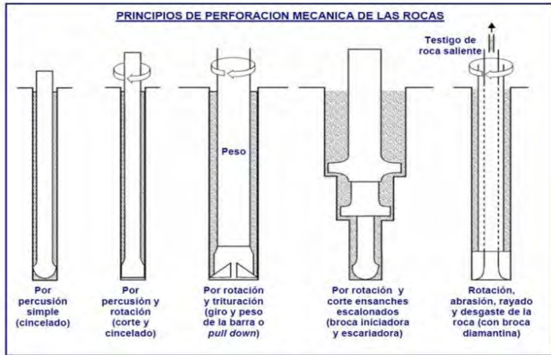
Figura 1: Principios de perforación mecánica de las rocas
