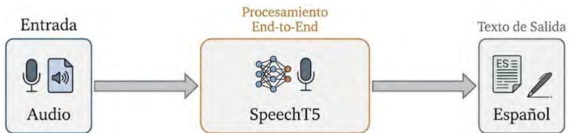
Figura 4.7: Pipeline de la arquitectura de traducción directa con el modelo SpeechT5
