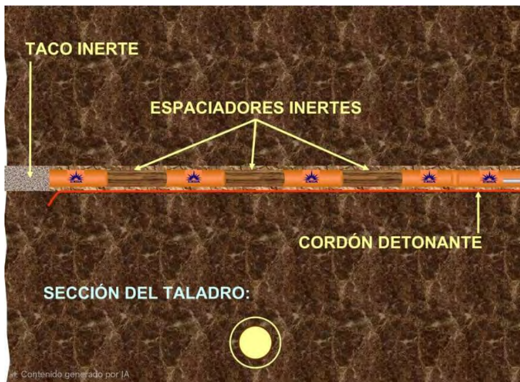
Taladros con cargas desacopladas
