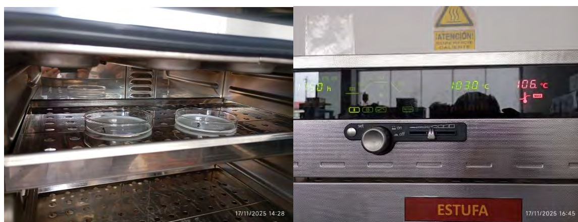
Figura 52 Secado en estufa de leche cruda
