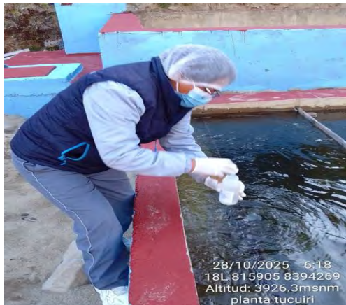
Toma de muestras de agua a ingreso de sedimentador 28/10/2025
