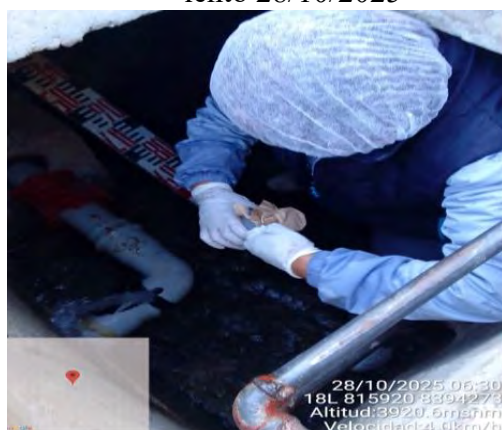
Toma de muestra de agua a salida del filtro lento 28/10/2025
