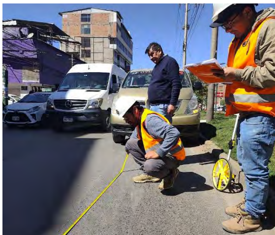
Supervisión del asesor de tesis, Dr. Ing. Adán Wilbert Solórzano M. Durante la medición de rugosidad con equipo MERLIN.
