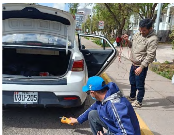
Se observa el vehículo de prueba y el equipo sensor durante las evaluaciones, realizando mediciones a diferentes distancias del escape vehicular para verificar el funcionamiento del equipo de monitoreo.
