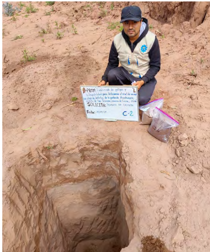
Fotografía 22. Excavación y codificación de la Calicata N° 2 en la Formación San Sebastián.
