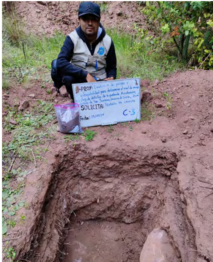
Fotografía 23. Excavación y codificación de la Calicata N° 3 en los depósitos coluviales.
