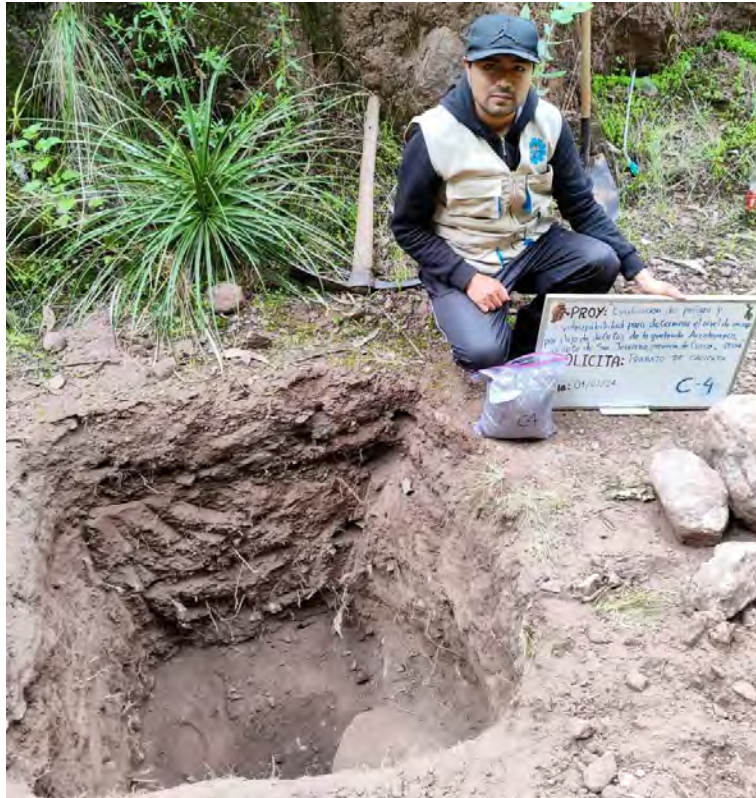
Fotografía 24. Excavación y codificación de la Calicata N° 4 en los depósitos coluviales
