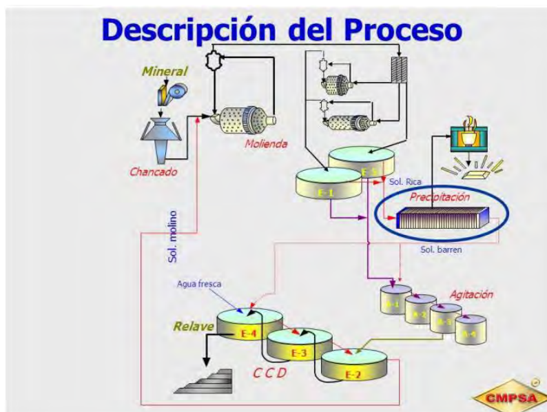
Figura 21. Proceso de planta de tratamiento CMPA
