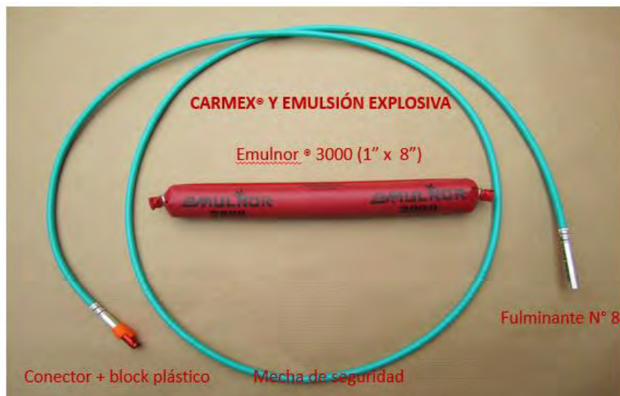
Figura 16. Materiales de voladura
