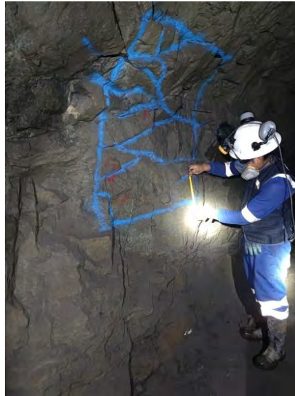
Figura 22. Mapeo geomecánico método directo por celdas de detalle.
