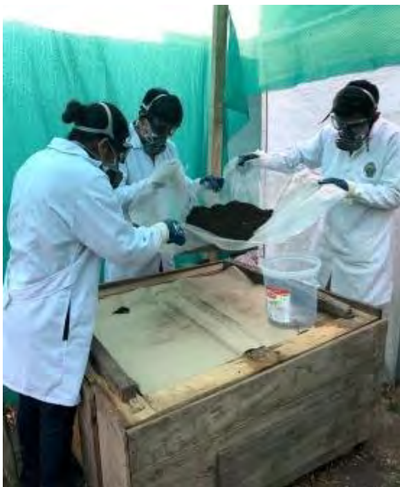
Figura 36. Mezclado de los 5 kg. de tierra negra con el Acetato de Plomo Trihidratado.
