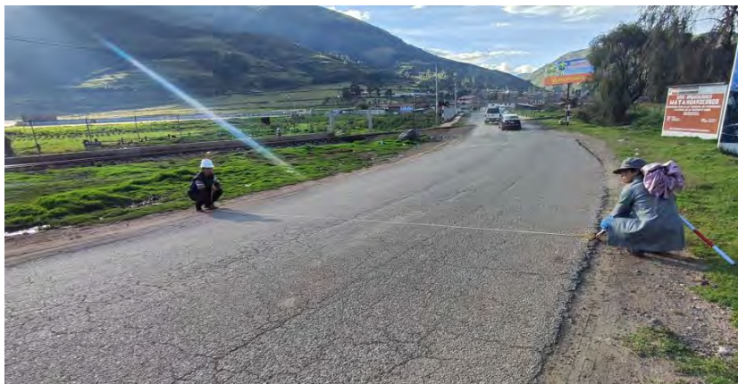
Fotografía 1 Medición del ancho de vía en la carretera CU-110
