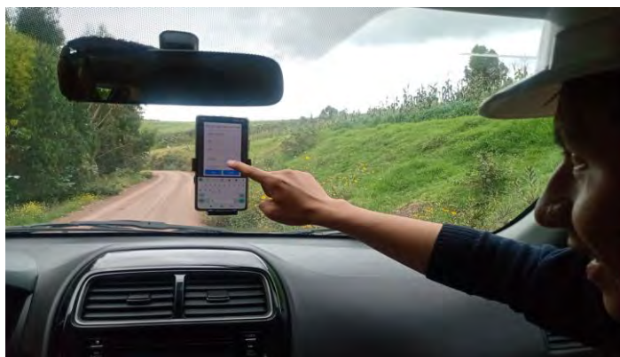
Fotografía 10 Ingreso de data para la configuración al aplicativo RoadLab Pro
