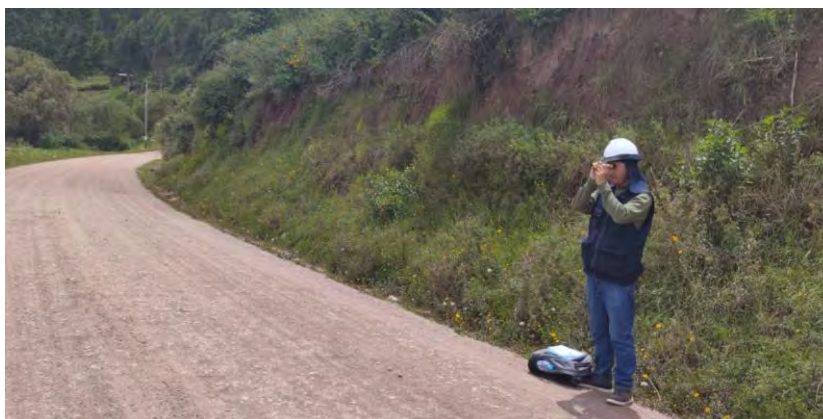
Fotografía 4 Medición del peralte en curvas usando el eclímetro, vía CU-902.
