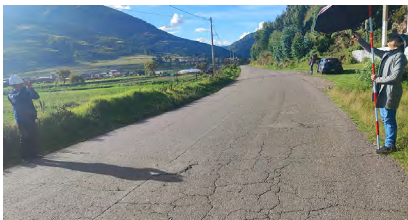
Fotografía 5 Medición del peralte en curvas usando el eclímetro, vía CU-110.
