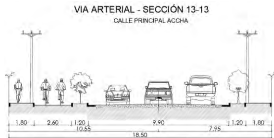
Imagen N.º 113: Propuesta de vía arterial sección 13
