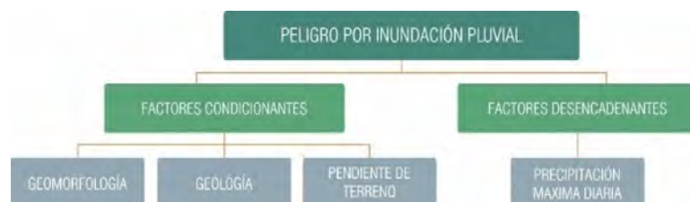
Gráfico N.º 010: Variables de evaluación de peligro por inundación pluvial
