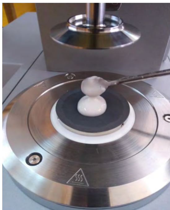
CARGA DEL GEL DE SUSENSIONES DE ALMIDÓN AL PLATO INFERIOR DEL REOMETRO
