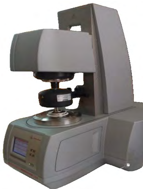
EQUIPO REOMETRO MODULAR COMPACTO ANTON PAAR
